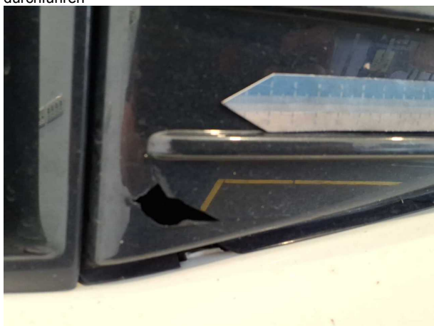
Beschädigung #3: Stossfänger vorn: Lufteinlassgitter - gebrochen / gerissen - erneuern
