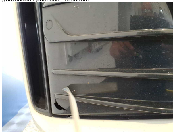
Beschädigung #3: Stossfänger vorn: Lufteinlassgitter - gebrochen / gerissen - erneuern
