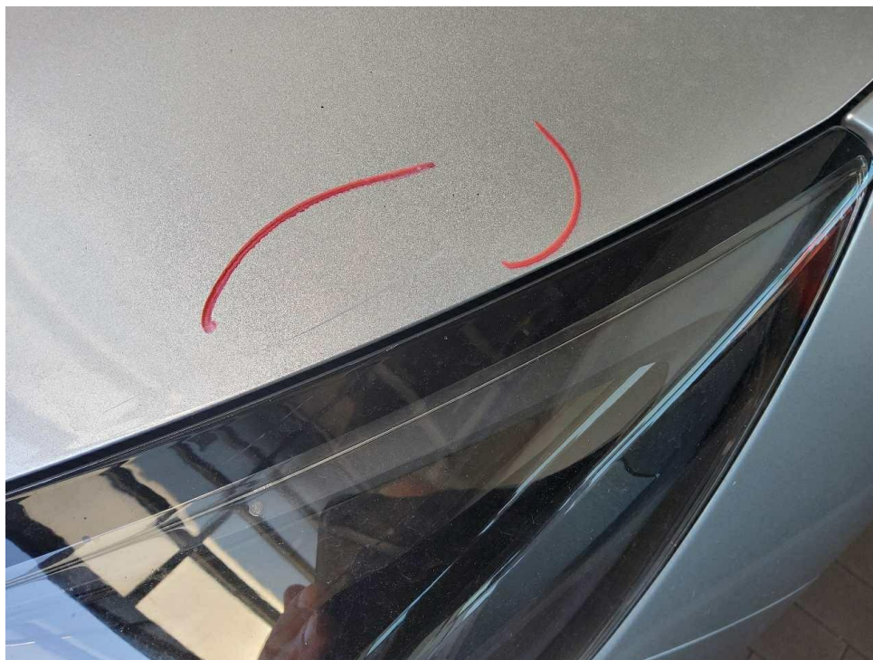
Bild 25 : Motorhaube Lackierung, zerkratzt, lackieren mit Lackaufbau
