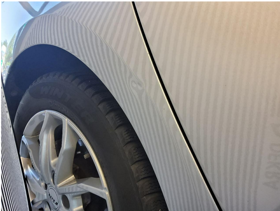
Bild 22 : Seitenteil hinten rechts Kniestück, eingedellt, smart repair
