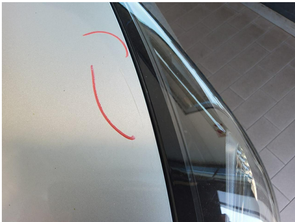
Bild 26 : Motorhaube Lackierung, zerkratzt, lackieren mit Lackaufbau
