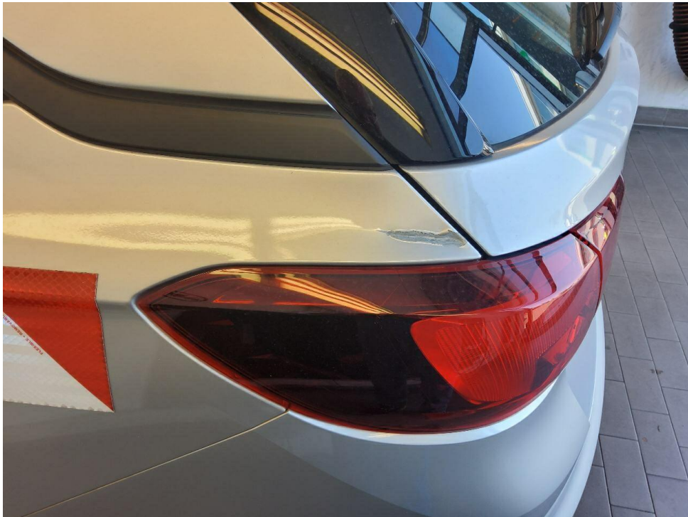
Bild 21 : Seitenteil hinten links beschädigt, eingedrückt,
