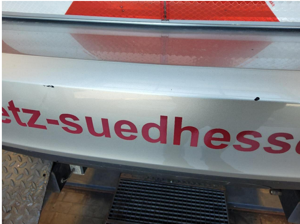
Bild 23 : Stoßfänger hinten Lackierung, zerkratzt, Gebrauchsspur
