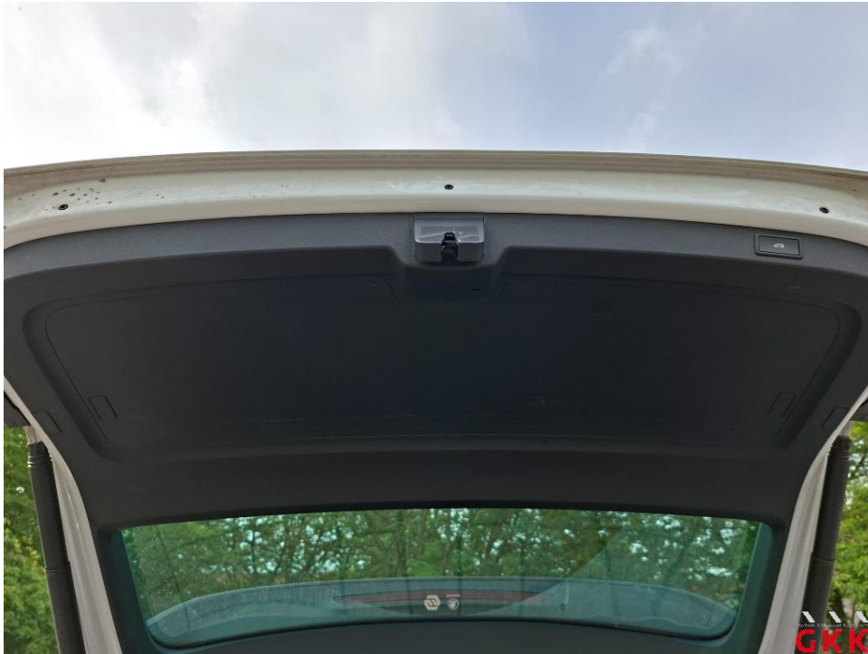
Bild 15. Heckklappe, Innenverkleidung, beschädigt, ersetzen
