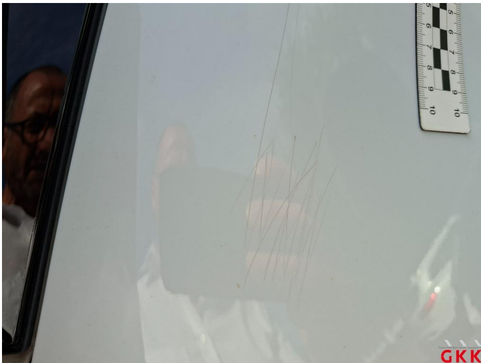
Bild 24. Seitenwand rechts, verkratzt, lackieren
