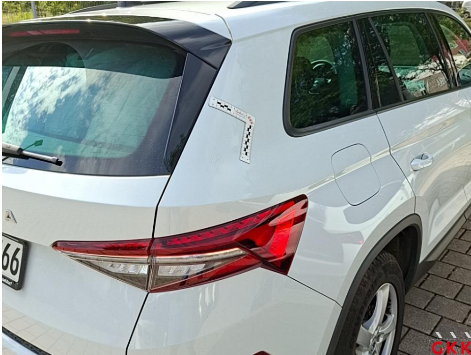
Bild 23. Seitenwand rechts, verkratzt, lackieren
