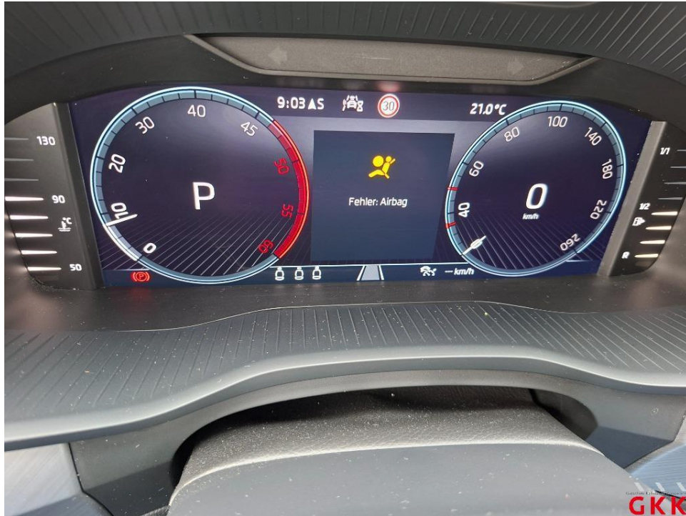
Bild 13. Airbagsystem, Fehlerspeicher, aktiv, auslesen / prüfen
