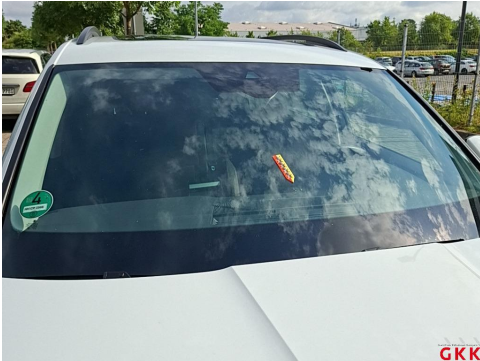
Bild 21. Frontscheibe, mit Regensensor und Frontkamera, Reparaturmangel, ersetzen
