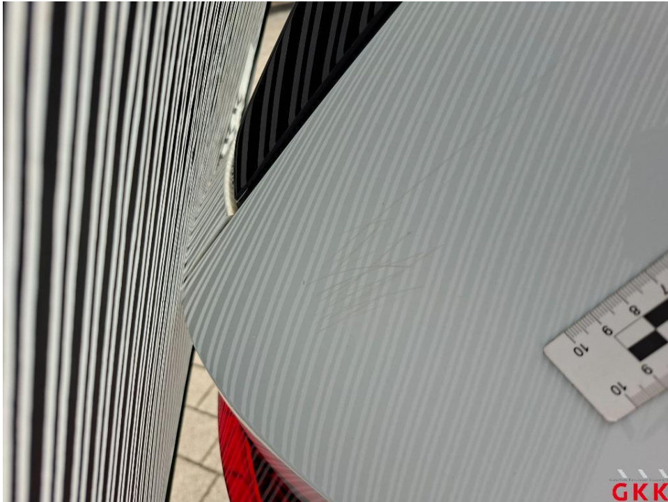
Bild 25. Seitenwand rechts, verkratzt, lackieren
