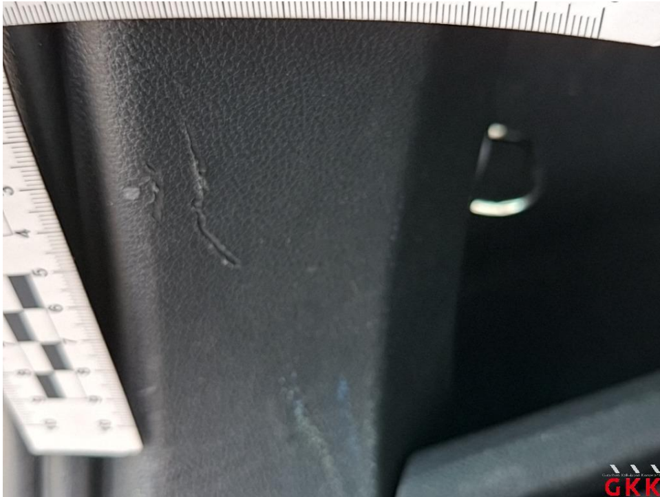
Bild 19. Seitenwand links, Innenverkleidung, beschädigt, Smartrepair
