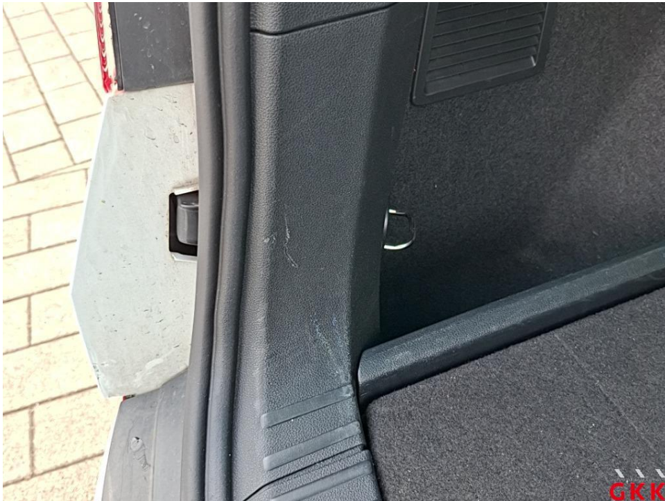
Bild 18. Seitenwand links, Innenverkleidung, beschädigt, Smartrepair
