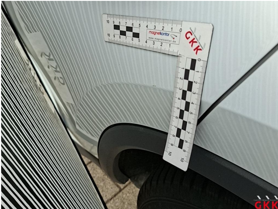
Bild 28. Tür hinten links, verkratzt, lackieren
