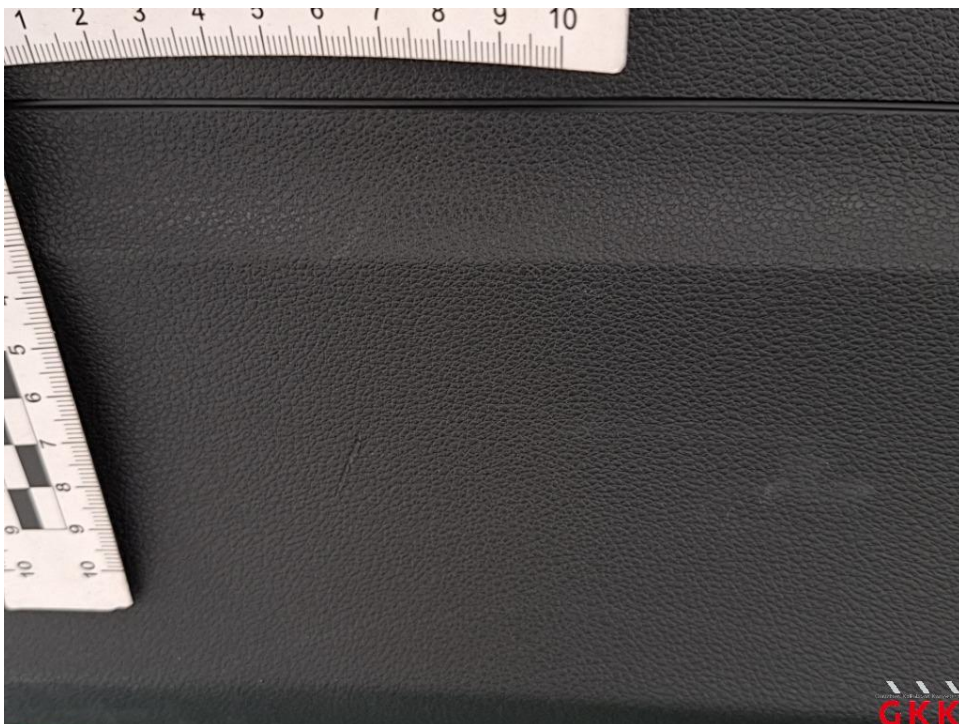
Bild 16. Heckklappe, Innenverkleidung, beschädigt, ersetzen
