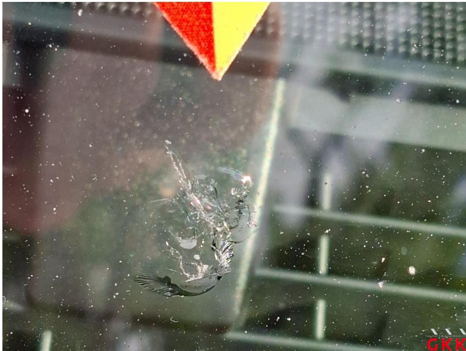
Bild 22. Frontscheibe, mit Regensensor und Frontkamera, Reparaturmangel, ersetzen
