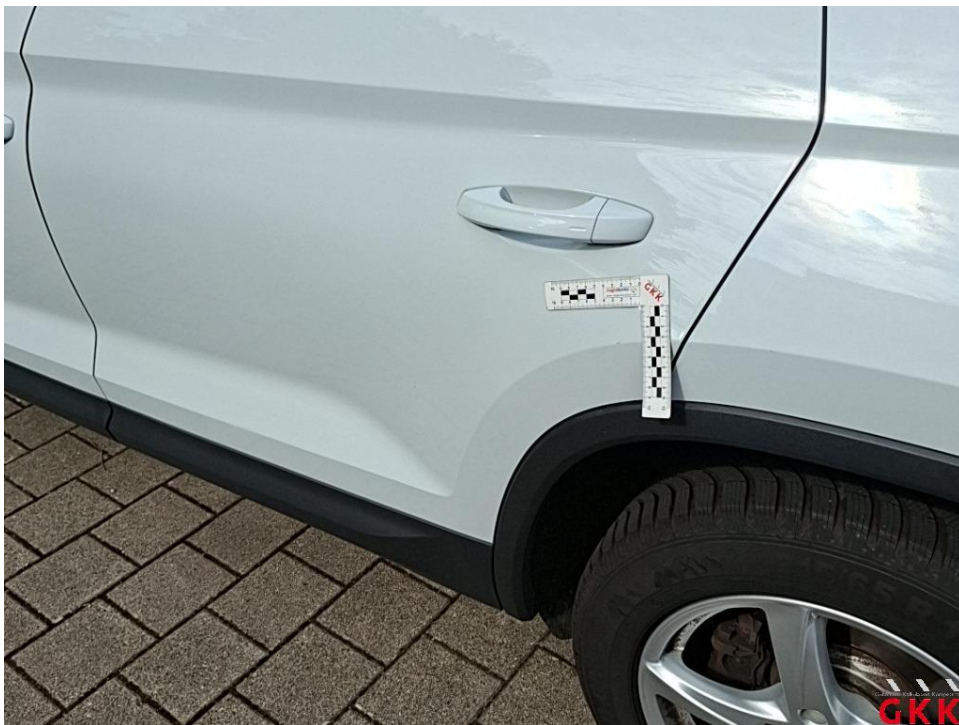
Bild 26. Tür hinten links, verkratzt, lackieren
