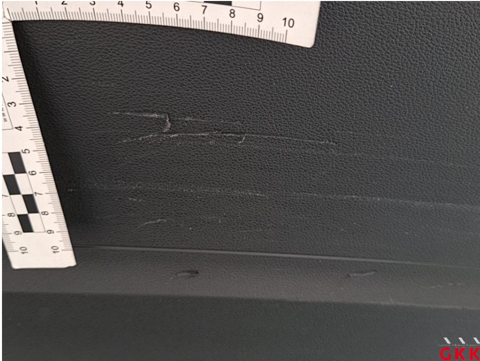
Bild 17. Heckklappe, Innenverkleidung, beschädigt, ersetzen
