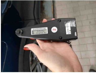
Lackstärke Seitenwand hinten rechts
