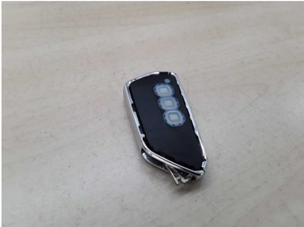
Damage #3: Equipment: Vehicle key (Abdeckung fehlt) - Replace
