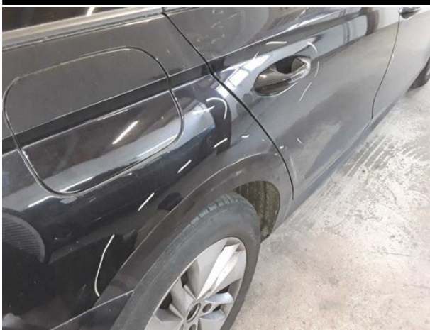
Beschädigung #20: Seitenwand rechts: Seitenwand - Delle / Lackschaden - erneuern
