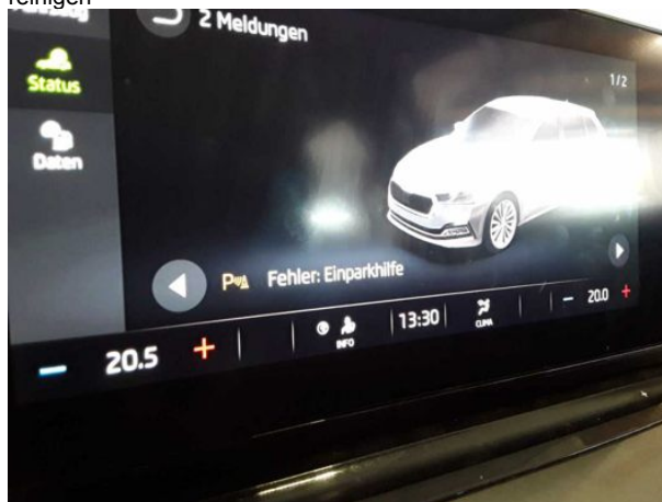
Beschädigung #7: Instrumententafel: Kontrollleuchte (Einparkhilfe fehlerhaft) - Befund festlegen - Diagnose
