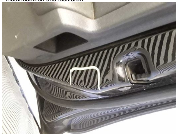
Beschädigung #19: Tür vorn rechts: Tür - verkratzt / verschü... - instandsetzen und lackieren
