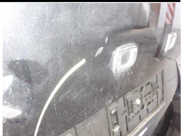
Beschädigung #17: Heckklappe/-tür: Heckklappe - verkratzt / verschürft - instandsetzen und lackieren
