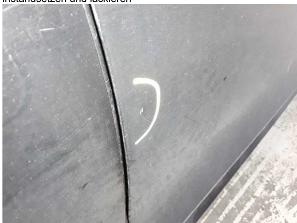
Beschädigung #19: Tür vorn rechts: Tür - verkratzt / verschü... - instandsetzen und lackieren
