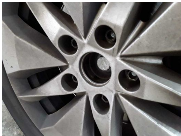
Beschädigung #5: Rad/Reifen: Raddeckel (4x fehlen) - erneuern
