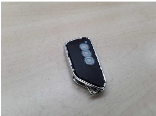
Beschädigung #3: Ausrüstung: Fahrzeugschlüssel (Abdeckung fehlt) - erneuern
