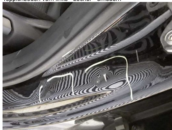
Beschädigung #9: Schweller links: Einstieg - Delle / Lackschaden - instandsetzen und lackieren
