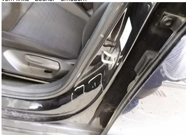
Beschädigung #9: Schweller links: Einstieg - Delle / Lackschade... instandsetzen und lackieren
