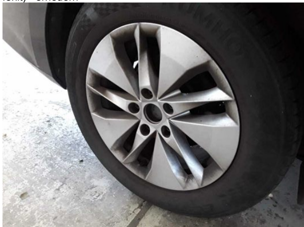
Beschädigung #5: Rad/Reifen: Raddeckel (4x fehlen) - erneuern
