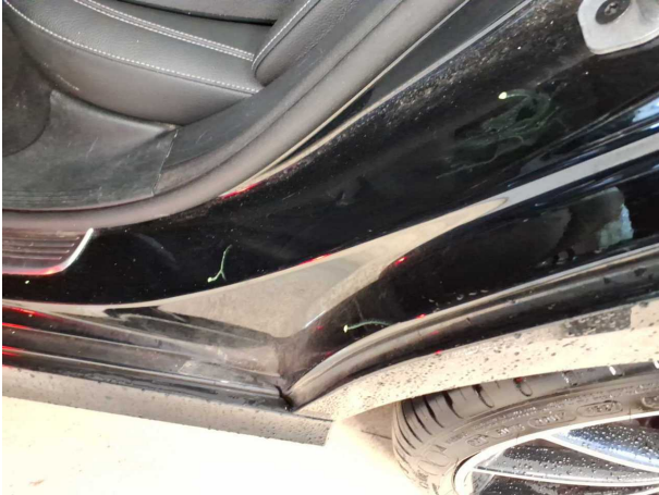
Beschädigung #1: Seitenwand links: Einstieg - verkratzt / verschürft - auslegen / polieren
