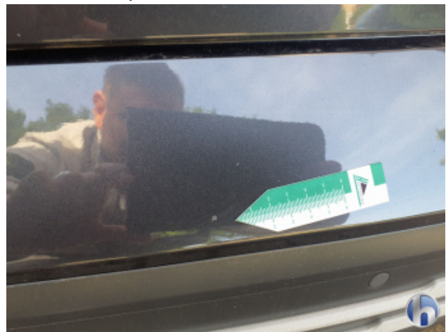
2. Stoßfänger Hinten Lackabplatzer - Smart Repair
