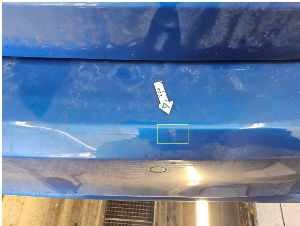
Bild 16 : Stoßfänger hinten, zerkratzt
