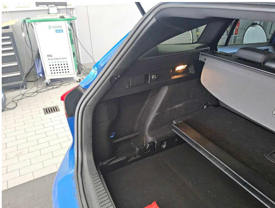
Bild 19 : Kofferraum Seitenverkleidung links, zerkratzt
