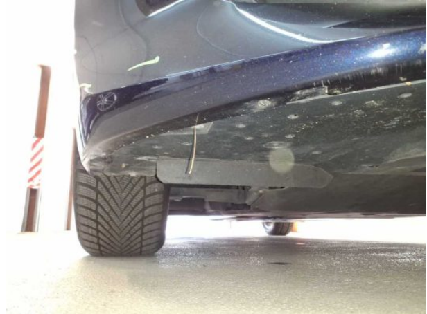
Beschädigung #13: Stossfänger vorn: Stossfänger vorn - verkratzt / verschürft - Smart Repair
