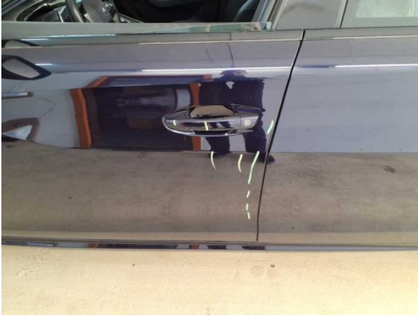
Beschädigung #4: Tür vorn links: Tür - Kratzer - auslegen / polieren
