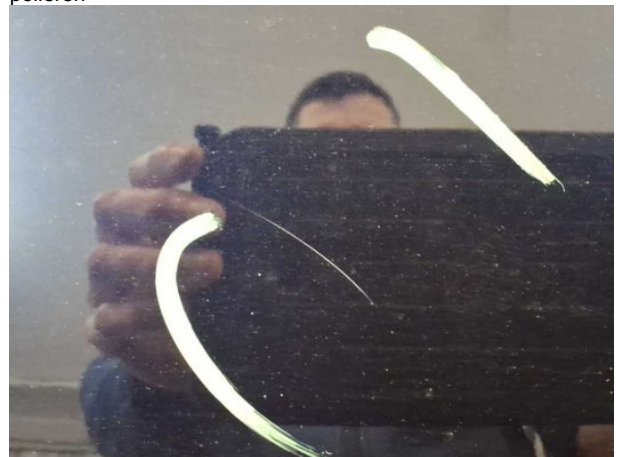
Beschädigung #5: Motorhaube: Motorhaube - Kratzer - auslegen / polieren
