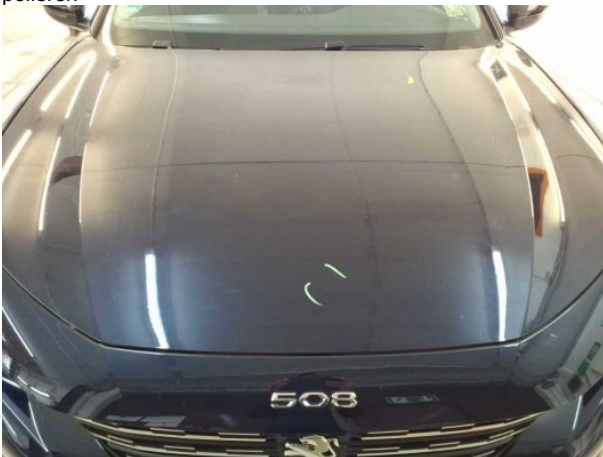
Beschädigung #5: Motorhaube: Motorhaube - Kratzer - auslegen / polieren
