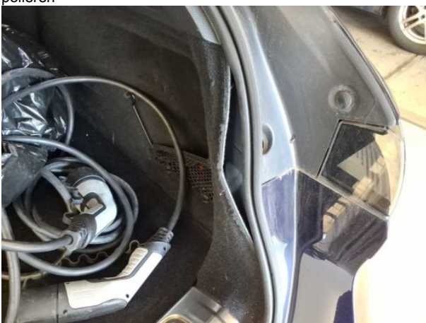
Beschädigung #7: Seitenwand rechts: Innenverkleidung - Fehlstellung - de-/montieren
