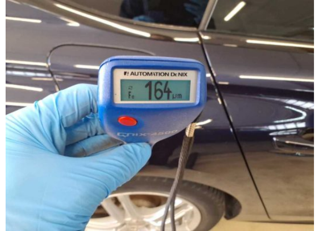
Nachlackierung 1: Kotflügel rechts, Seitenwand rechts, Tür hinten rechts
