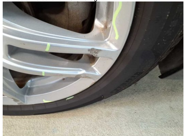
Beschädigung #2: Rad/Reifen: Leichtmetallfelge vorn rechts - verkratzt / verschürft - kein Abzug
