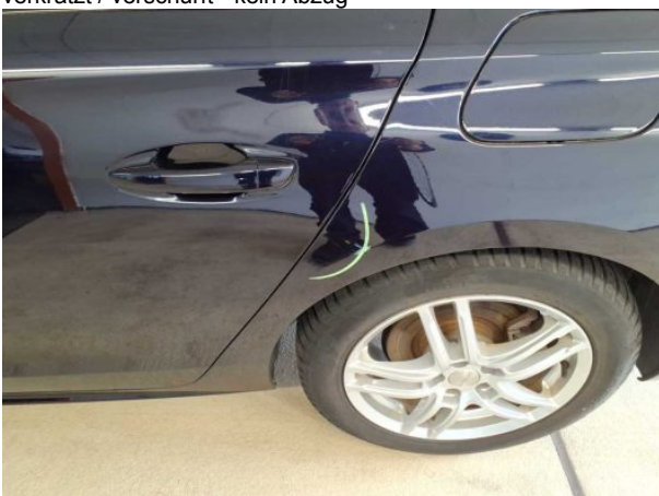
Beschädigung #3: Seitenwand links: Seitenwand - Kratzer - auslegen / polieren
