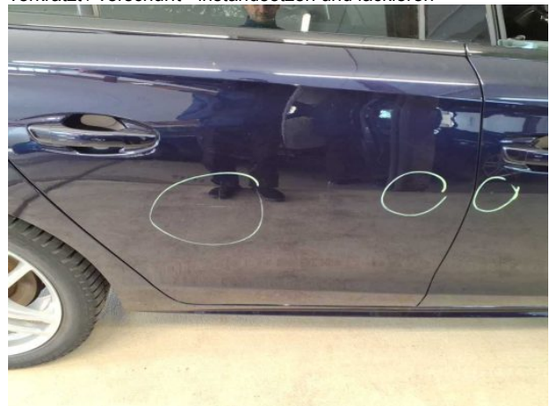
Beschädigung #15: Tür hinten rechts: Tür - verkratzt / verschürft - instandsetzen und lackieren
