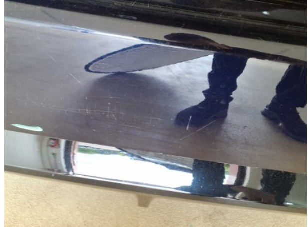
Beschädigung #14: Stossfänger hinten: Stossfänger hinten - verkratzt / verschürft - instandsetzen und lackieren
