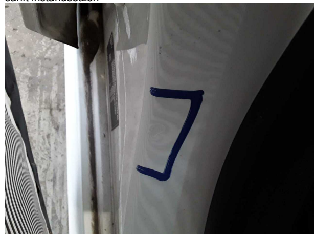
Beschädigung #5: Schweller rechts: Einstieg - Delle(n) - sanft instandsetzen
