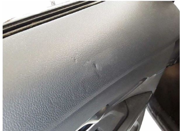
Beschädigung #7: Verkleidungen/Abdeckungen: Türverkleidung hinten links - beschädigt - erneuern
