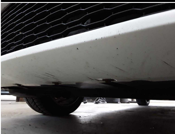
Beschädigung #8: Stossfänger vorn: Stossfänger vorn - verkratzt / verschürft - instandsetzen und lackieren
