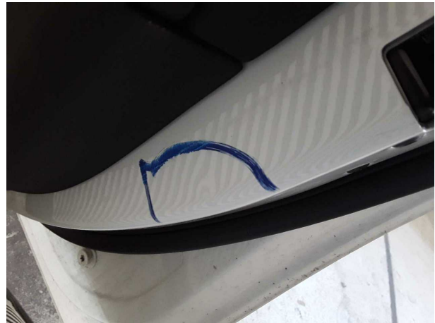
Beschädigung #6: Tür vorn rechts: Tür - Delle(n) - sanft instandsetzen
