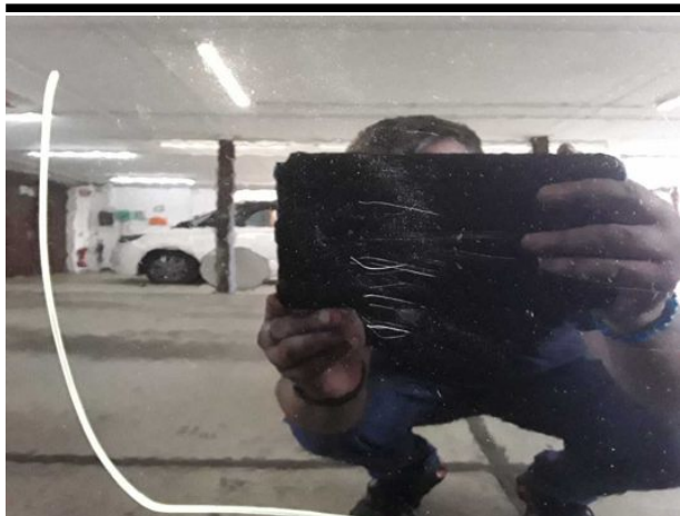
Beschädigung #20: Tür hinten links: Tür - verkratzt / verschürft - lackieren
