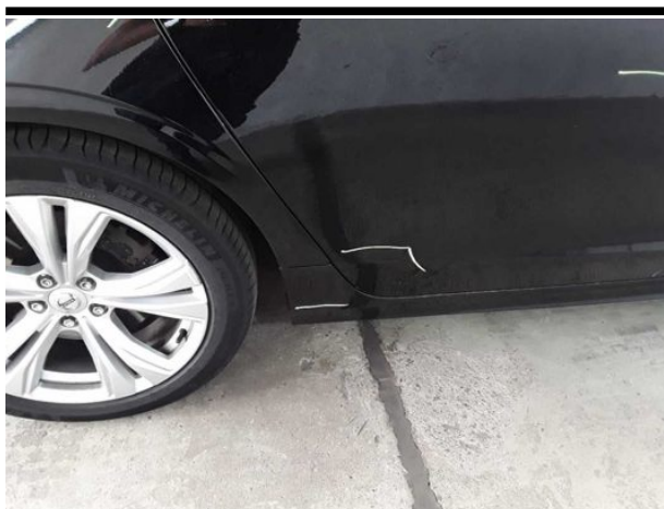
Beschädigung #14: Schweller rechts: Verkleidung - verkratzt / verschürft - lackieren
