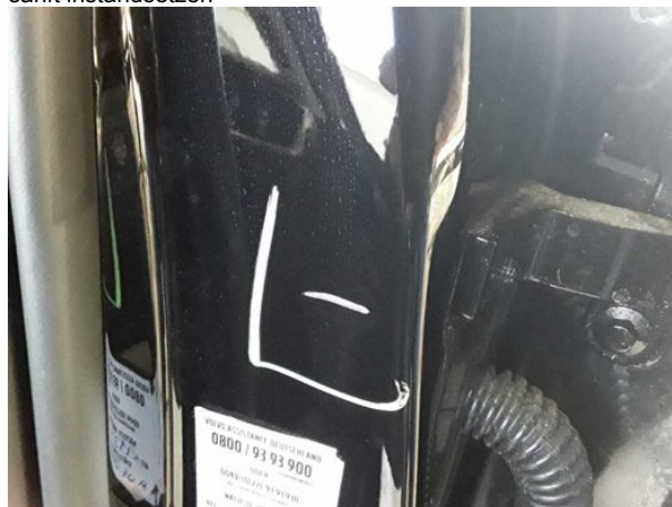
Beschädigung #3: Schweller links: Einstieg - verkratzt / verschürft - Smart Repair
