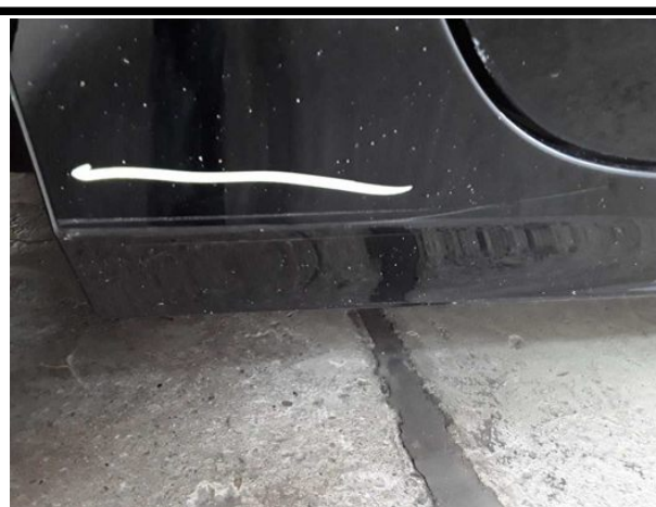
Beschädigung #14: Schweller rechts: Verkleidung - verkratzt / verschürft - lackieren
