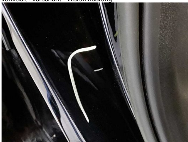
Beschädigung #8: Schweller rechts: Einstieg - verkratzt / verschürft - Smart Repair
