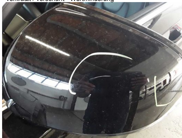
Beschädigung #10: Außenspiegel links: Abdeckkappe - verkratzt / verschürft - Smart Repair
