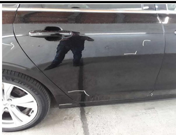
Beschädigung #21: Tür hinten rechts: Tür - verkratzt / verschürft - lackieren
