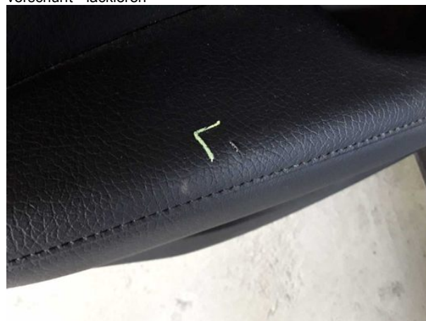
Beschädigung #15: Verkleidungen/Abdeckungen: Türverkleidung hinten links - gebrochen / gerissen - erneuern
