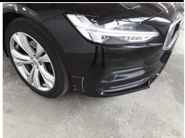
Beschädigung #13: Stossfänger vorn: Spoiler - verkratzt / verschürft - erneuern
