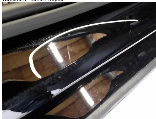
Beschädigung #8: Schweller rechts: Einstieg - verkratzt / verschürft - Smart Repair
