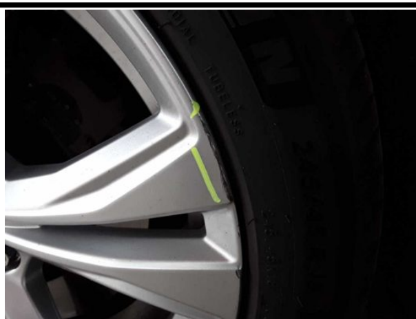
Beschädigung #9: Rad/Reifen: Leichtmetallfelge hinten rechts - verkratzt / verschürft - Wertminderung
