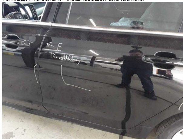
Beschädigung #20: Tür hinten links: Tür - verkratzt / verschürft - instandsetzen und lackieren
