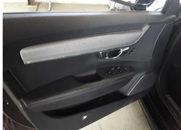
Beschädigung #17: Verkleidungen/Abdeckungen: Türverkleidung vorn links - verkratzt / verschürft - erneuern
