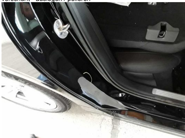
Beschädigung #2: Seitenwand rechts: Einstieg - Delle(n) - sanft instandsetzen
