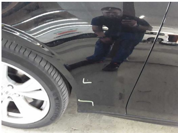
Beschädigung #1: Kotflügel links: Kotflügel links - verkratzt / verschürft - auslegen / polieren
