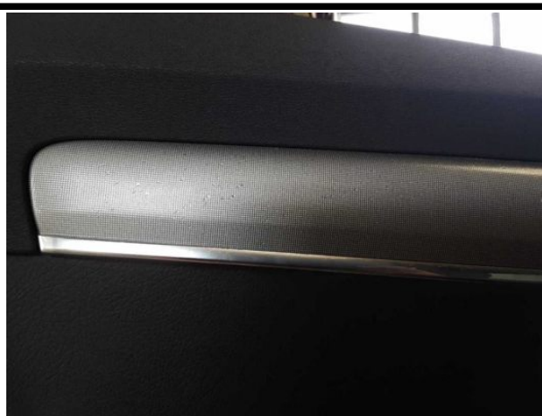
Beschädigung #17: Verkleidungen/Abdeckungen: Türverkleidung vorn links - verkratzt / verschürft - erneuern
