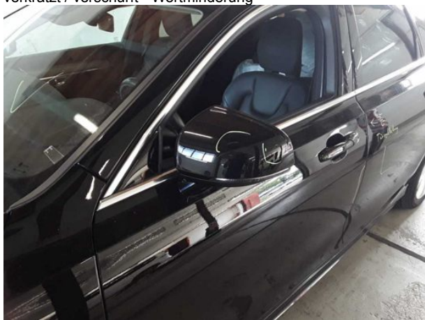
Beschädigung #10: Außenspiegel links: Abdeckkappe - verkratzt / verschürft - Smart Repair
