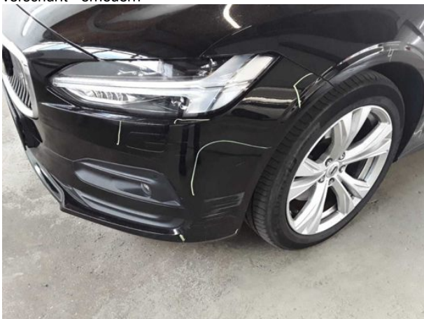
Beschädigung #13: Stossfänger vorn: Spoiler - verkratzt / verschürft - erneuern
