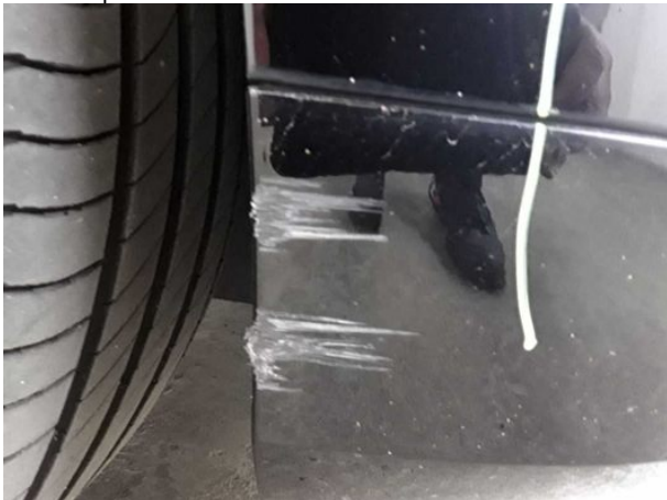
Beschädigung #13: Stossfänger vorn: Spoiler - verkratzt / verschürft - erneuern
