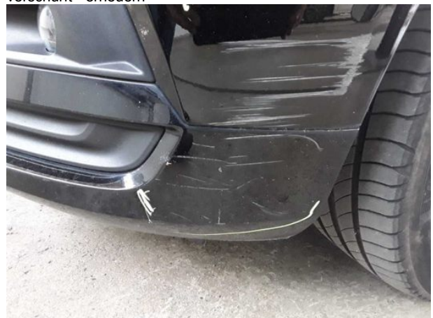
Beschädigung #13: Stossfänger vorn: Spoiler - verkratzt / verschürft - erneuern
