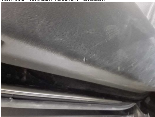
Beschädigung #17: Verkleidungen/Abdeckungen: Türverkleidung vorn links - verkratzt / verschürft - erneuern
