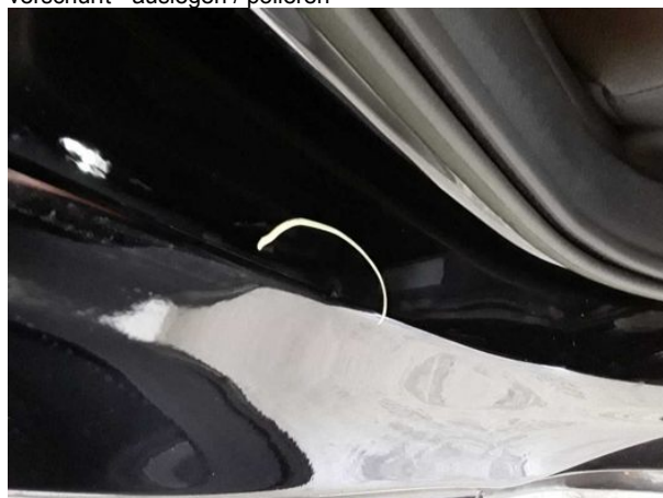
Beschädigung #2: Seitenwand rechts: Einstieg - Delle(n) - sanft instandsetzen
