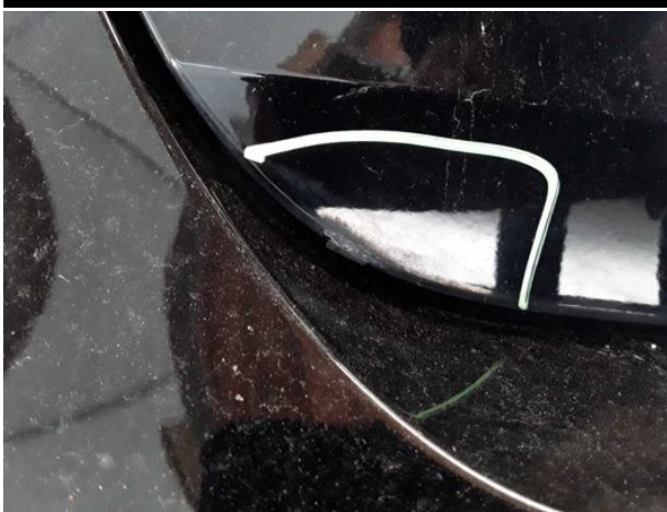
Beschädigung #22: Heckklappe/-tür: Heckklappe - verkratzt / verschürft - instandsetzen und lackieren
