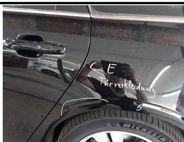
Beschädigung #4: Seitenwand links: Seitenwand - verkratzt / verschürft - Smart Repair
