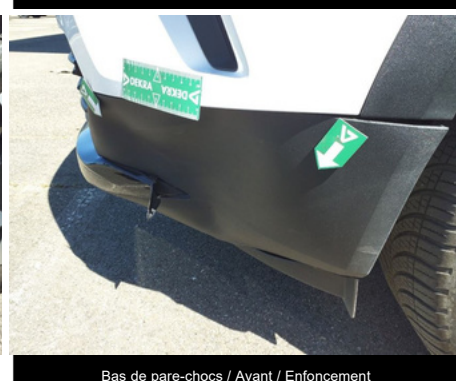
Bas de pare-chocs / Avant / Enfoncement
