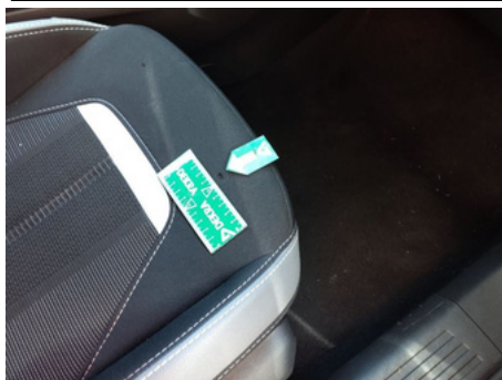
Couverture d'assise de siège / Avant Droit / Brûlé
