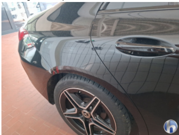
4. Seitenwand - Hinten - Rechts 1 Delle - Sanft Instandsetzen
