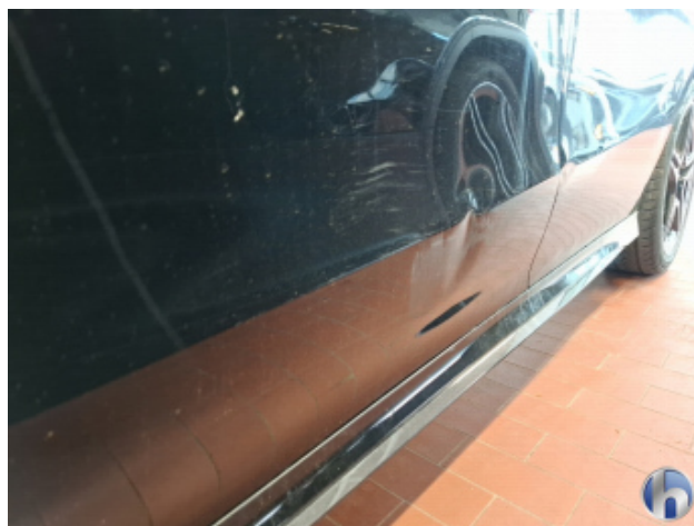
6. Beschädigung Linke TÜR V+H Beschädigt - Siehe Kalkulation
