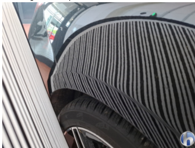
4. Seitenwand - Hinten - Rechts 1 Delle - Sanft Instandsetzen
