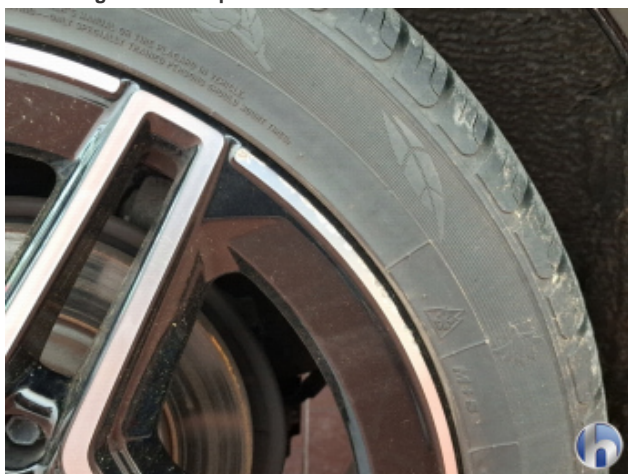
3. Felge Hinten - Rechts Beschädigt - Smart Repair
