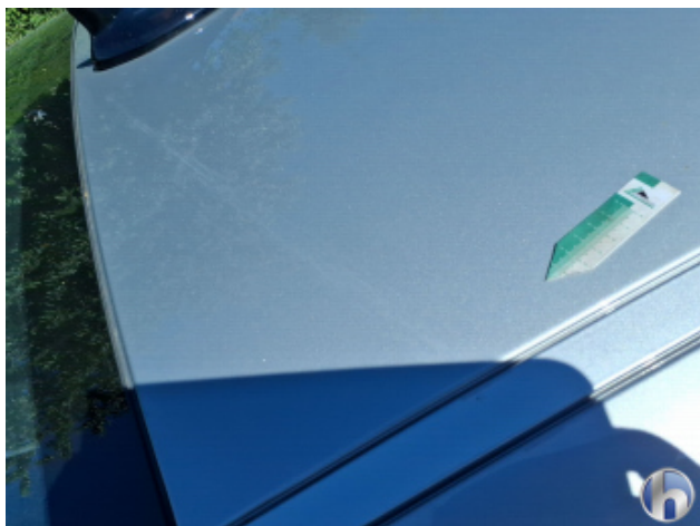
7. Dach Kratzer - Lackieren
