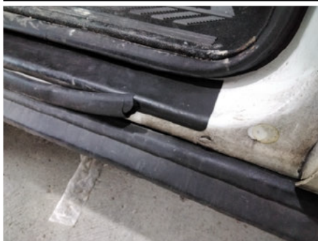
Dichtung Türeinstieg / Vorne Links / Gebrochen
