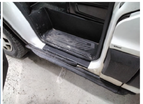
Dichtung Türeinstieg / Vorne Links / Gebrochen
