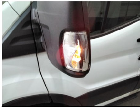
Blinker / Vorne Links / Gebrochen
