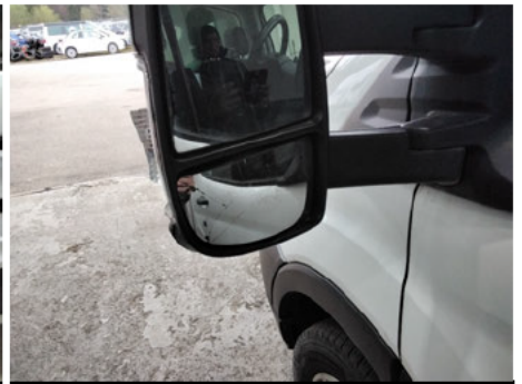
Außenspiegelglas / Links / Gebrochen
