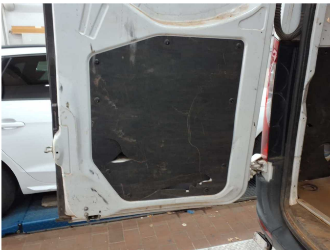
Damage 1: Boot lid / rear door: Rear door - left side (Verkleidung) - Broken / torn - Replace
