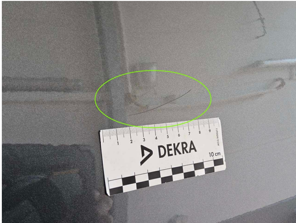
Bild 15 : Tür hinten rechts Lackierung, zerkratzt, lackieren
