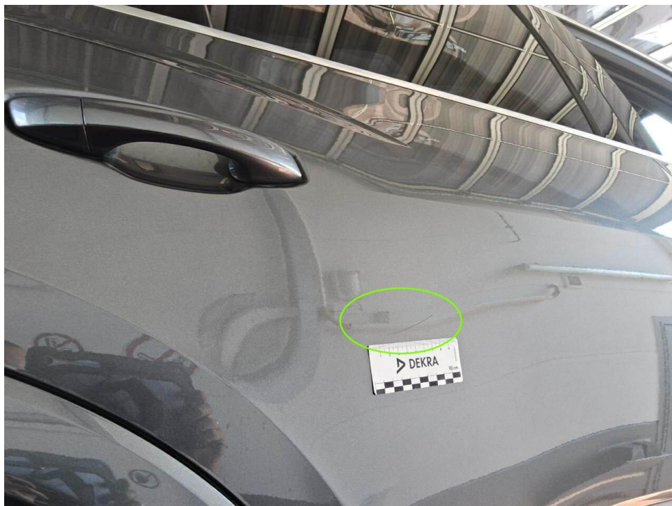
Bild 14 : Tür hinten rechts Lackierung, zerkratzt, lackieren
