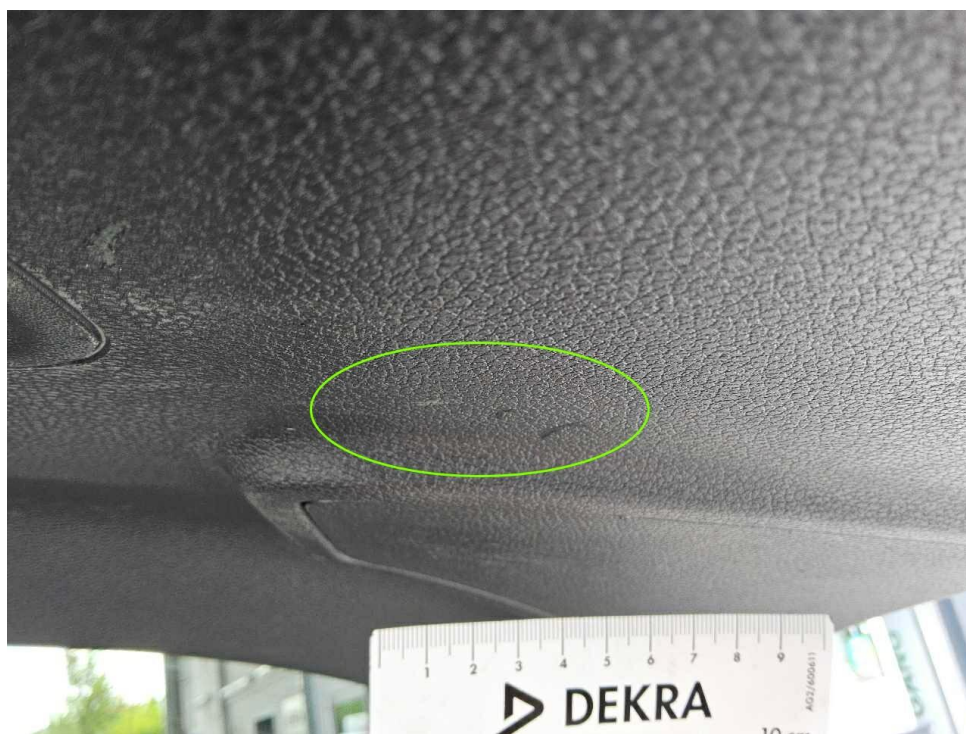
Bild 20 : Heckklappe, Verkleidung unterhalb verschrammt
