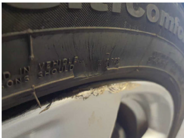
Beschädigung #2: Rad/Reifen: Reifen vorn rechts - beschädigt - erneuern
