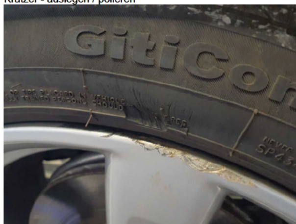
Beschädigung #2: Rad/Reifen: Reifen vorn rechts - beschädigt - erneuern
