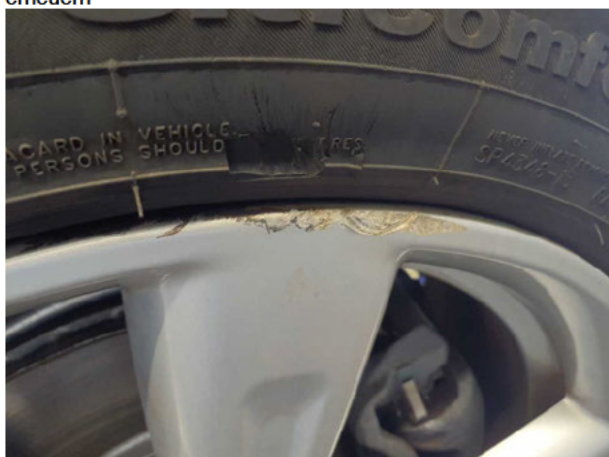
Beschädigung #3: Rad/Reifen: Leichtmetallfelge vorn rechts - verkratzt / verschürft - erneuern
