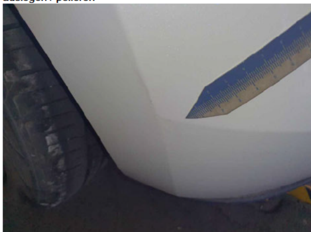
Beschädigung #1: Stossfänger hinten: Stossfänger hinten - Kratzer - auslegen / polieren
