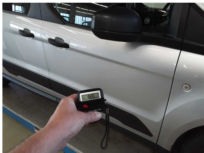
Door - front right side: 165 µm
