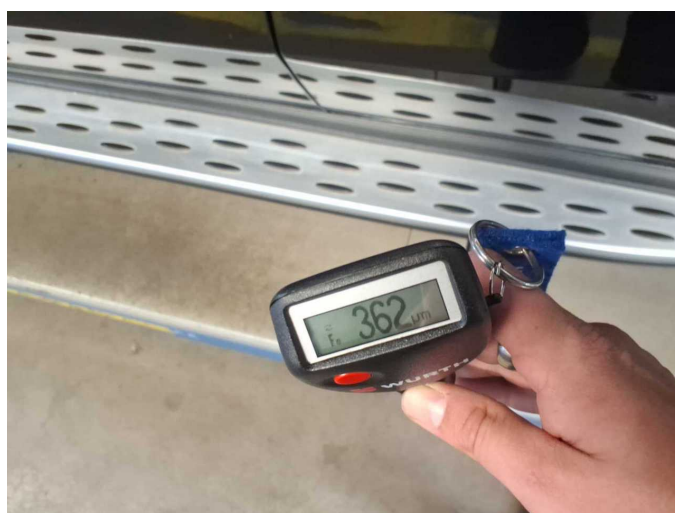
Door - rear left side: 362 µm
