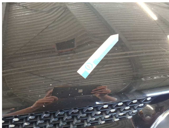
Damage 8: Bonnet: Bonnet (Sandstrahleffekt) - Stone chips - Paint
