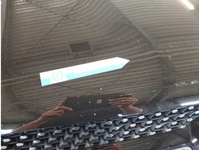
Damage 8: Bonnet: Bonnet (Sandstrahleffekt) - Stone chips - Paint
