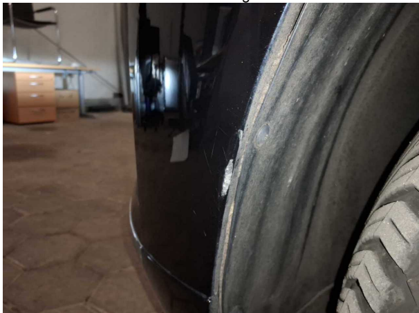
Beschädigung #2: Stossfänger vorn: Stossfänger vorn - verkratzt / verschürft - erneuern
