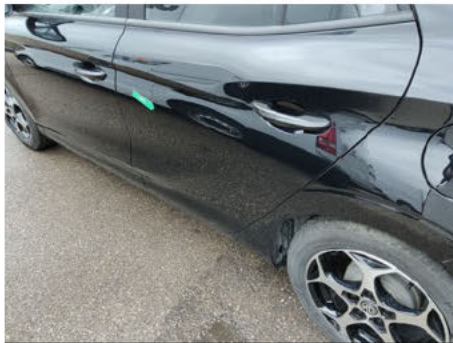
Tür / Hinten Links / Delle
