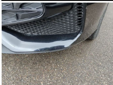
Stoßfänger / Vorne / Delle
