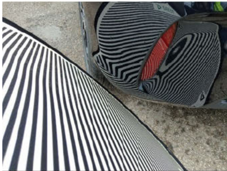
Stoßfänger / Hinten / Delle
