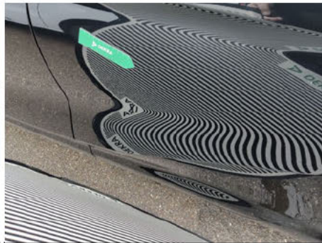
Tür / Hinten Links / Delle
