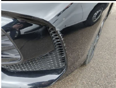
Stoßfänger / Vorne / Delle
