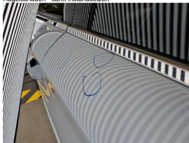
Beschädigung #2: Tür hinten links: Tür - Hagelschaden - sanft instandsetzen
