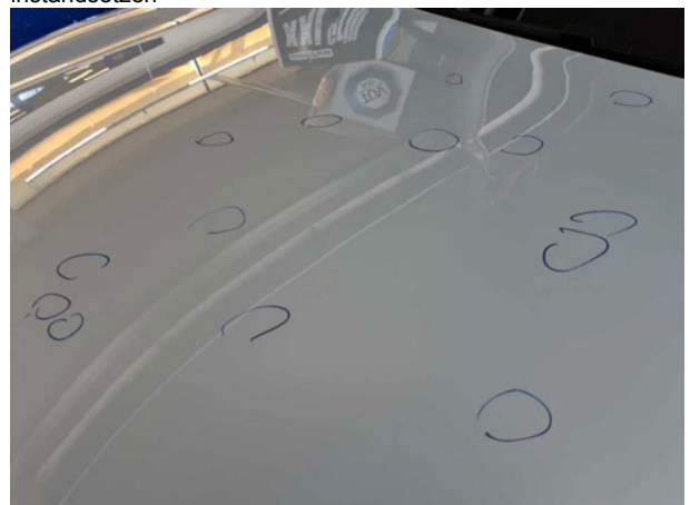
Beschädigung #5: Motorhaube: Motorhaube - Hagelschaden - sanft instandsetzen
