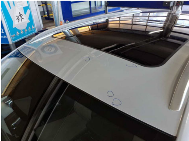
Beschädigung #4: Fahrzeugdach: Dach - Hagelschaden - sanft instandsetzen
