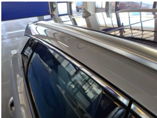
Beschädigung #1: Fahrzeugdach: Dachholm rechts - Hagelschaden - sanft instandsetzen
