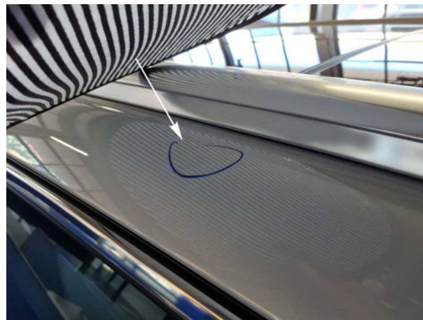
Beschädigung #1: Fahrzeugdach: Dachholm rechts - Hagelschaden - sanft instandsetzen
