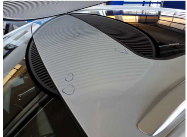
Beschädigung #4: Fahrzeugdach: Dach - Hagelschaden - sanft instandsetzen
