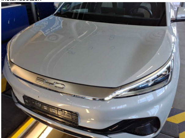
Beschädigung #5: Motorhaube: Motorhaube - Hagelschaden - sanft instandsetzen
