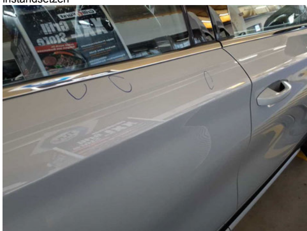
Beschädigung #3: Tür hinten rechts: Tür - Hagelschaden - sanft instandsetzen
