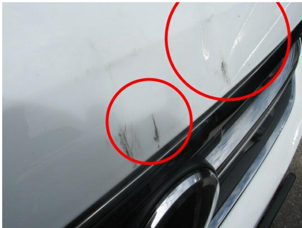
Bild 13 : Stoßfänger vorne deformiert, Motorhaube deformiert
