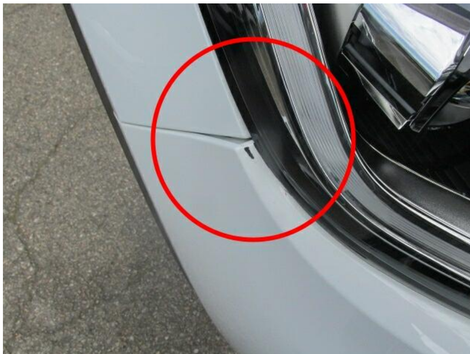
Bild 15 : Stoßfänger vorne deformiert, Motorhaube deformiert
