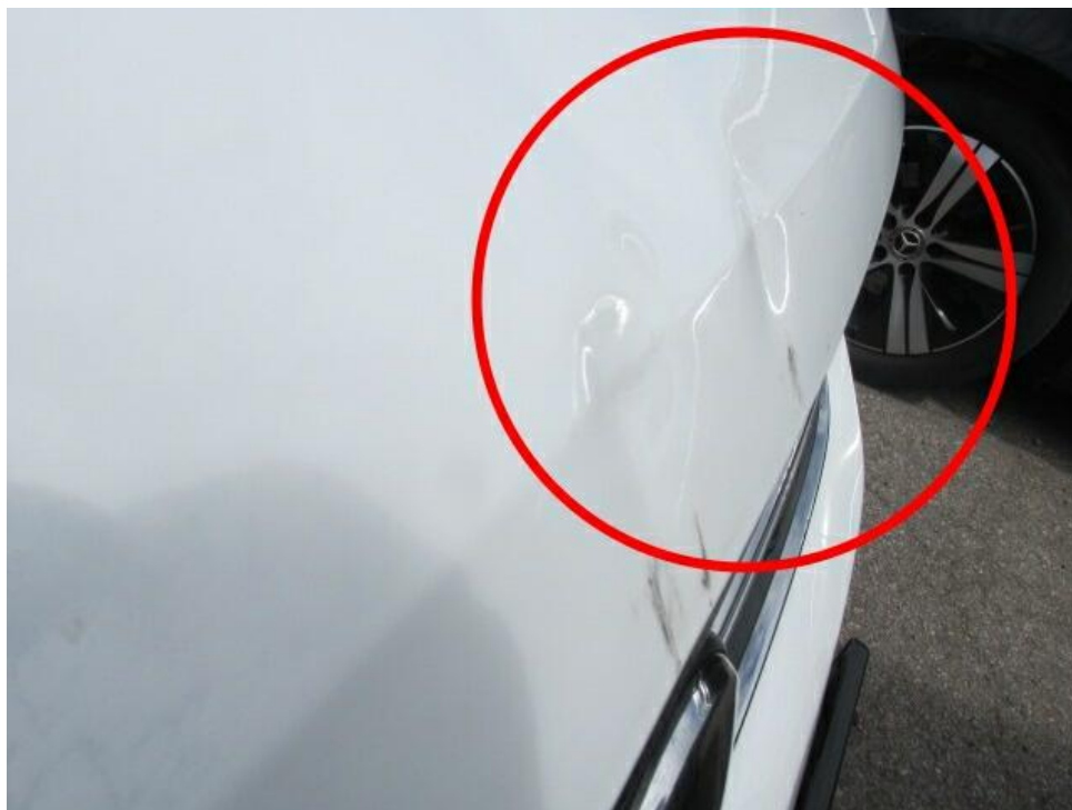
Bild 14 : Stoßfänger vorne deformiert, Motorhaube deformiert
