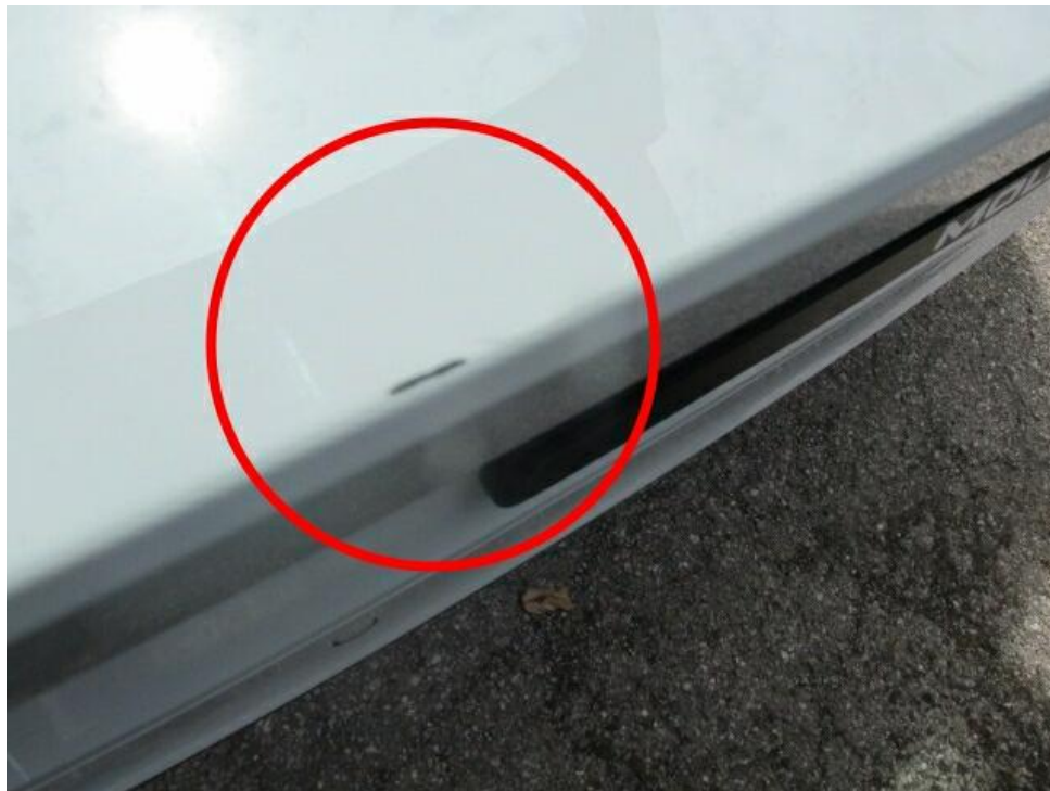
Bild 19 : Stoßfänger hinten verschrammt
