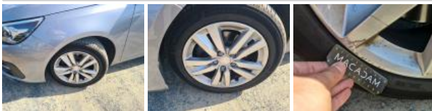
Alloy rim FL, Scratch(es), Repair/replace (lump sum)
