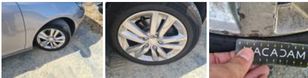
Alloy rim FL, Scratch(es), Repair/replace (lump sum)
