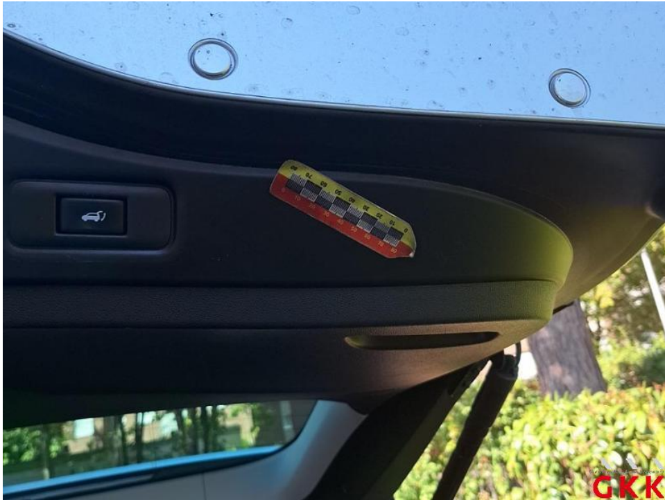
Bild 63. Heckklappe, Innenverkleidung, verkratzt, Smartrepair
