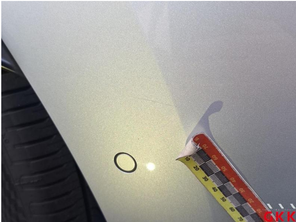
Bild 58. Stoßfänger hinten, Ecke links -lackiert-, verkratzt, lackieren
