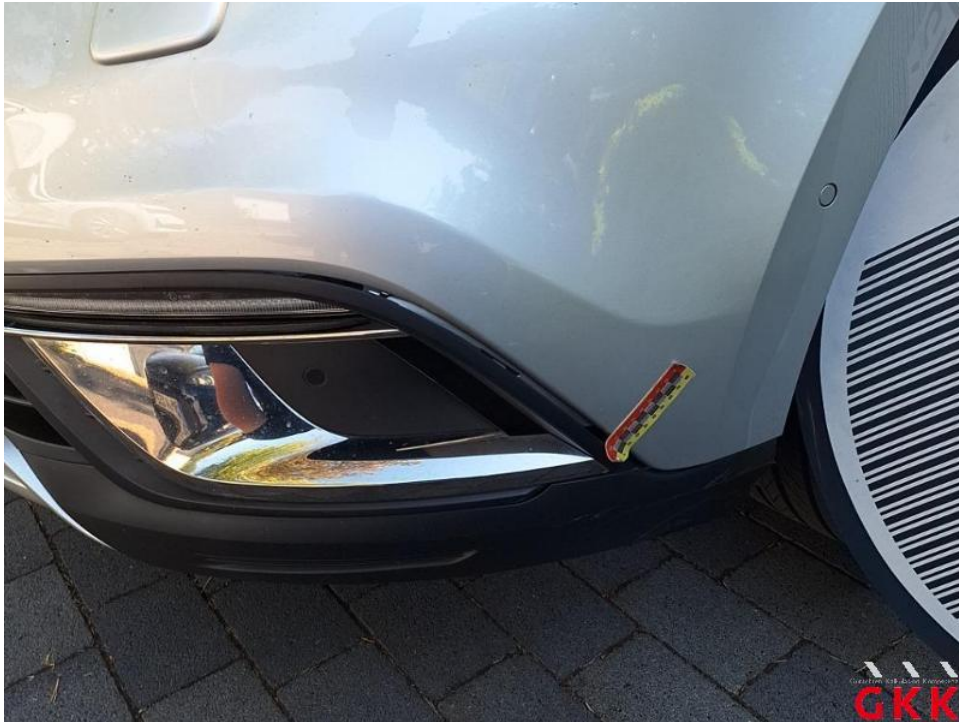
Bild 33. Stoßfänger vorne-Blende Satz, verkratzt, ersetzen
