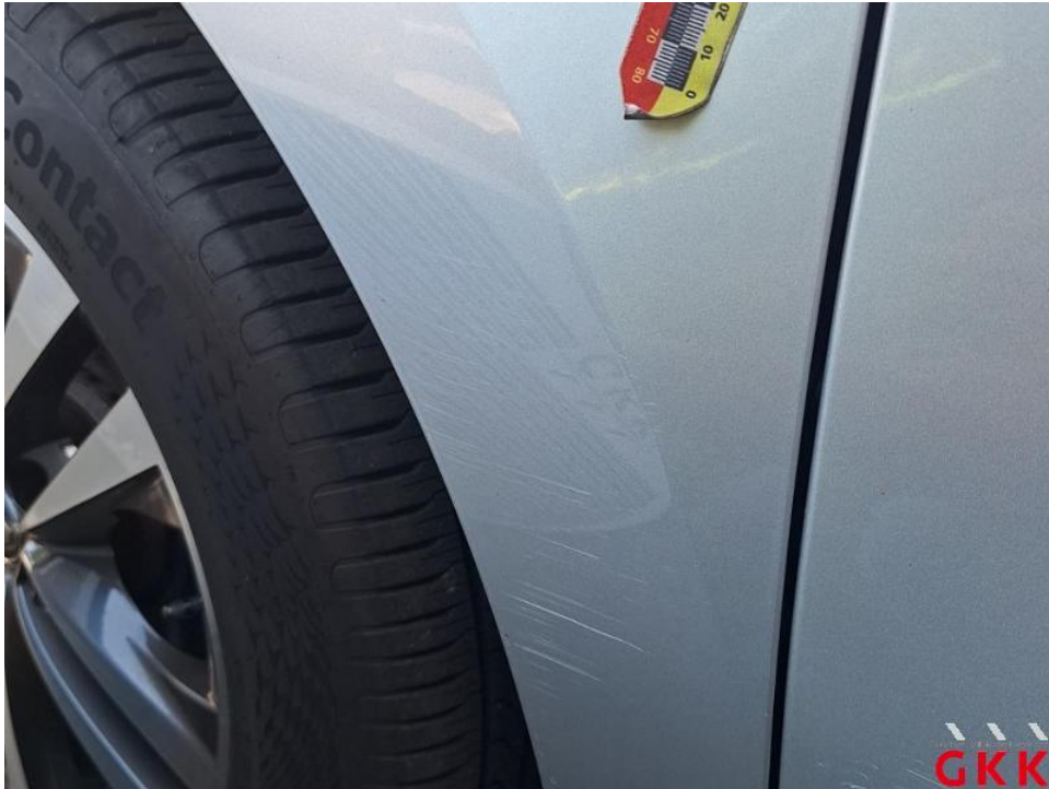
Bild 35. Kotflügel vorne links, verkratzt, lackieren
