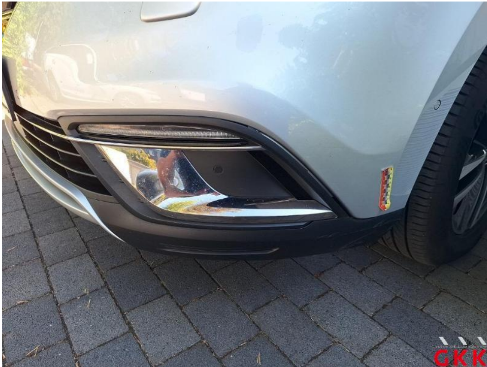
Bild 30. Stoßfänger vorne-Ecken Satz, verkratzt, ersetzen
