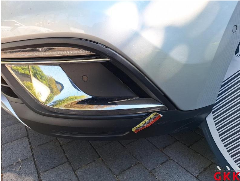
Bild 23. Stoßfänger vorne, Luftgitter, beschädigt, ersetzen
