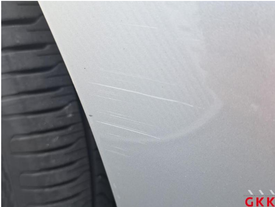
Bild 36. Kotflügel vorne links, verkratzt, lackieren
