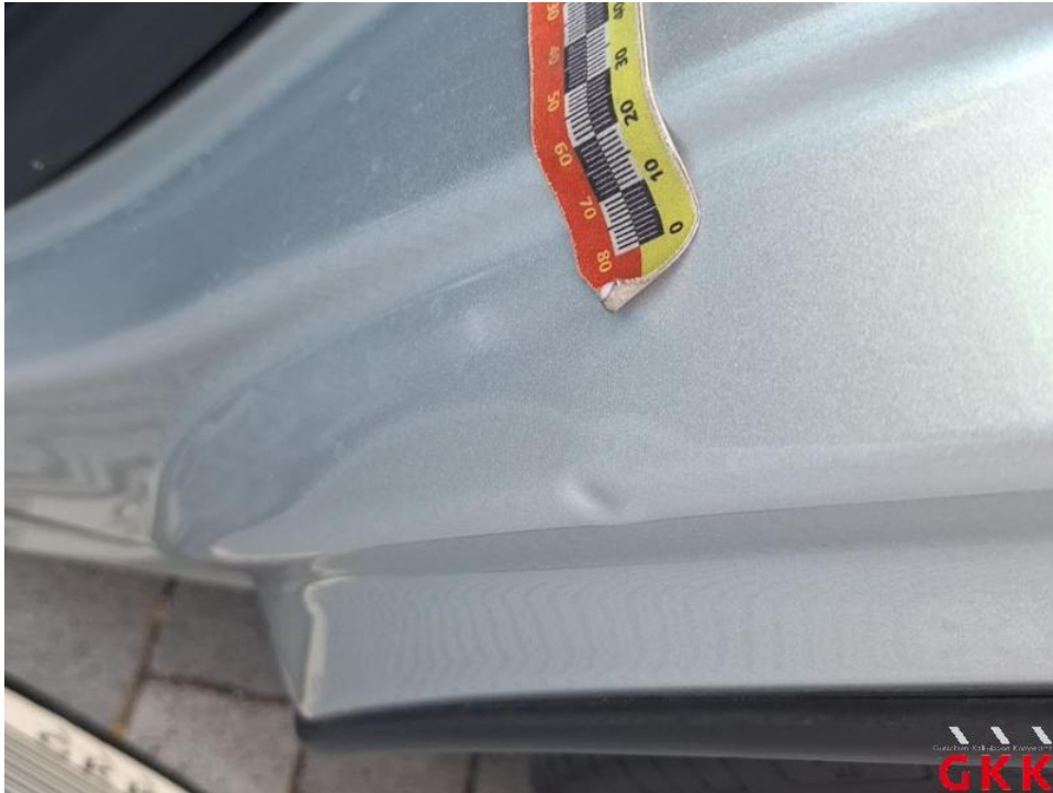
Bild 47. Tür hinten links, Einstieg, beschädigt, instand setzen - lackieren
