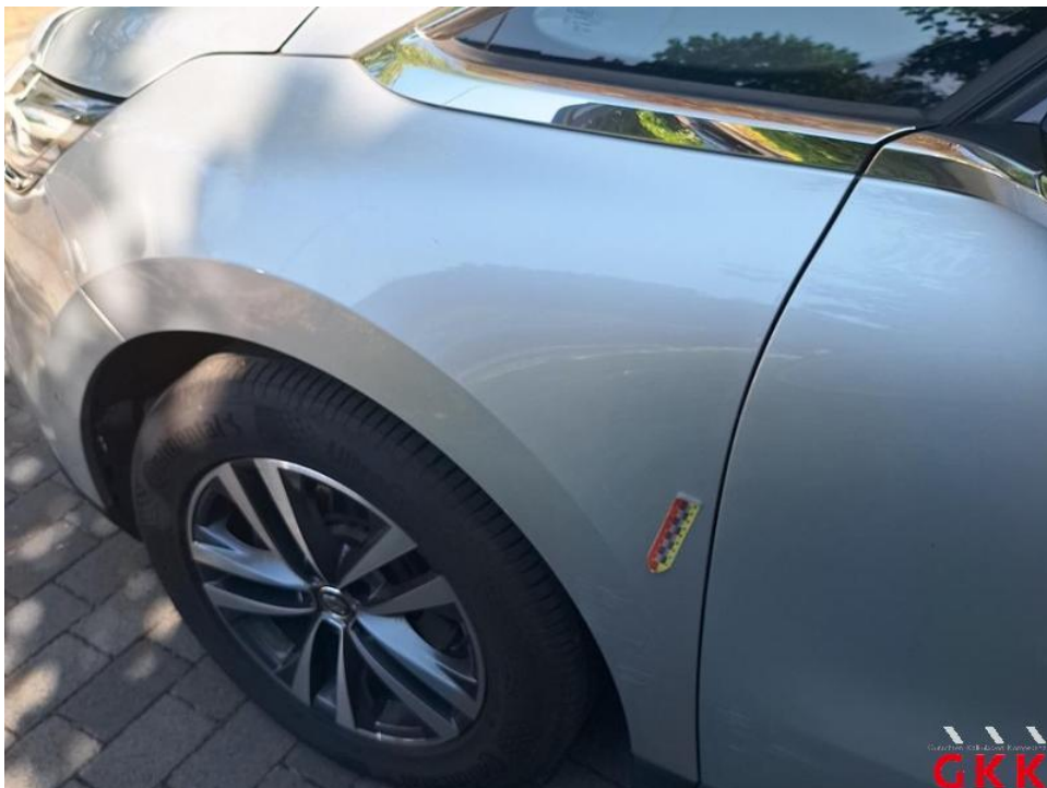
Bild 34. Kotflügel vorne links, verkratzt, lackieren
