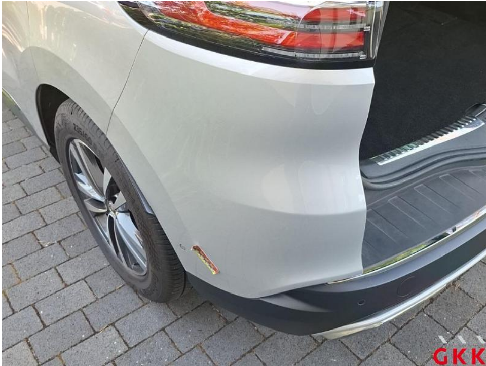
Bild 57. Stoßfänger hinten, Ecke links -lackiert-, verkratzt, lackieren
