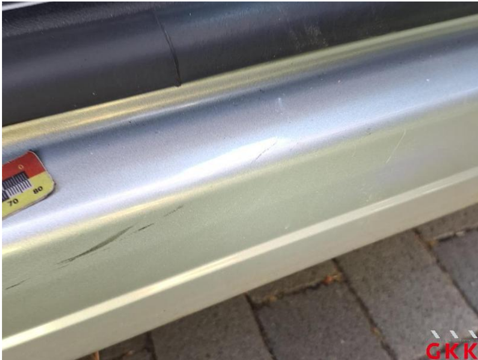
Bild 74. Tür vorne rechts, Einstieg, verkratzt, Smartrepair
