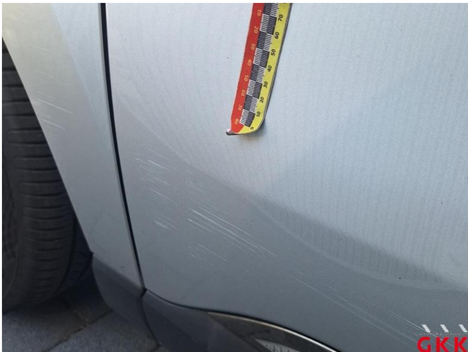
Bild 38. Tür vorne links, verkratzt, lackieren
