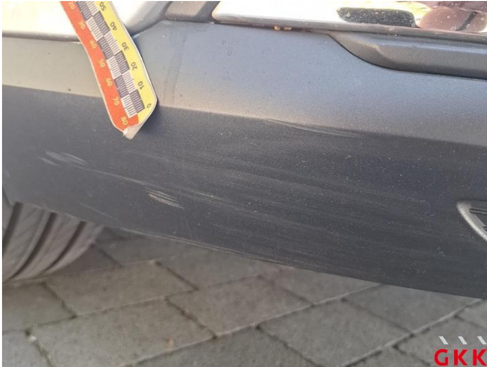
Bild 29. Stoßfänger vorne-Ecken Satz, verkratzt, ersetzen
