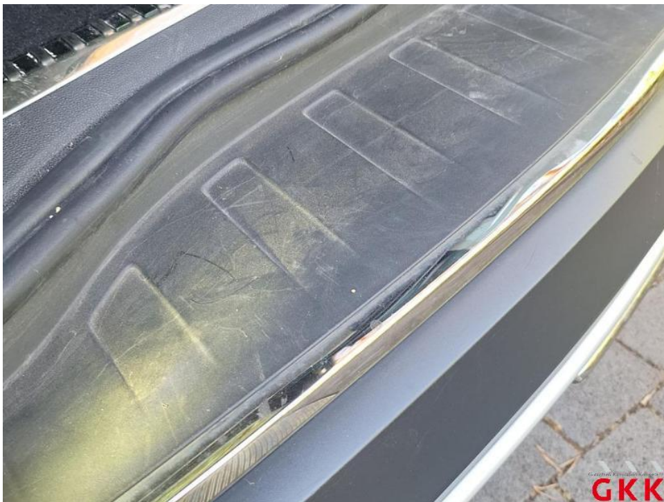
Bild 54. Stoßfänger hinten, Verkleidung -unlackiert-, verkratzt, ersetzen
