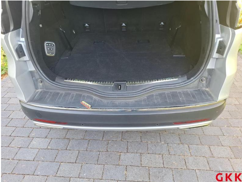
Bild 55. Stoßfänger hinten, Leiste -mittig-, beschädigt, ersetzen
