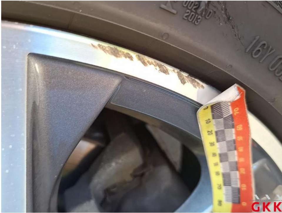
Bild 81. LM-Rad, vorne rechts, Materialabtrag, ersetzen
