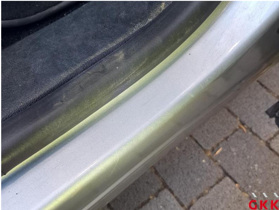
Bild 68. Tür hinten rechts, Einstieg, beschädigt, instand setzen - lackieren
