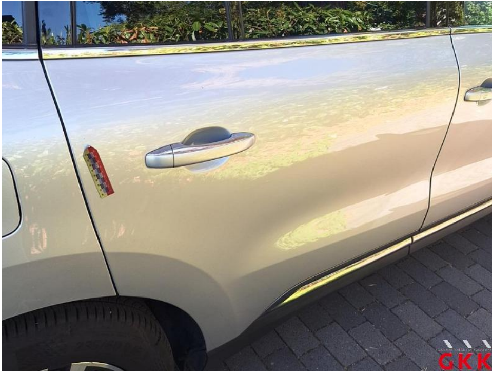
Bild 69. Tür hinten rechts, verkratzt, lackieren
