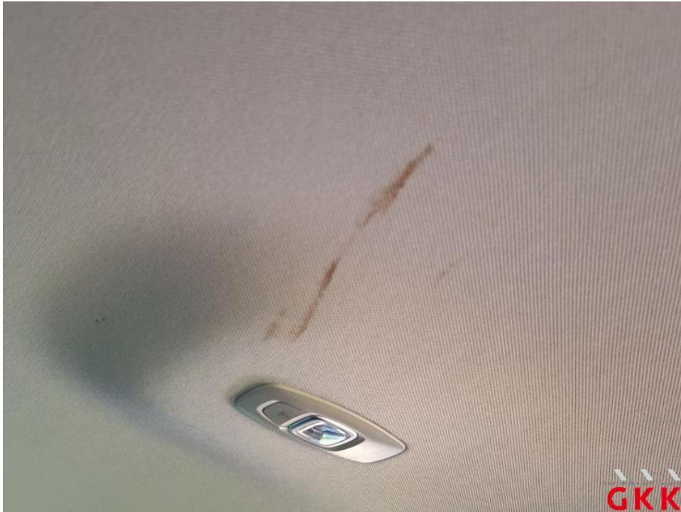
Bild 21. Himmel, verkratzt, Smartrepair
