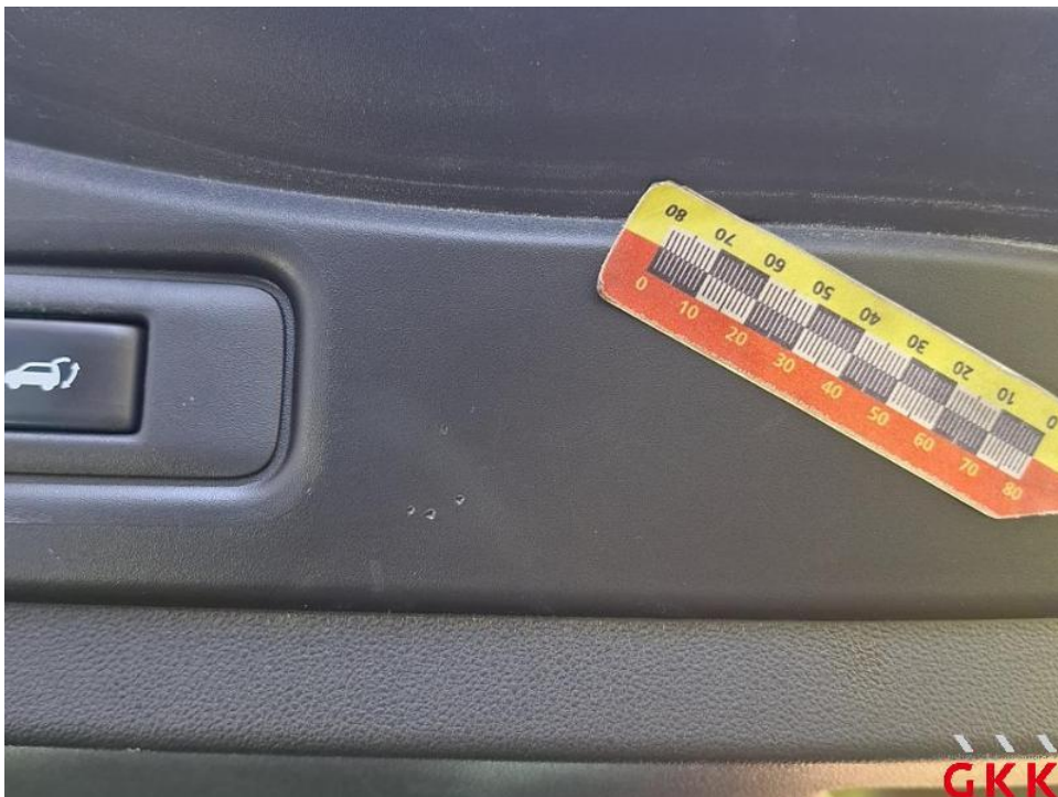
Bild 64. Heckklappe, Innenverkleidung, verkratzt, Smartrepair
