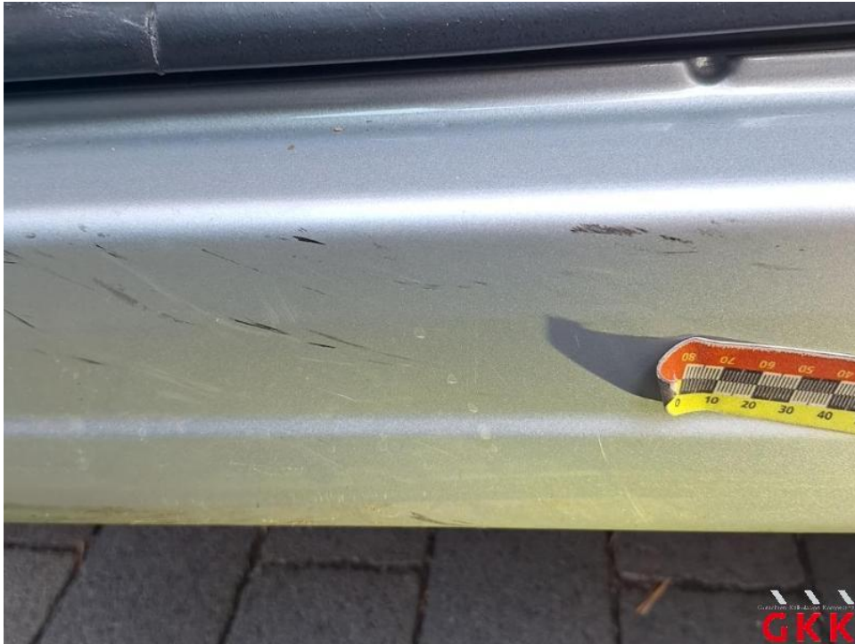
Bild 45. Tür vorne links, Einstieg, verkratzt, Smartrepair
