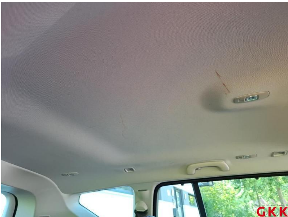
Bild 20. Himmel, verkratzt, Smartrepair
