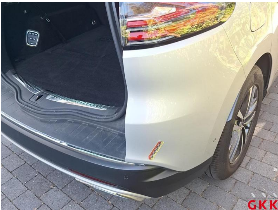
Bild 60. Stoßfänger hinten, Ecke rechts -lackiert-, verkratzt, lackieren
