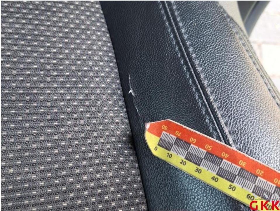
Bild 19. Sitz vorne links, Bezug Sitzkissen -Stoff-, gerissen, ersetzen
