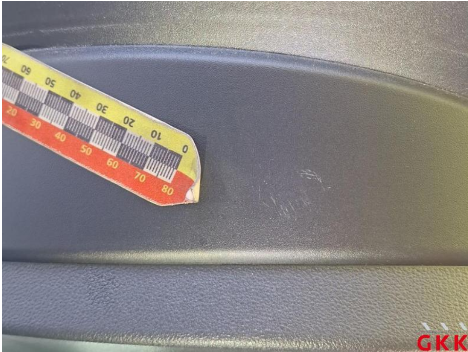
Bild 65. Heckklappe, Innenverkleidung, verkratzt, Smartrepair
