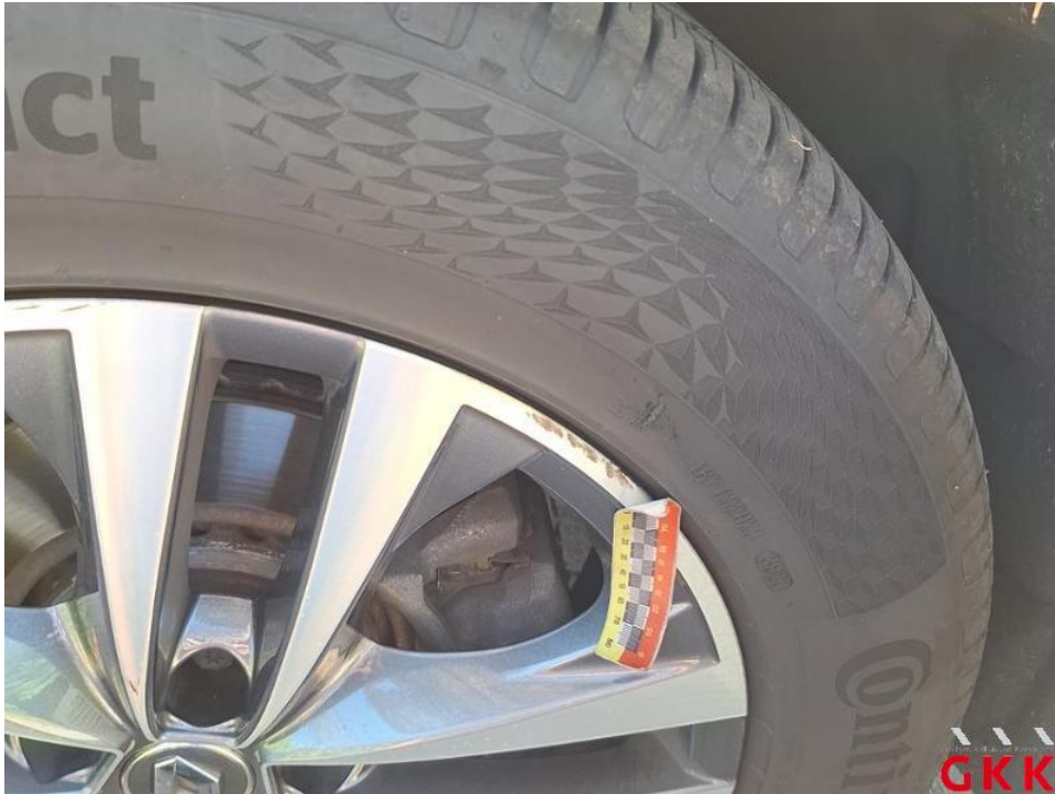
Bild 79. Reifen, vorne rechts, beschädigt, ersetzen
