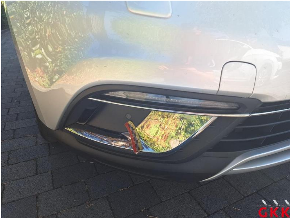
Bild 31. Stoßfänger vorne-Blende Satz, verkratzt, ersetzen
