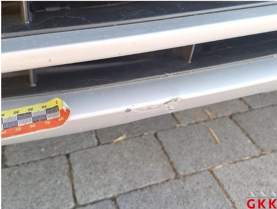
Bild 26. Stoßfänger vorne, Spoiler -lackiert-, beschädigt, ersetzen
