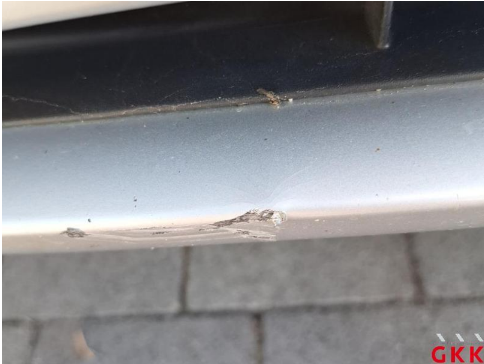
Bild 27. Stoßfänger vorne, Spoiler -lackiert-, beschädigt, ersetzen
