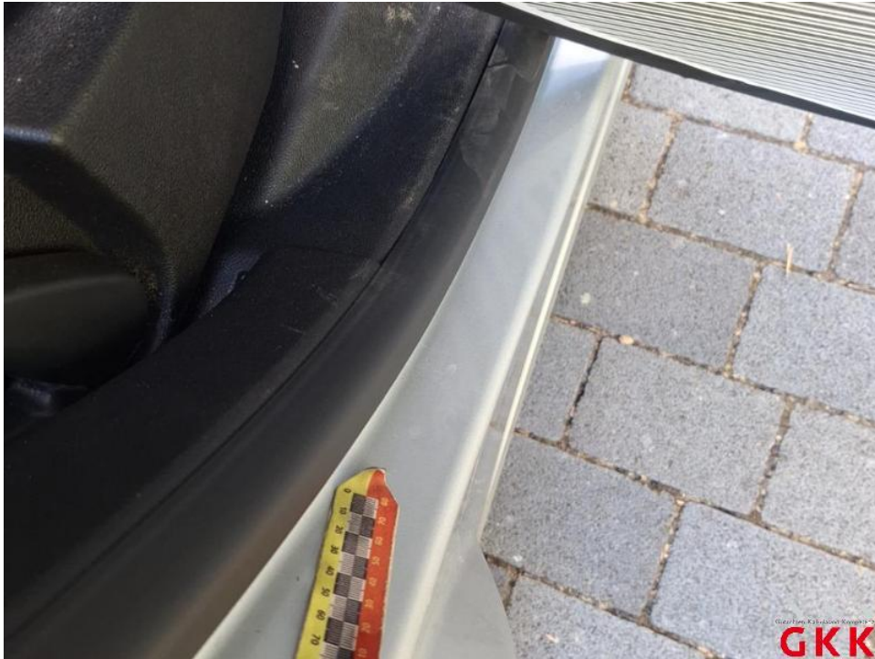
Bild 67. Tür hinten rechts, Einstieg, beschädigt, instand setzen - lackieren
