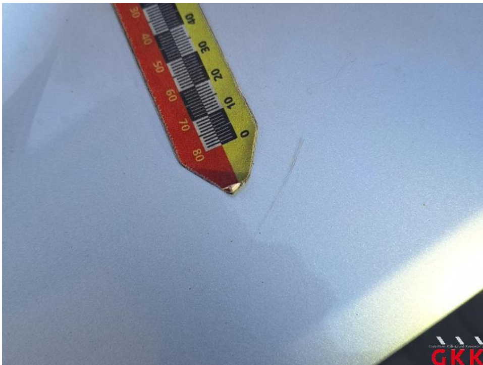
Bild 50. Heckklappe, Blende -lackiert-, verkratzt, lackieren
