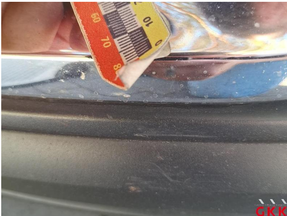
Bild 32. Stoßfänger vorne-Blende Satz, verkratzt, ersetzen
