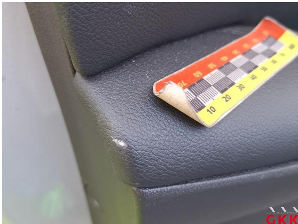
Bild 41. Tür vorne links, Innenverkleidung -Standard-, beschädigt, ersetzen
