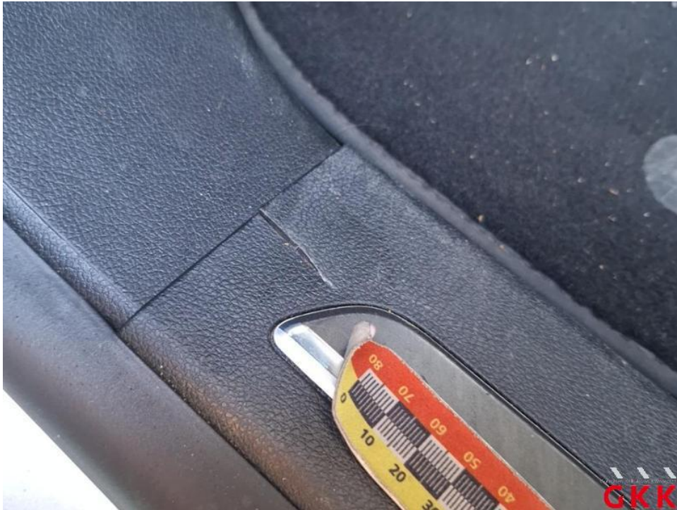
Bild 43. Tür vorne links-Einstiegverkleidung innen, beschädigt, ersetzen
