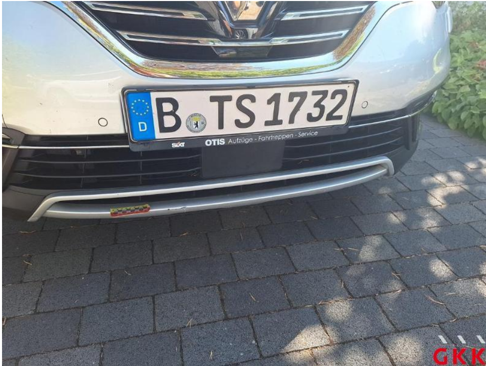
Bild 25. Stoßfänger vorne, Spoiler -lackiert-, beschädigt, ersetzen
