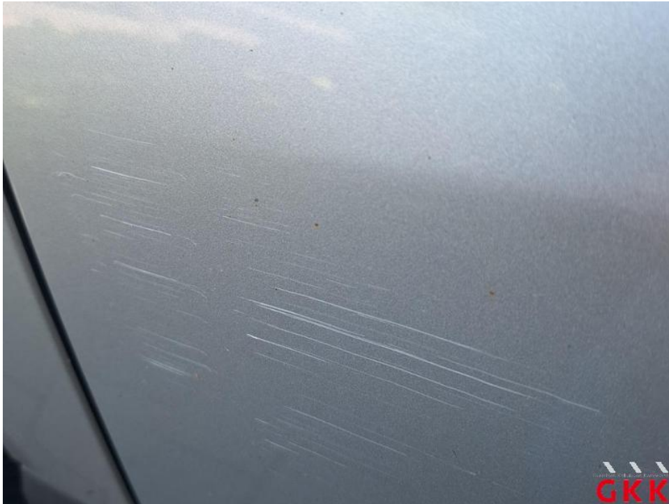
Bild 39. Tür vorne links, verkratzt, lackieren
