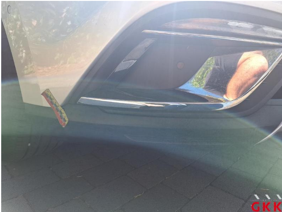
Bild 28. Stoßfänger vorne-Ecken Satz, verkratzt, ersetzen
