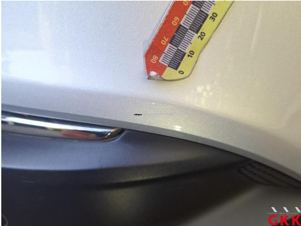
Bild 61. Stoßfänger hinten, Ecke rechts -lackiert-, verkratzt, lackieren
