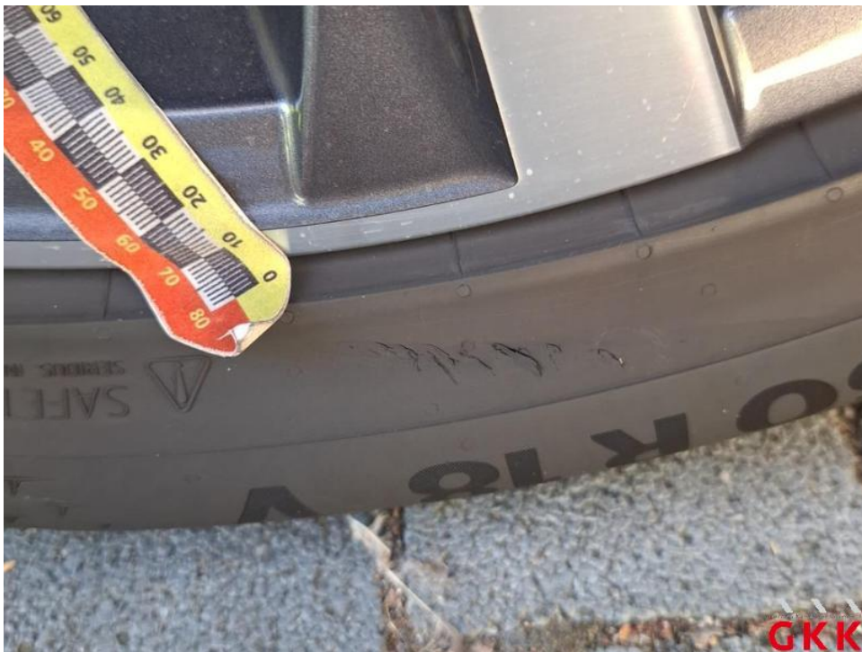
Bild 78. Reifen, vorne rechts, beschädigt, ersetzen
