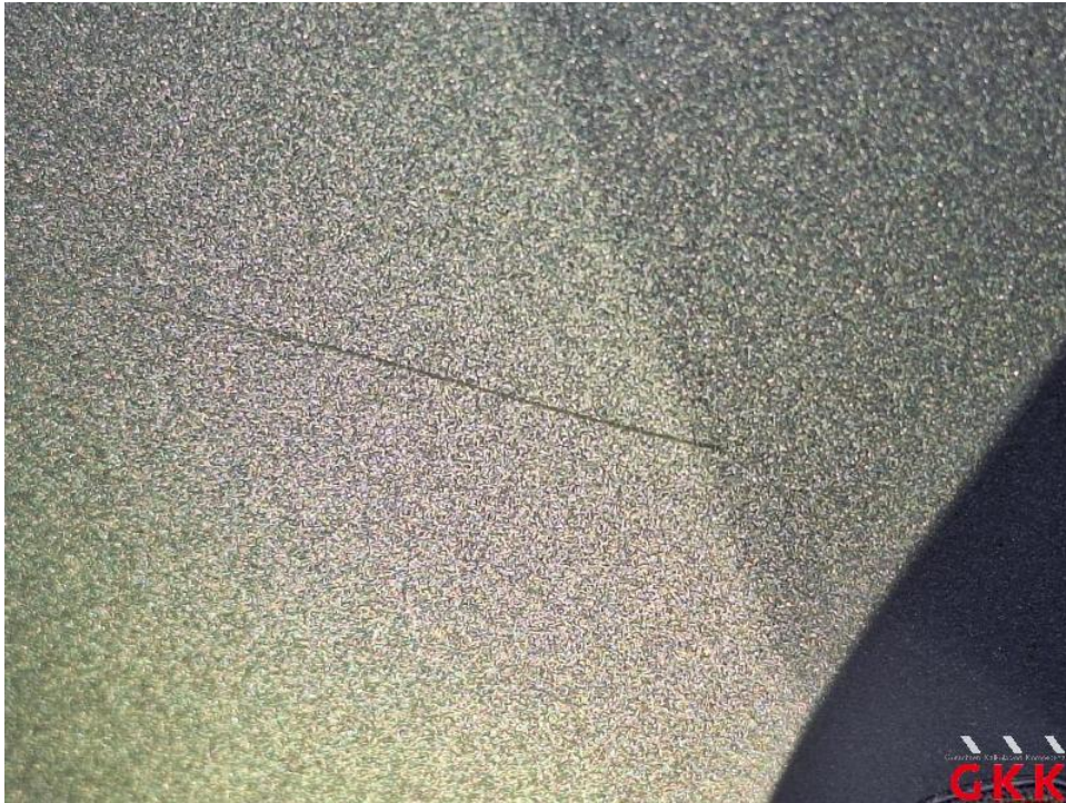
Bild 59. Stoßfänger hinten, Ecke links -lackiert-, verkratzt, lackieren
