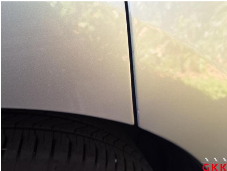
Bild 70. Tür hinten rechts, verkratzt, lackieren
