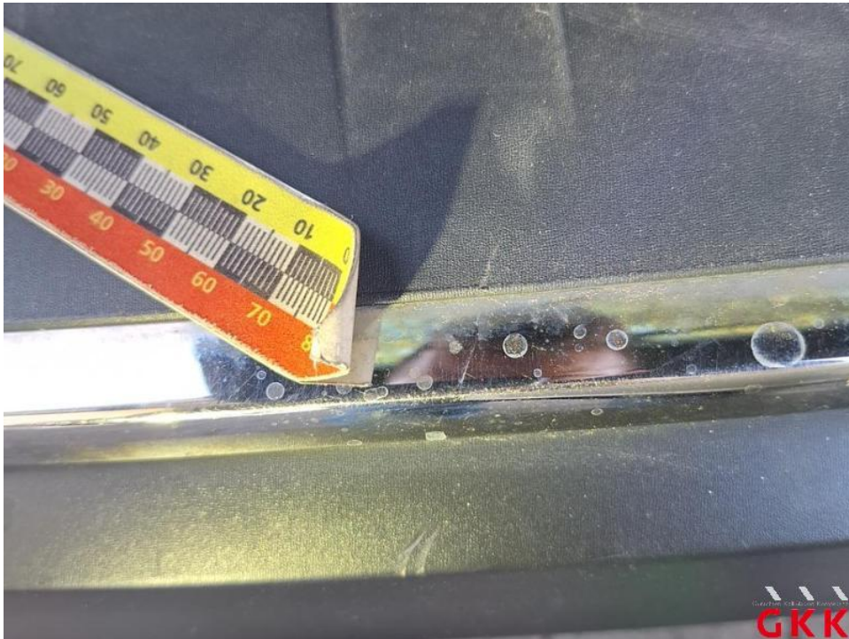
Bild 56. Stoßfänger hinten, Leiste -mittig-, beschädigt, ersetzen
