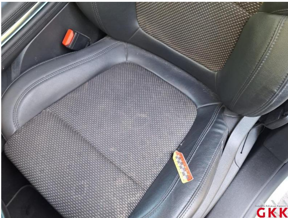
Bild 18. Sitz vorne links, Bezug Sitzkissen -Stoff-, gerissen, ersetzen
