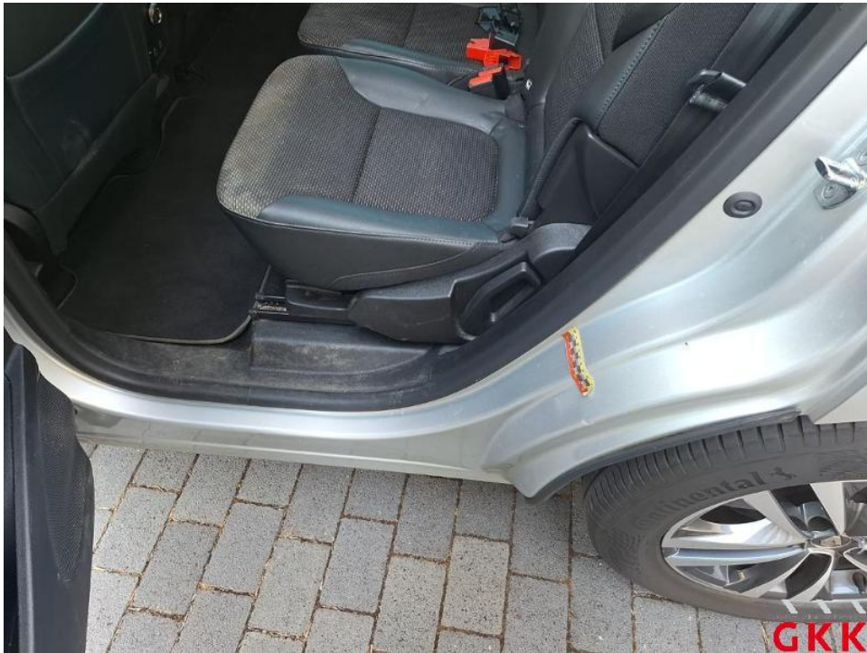
Bild 46. Tür hinten links, Einstieg, beschädigt, instand setzen - lackieren
