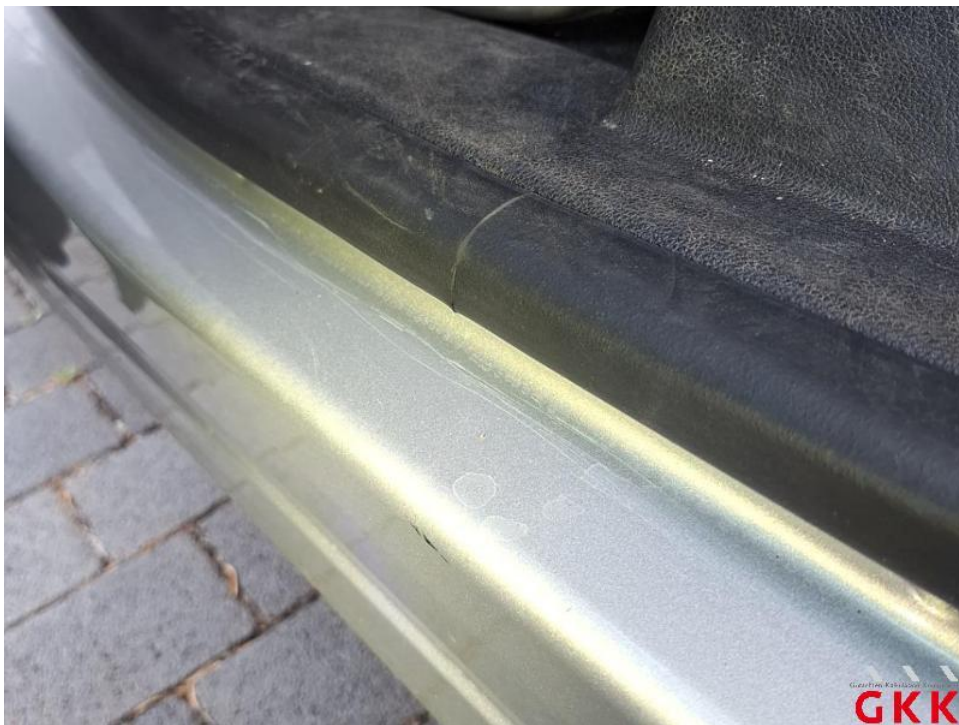
Bild 48. Tür hinten links, Einstieg, beschädigt, instand setzen - lackieren
