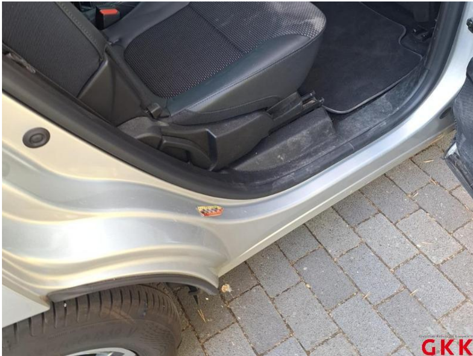
Bild 66. Tür hinten rechts, Einstieg, beschädigt, instand setzen - lackieren
