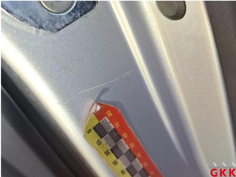
Bild 76. B- Säule rechts, verkratzt, Smartrepair
