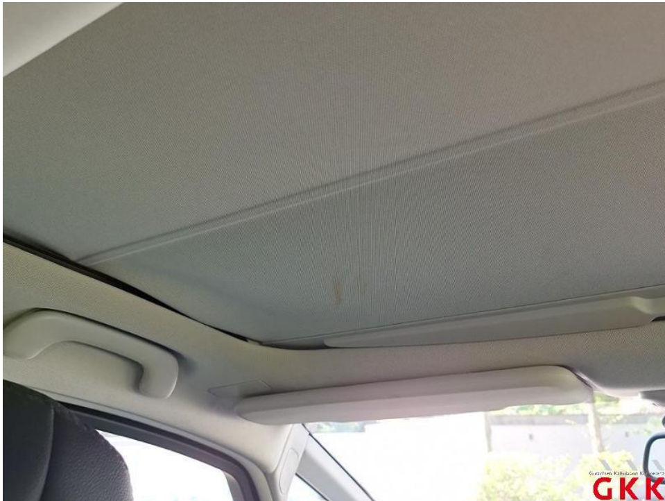
Bild 22. Himmel, verkratzt, Smartrepair
