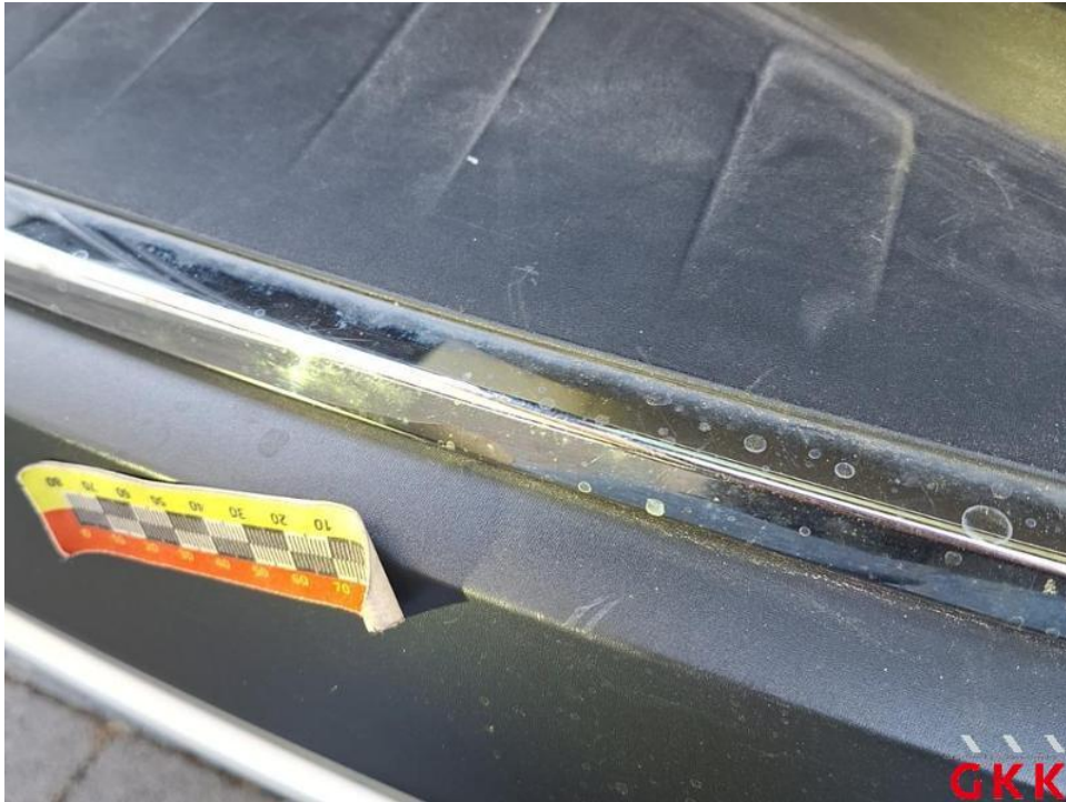
Bild 53. Stoßfänger hinten, Verkleidung -unlackiert-, verkratzt, ersetzen
