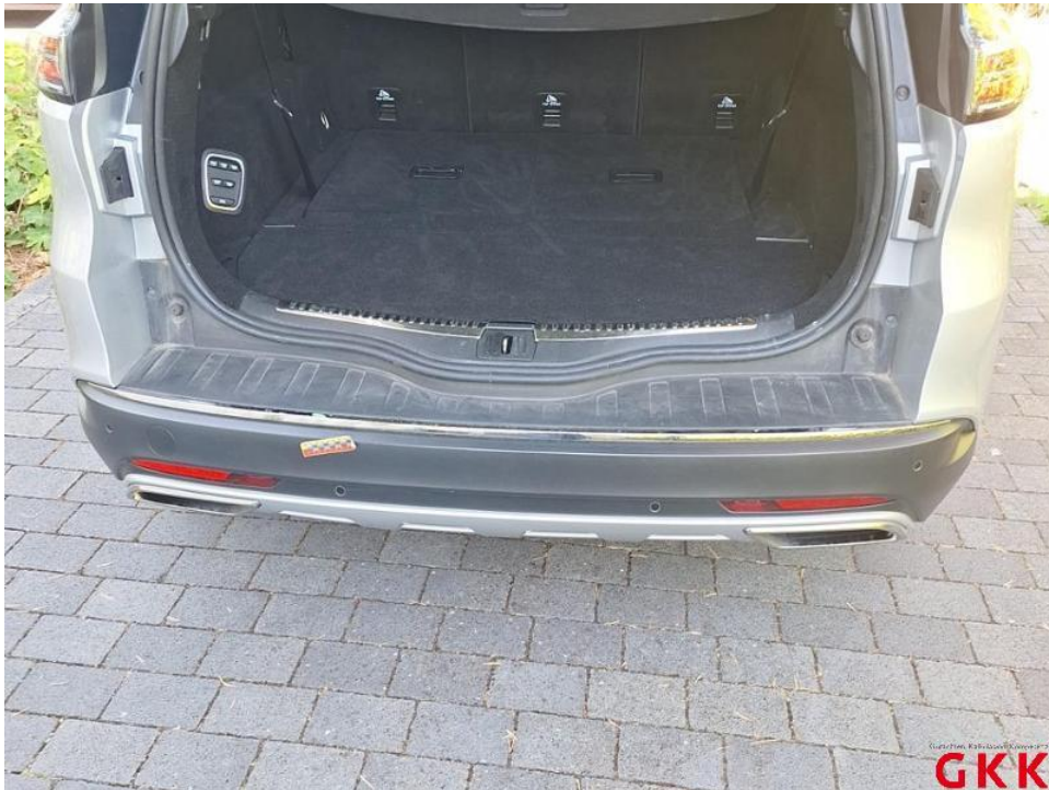
Bild 52. Stoßfänger hinten, Verkleidung -unlackiert-, verkratzt, ersetzen
