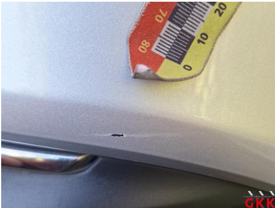
Bild 62. Stoßfänger hinten, Ecke rechts -lackiert-, verkratzt, lackieren
