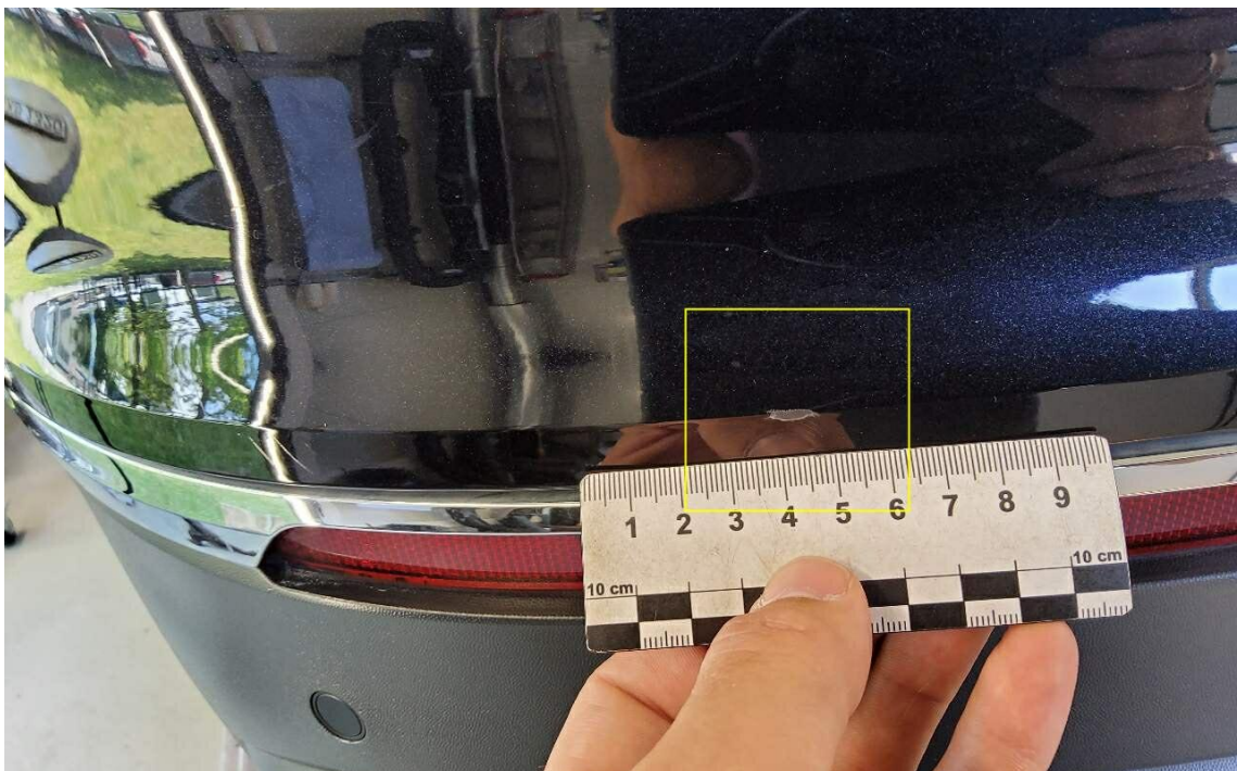
Bild 19 : Stoßfänger hinten verformt und verschrammt
