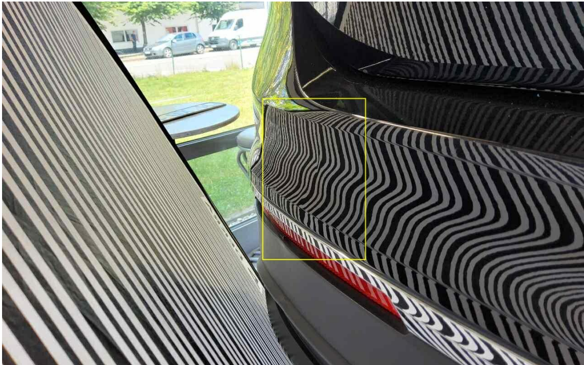
Bild 18 : Stoßfänger hinten verformt und verschrammt
