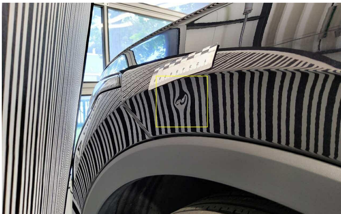
Bild 15 : Kotflügel links eingedellt und zerkratzt
