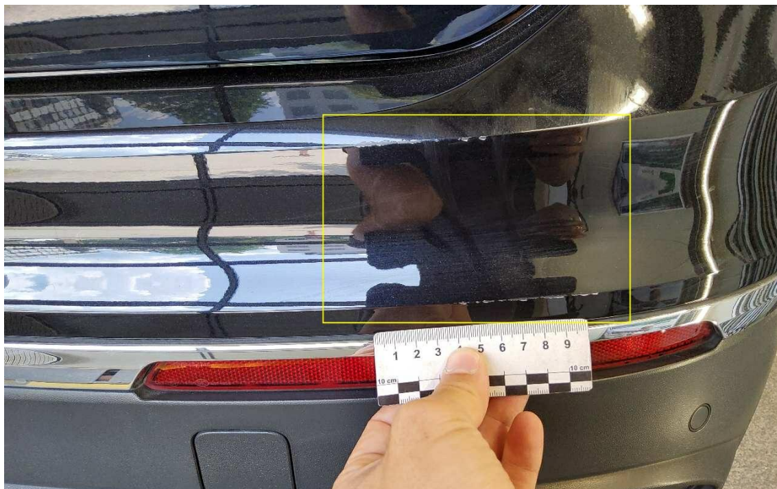
Bild 22 : Stoßfänger hinten verformt und verschrammt
