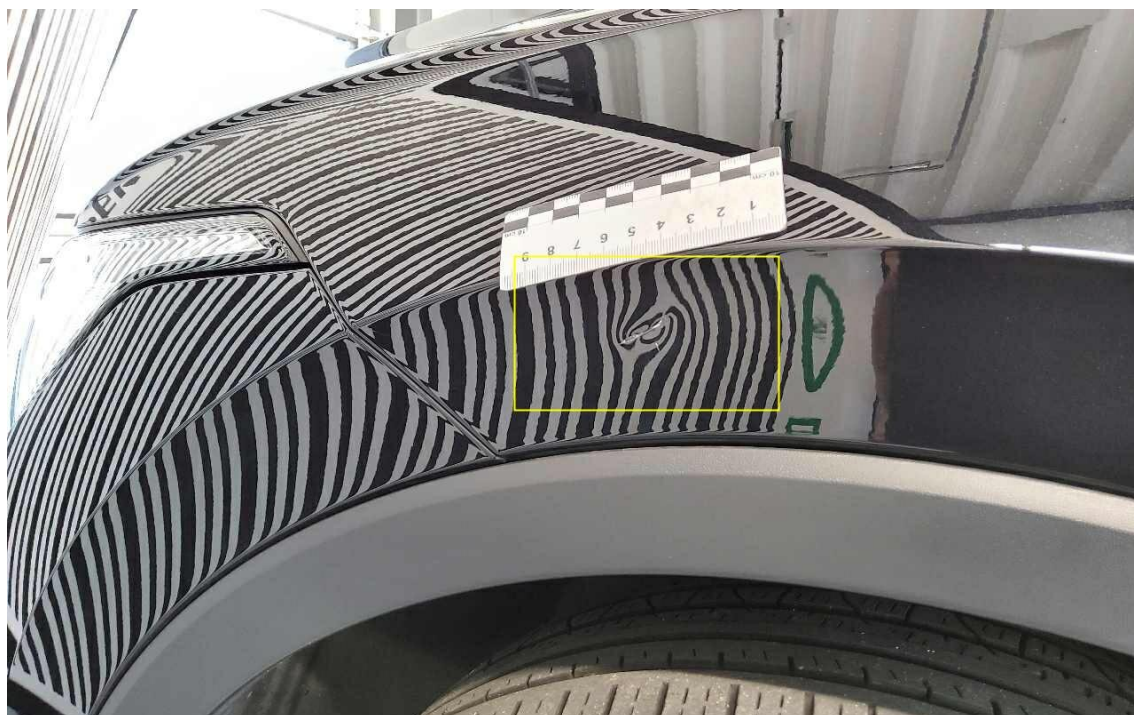
Bild 16 : Kotflügel links eingedellt und zerkratzt
