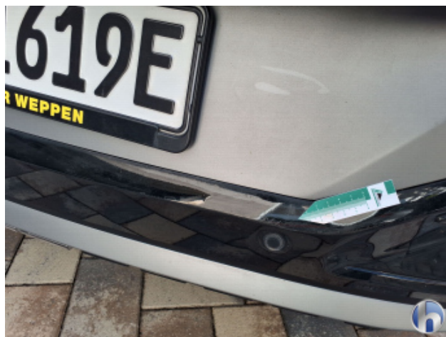
2. Stoßfänger Hinten Kratzer - Smart Repair
