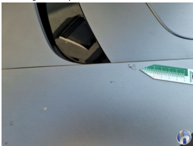
7. Dach Kratzer - Lackieren
