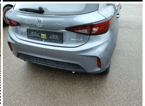
Stoßfänger / Hinten / Gebrochen
