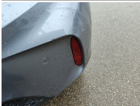
Stoßfänger / Hinten / Gebrochen
