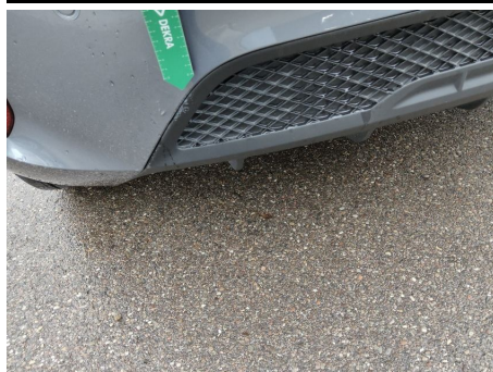
Spoiler / Hinten / Gebrochen
