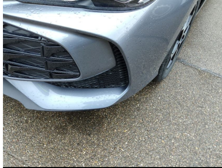
Stoßfänger / Vorne / Delle
