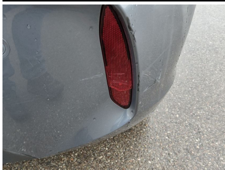
Reflektor / Hinten Rechts / Gebrochen
