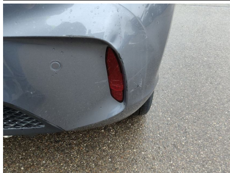
Stoßfänger / Hinten / Gebrochen
