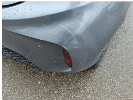
Stoßfänger / Hinten / Gebrochen
