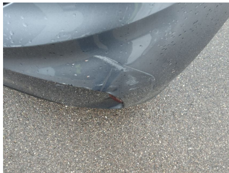
Stoßfänger / Hinten / Gebrochen
