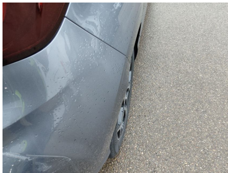
Stoßfänger / Hinten / Gebrochen
