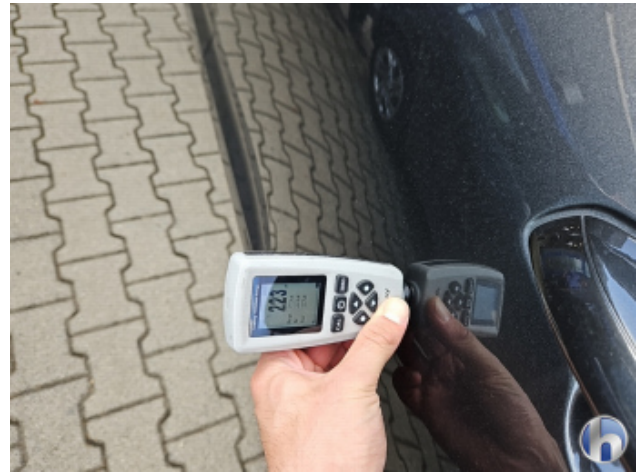
1. Tür Hinten - Links Nachlackiert - Ohne Reparatur
