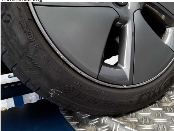
Beschädigung #1: Rad/Reifen: Leichtmetallfelge vorn rechts - Kratz... Wertminderung
