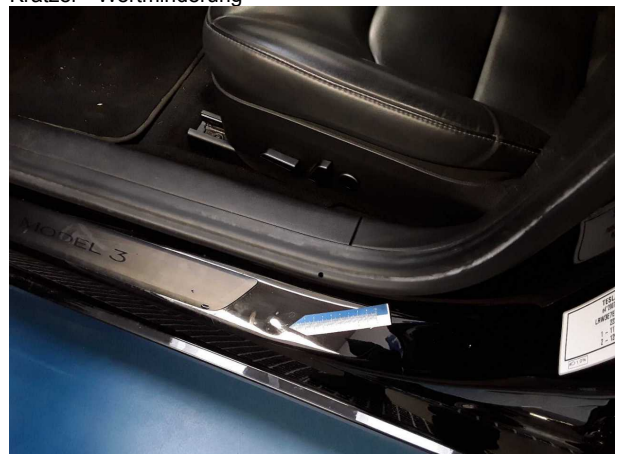
Beschädigung #2: Schweller links: Einstieg - Delle(n) - Smart Repair
