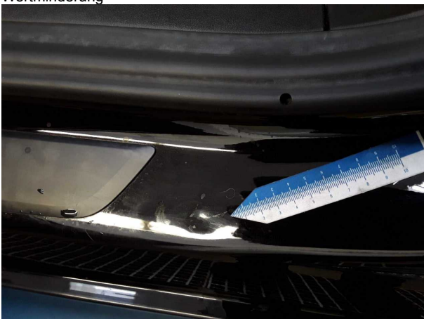
Beschädigung #2: Schweller links: Einstieg - Delle(n) - Smart Repair
