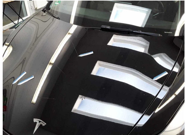
Beschädigung #11: Motorhaube: Motorhaube (Steinschläge und Anätzungen) - Lackmangel - lackieren
