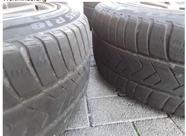
Beschädigung #6: 2.Radsatz: Reifensatz komplett (Restprofilstärke <4mm) - verschlissen - erneuern
