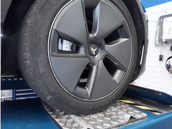
Beschädigung #1: Rad/Reifen: Leichtmetallfelge vorn rechts - Kratz... Wertminderung
