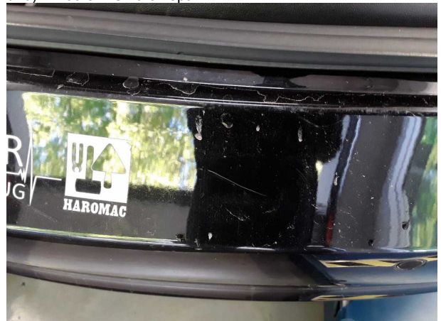
Beschädigung #4: Stossfänger hinten: Stossfänger hinten (beklebt und) - Kratzer - Smart Repair
