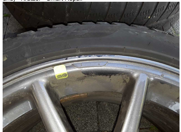
Beschädigung #5: 2.Radsatz: 2 Leichtmetallfelgen - Kratzer - Wertminderung
