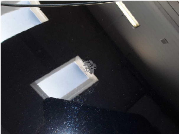
Beschädigung #10: Heckklappe/-tür: Heckklappe (Anätzung) - Lackmangel - lackieren
