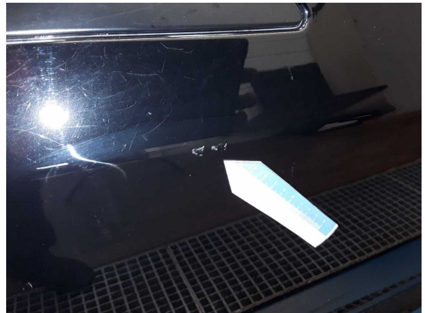
Beschädigung #8: Tür vorn rechts: Tür - Kratzer - lackieren
