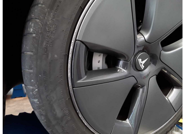
Beschädigung #1: Rad/Reifen: Leichtmetallfelge vorn rechts - Kratzer - Wertminderung
