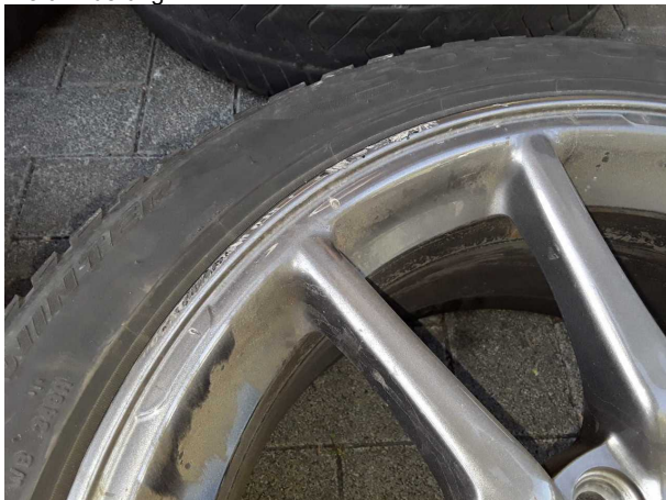
Beschädigung #5: 2.Radsatz: 2 Leichtmetallfelgen - Kratzer - Wertminderung
