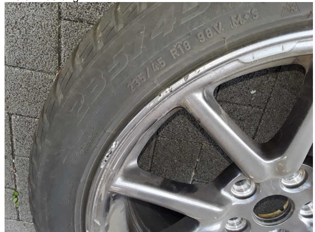
Beschädigung #5: 2.Radsatz: 2 Leichtmetallfelgen - Kratzer - Wertminderung
