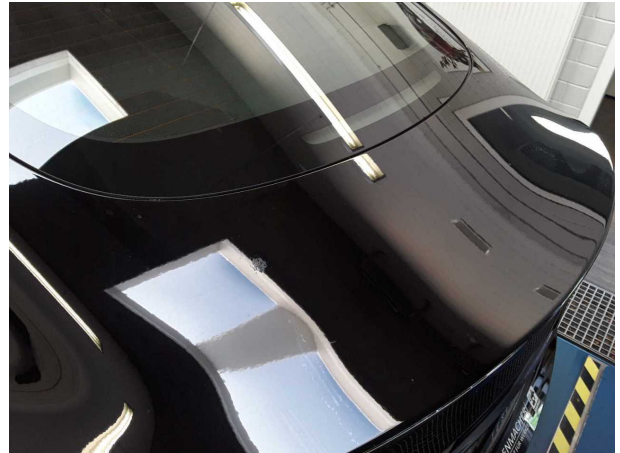
Beschädigung #10: Heckklappe/-tür: Heckklappe (Anätzung) - Lackmangel - lackieren
