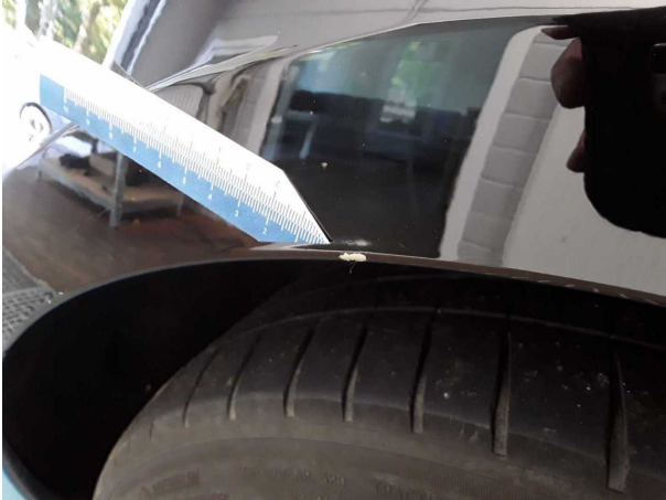
Beschädigung #3: Seitenwand rechts: Seitenwand - Kratzer - Smart Repair
