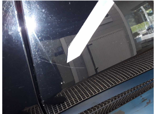
Beschädigung #7: Tür hinten links: Tür - Kratzer - lackieren
