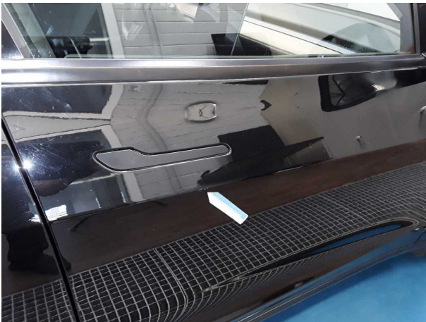
Beschädigung #8: Tür vorn rechts: Tür - Kratzer - lackieren
