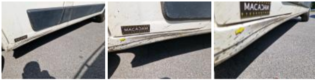
Door FL, Scratch(es), Paint
