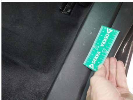
Enjoliveur seuil de porte / Arrière Droit / Rayure
