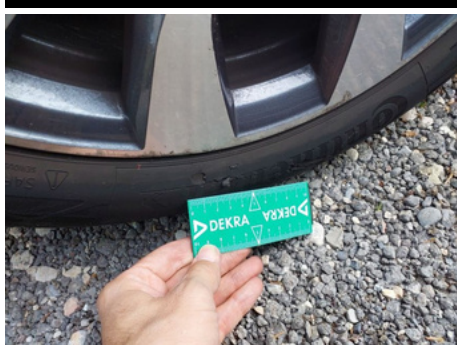
Pneu / Arrière Droit / Déchiré
