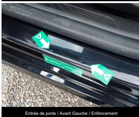
Entrée de porte / Avant Gauche / Enfoncement
