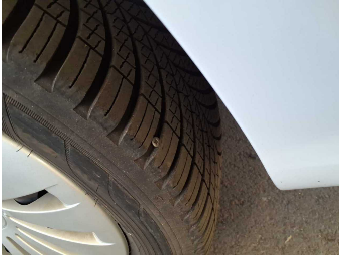
Damage 4: Wheel / tyres: Tyre - rear left side (Fremdkörper in Lauffläche) - Defective - Replace
