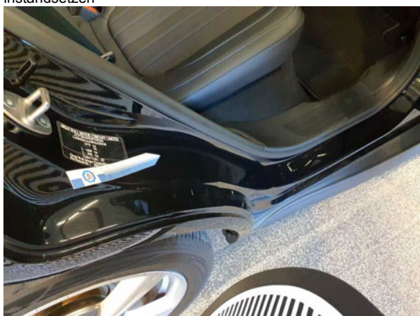
Beschädigung #2: Seitenwand rechts: Einstieg - Delle(n) - sanft instandsetzen
