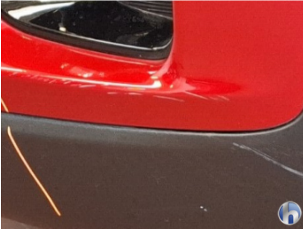
1. Stoßfänger Vorne Kratzer - Smart Repair
