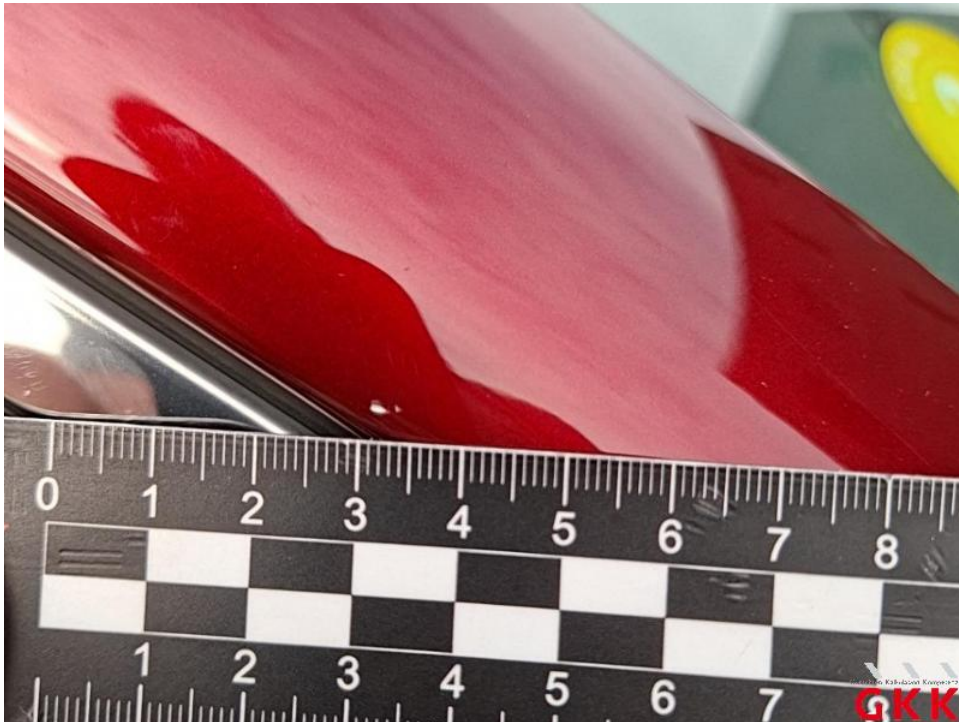
Bild 34. Frontscheibe, Leiste -rechts-, verkratzt, auslegen, schleifen, polieren
