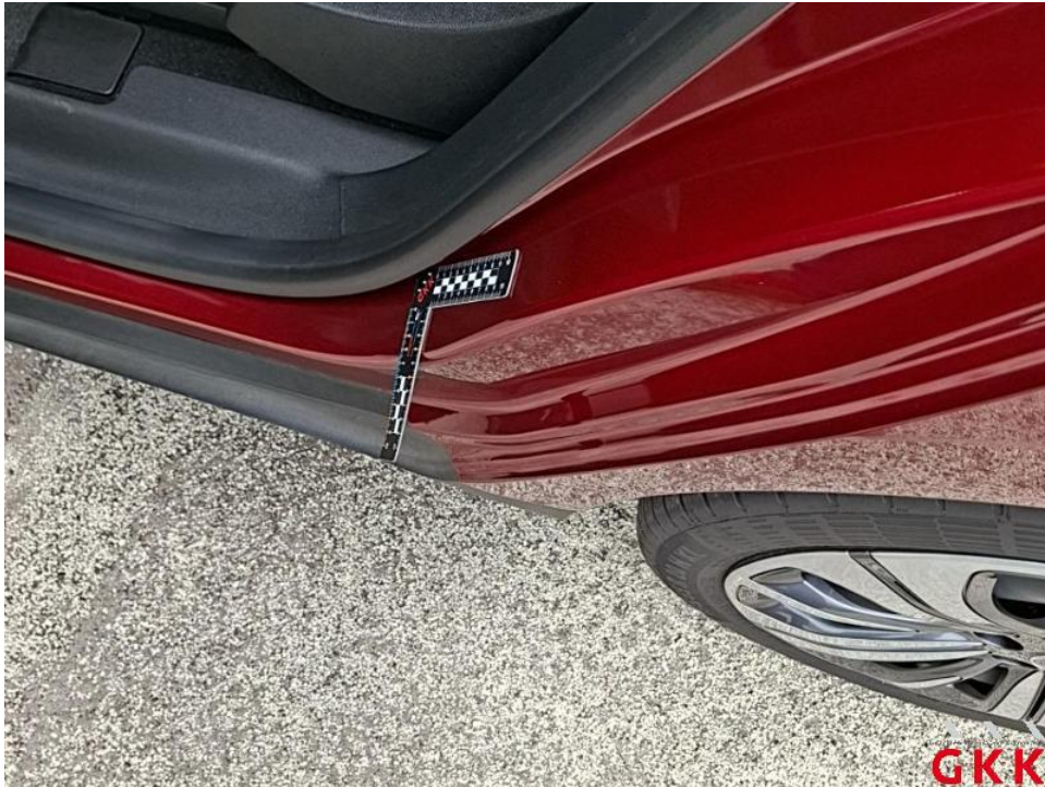
Bild 43. Tür hinten links, Einstieg, beschädigt, Smartrepair
