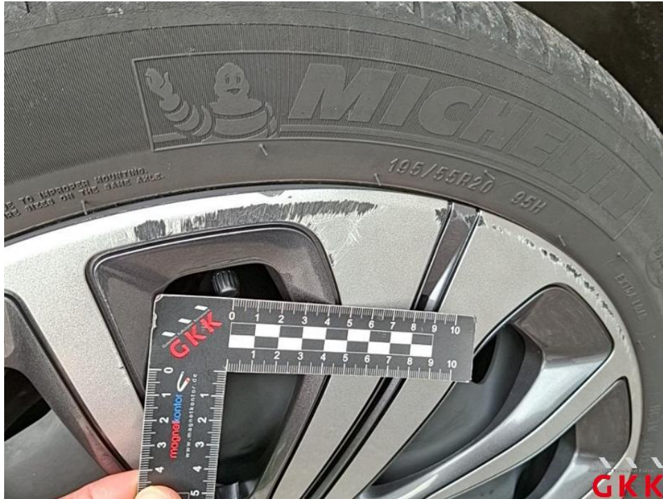
Bild 29. Radkappe(n), vorne rechts, verkratzt, ersetzen
