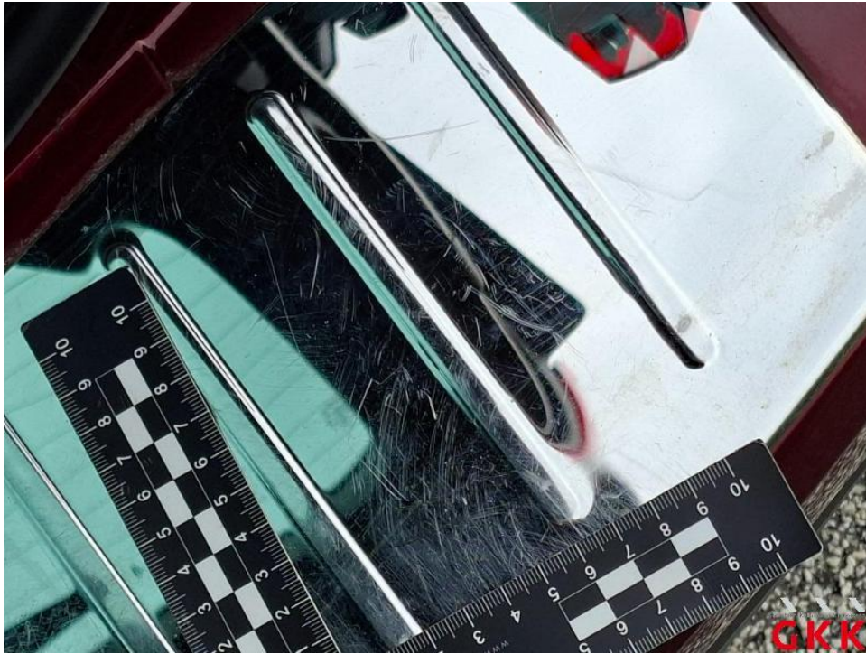
Bild 41. Stoßfänger hinten, Auftritt, beschädigt, ersetzen
