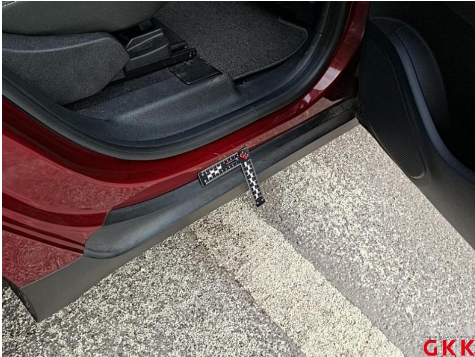
Bild 35. Tür hinten rechts, Einstieg, verkratzt, Smartrepair
