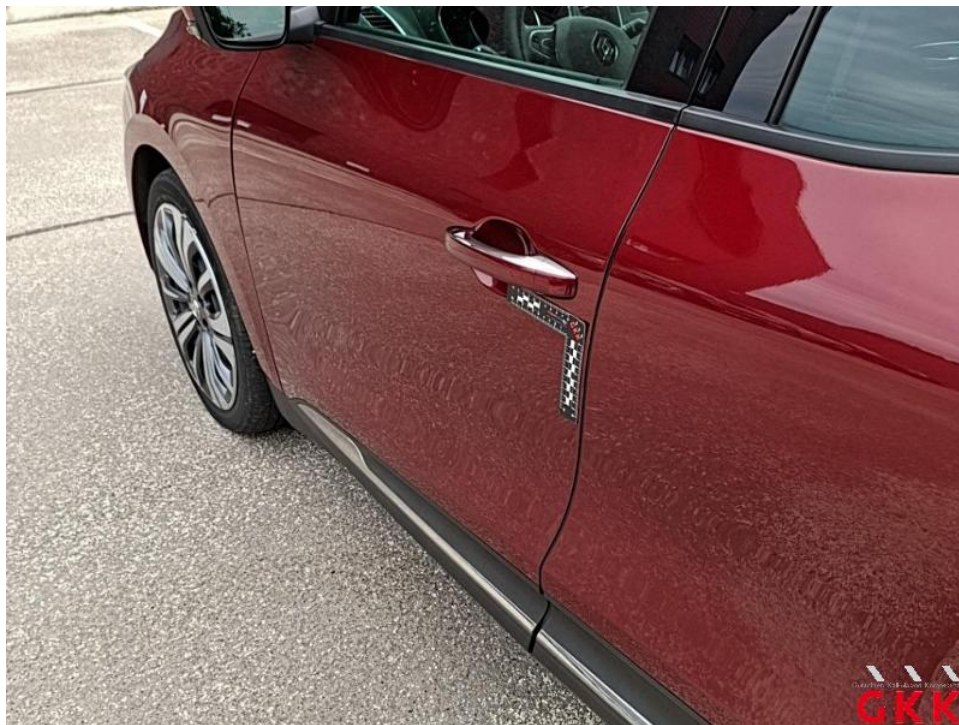
Bild 48. Tür vorne links, Kante, verkratzt, auslegen, schleifen, polieren
