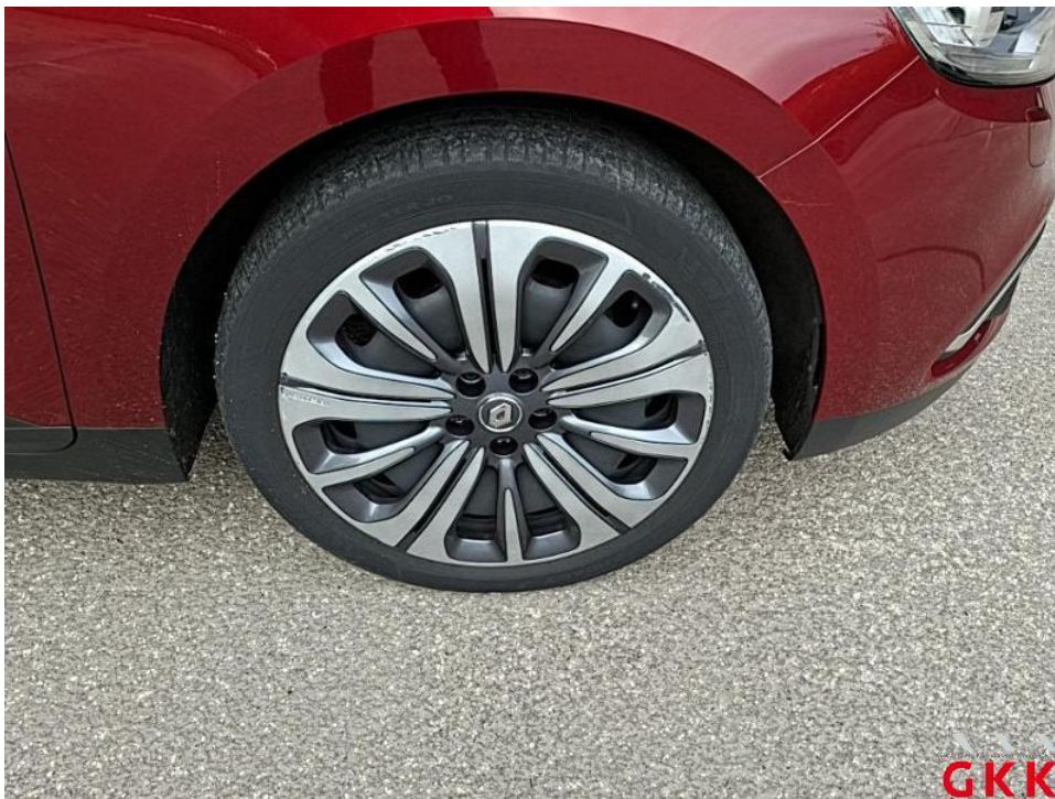
Bild 28. Radkappe(n), vorne rechts, verkratzt, ersetzen
