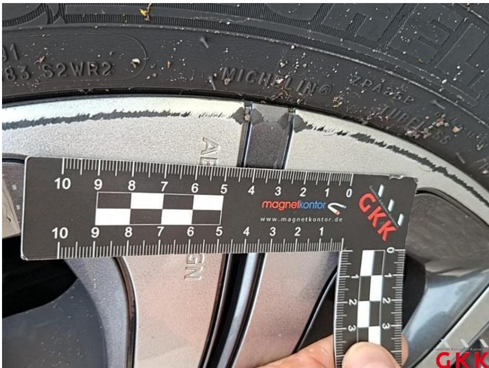
Bild 16. Radkappe(n), vorne links, verkratzt, ersetzen
