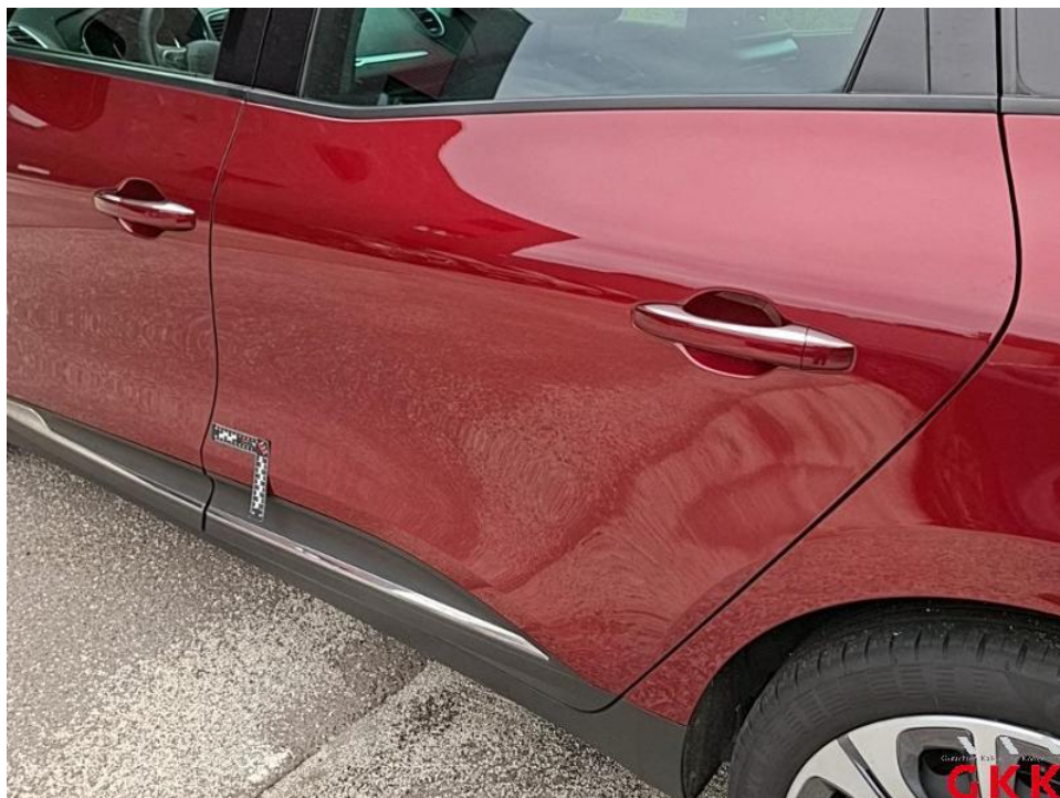
Bild 45. Tür hinten links, beschädigt, instand setzen - lackieren
