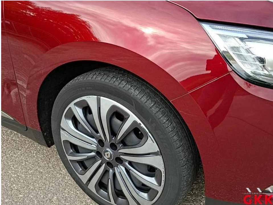
Bild 31. Kotflügel vorne rechts, verkratzt, auslegen, schleifen, polieren
