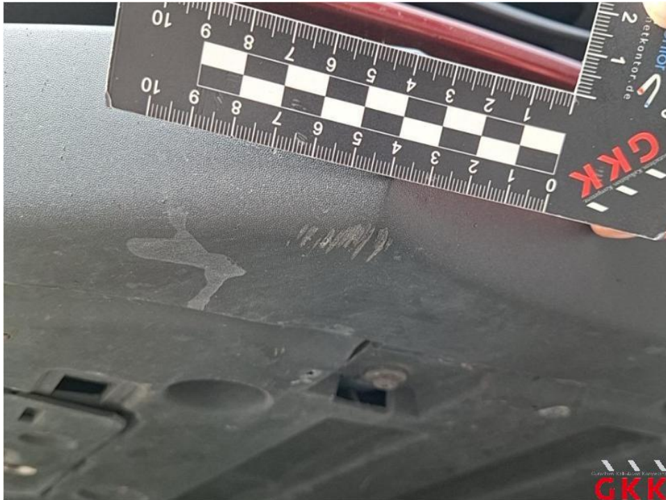
Bild 27. Stoßfänger vorne, Spoiler -unlackiert-, verkratzt, ersetzen
