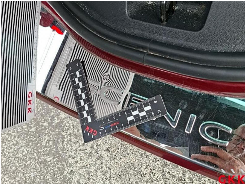
Bild 42. Stoßfänger hinten, Auftritt, beschädigt, ersetzen
