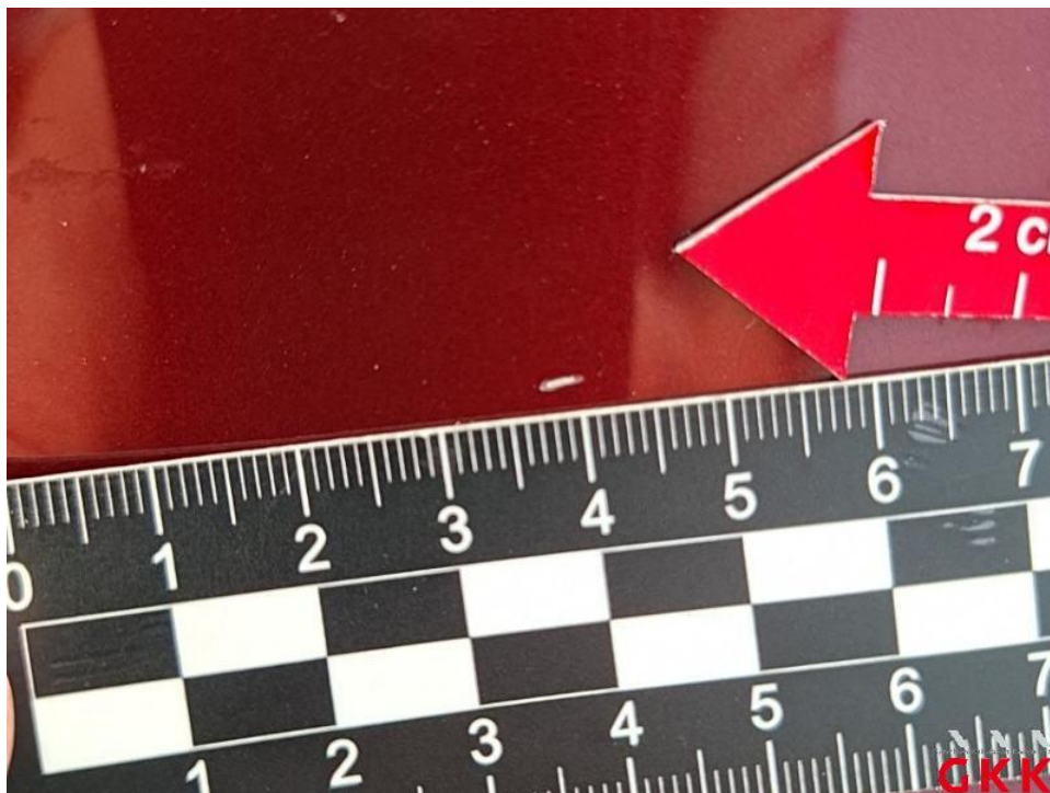
Bild 19. Motorhaube, Steinschlag, lackieren
