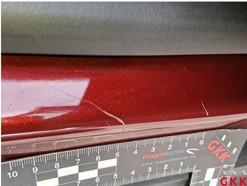
Bild 36. Tür hinten rechts, Einstieg, verkratzt, Smartrepair
