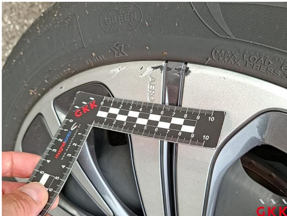
Bild 30. Radkappe(n), vorne rechts, verkratzt, ersetzen
