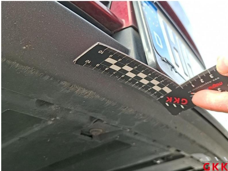
Bild 26. Stoßfänger vorne, Spoiler -unlackiert-, verkratzt, ersetzen
