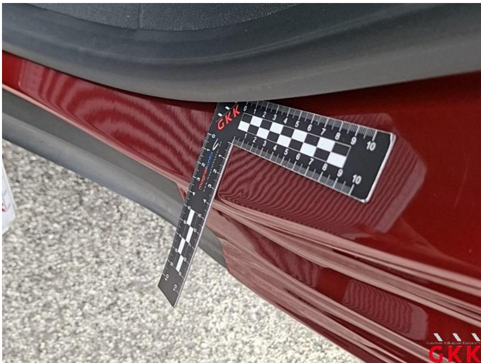
Bild 44. Tür hinten links, Einstieg, beschädigt, Smartrepair
