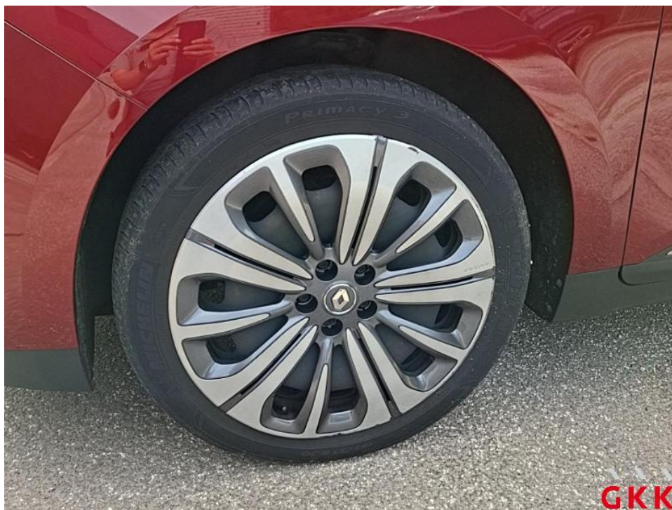
Bild 14. Radkappe(n), vorne links, verkratzt, ersetzen
