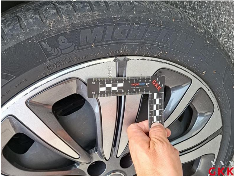
Bild 15. Radkappe(n), vorne links, verkratzt, ersetzen
