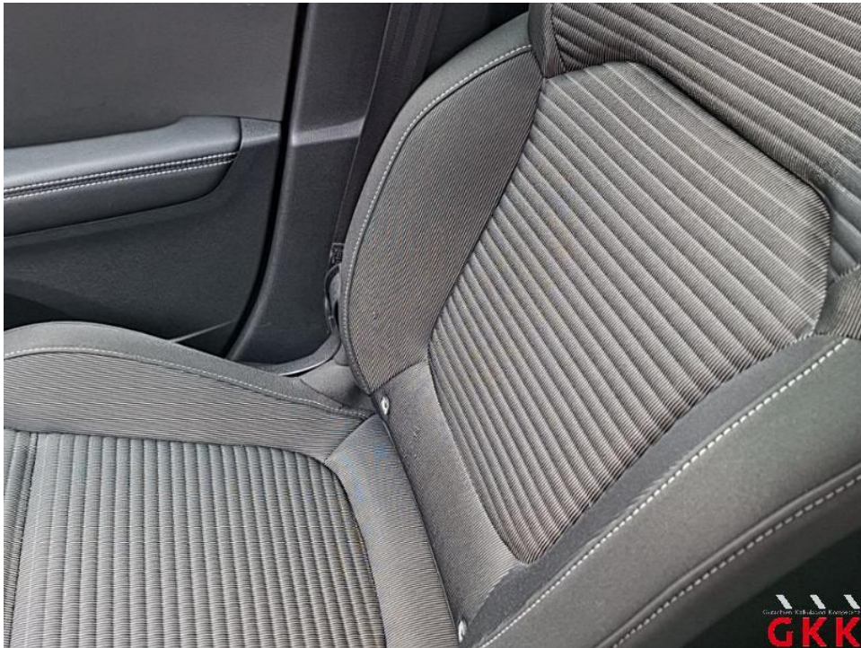
Bild 50. Sitz vorne rechts, Bezug Rückenlehne -Stoff-, beschädigt, Smartrepair
