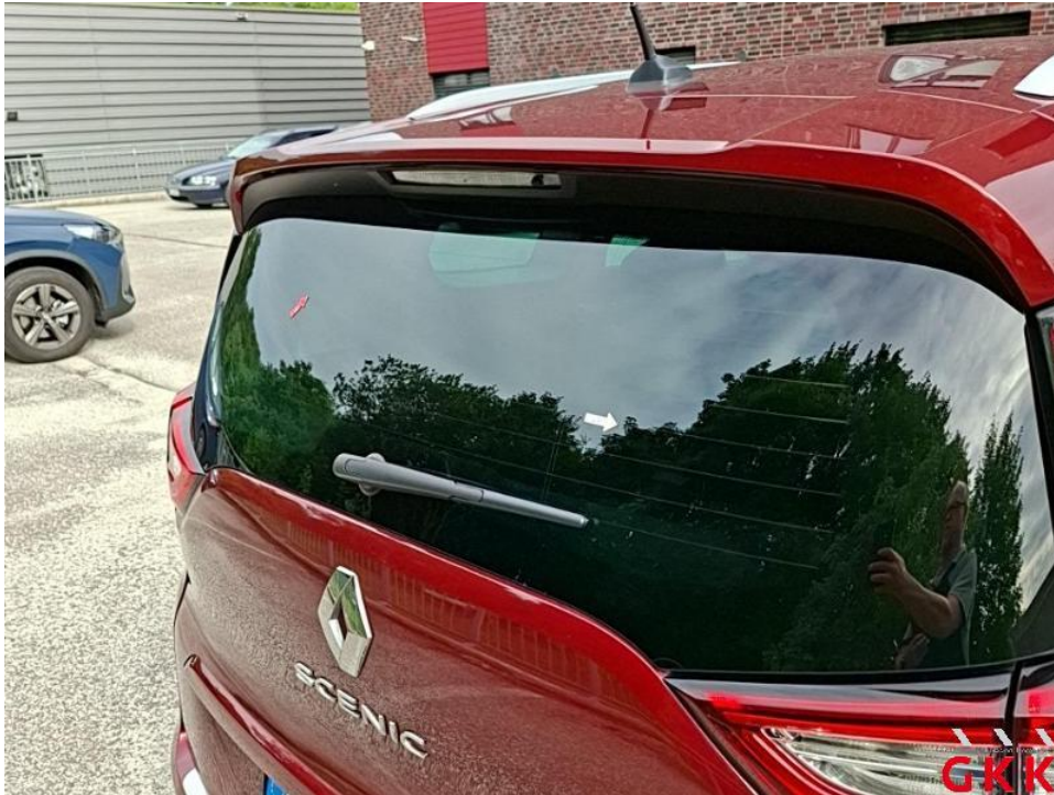
Bild 37. Heckscheibe, getönt, verkratzt, ersetzen
