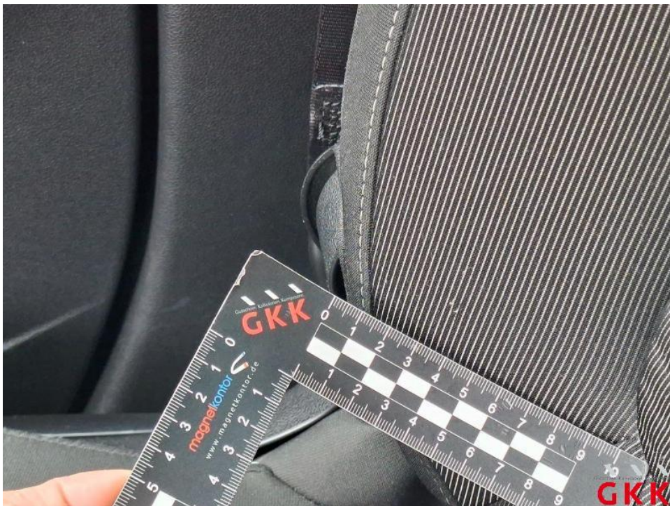
Bild 52. Sitz vorne rechts, Bezug Rückenlehne -Stoff-, beschädigt, Smartrepair
