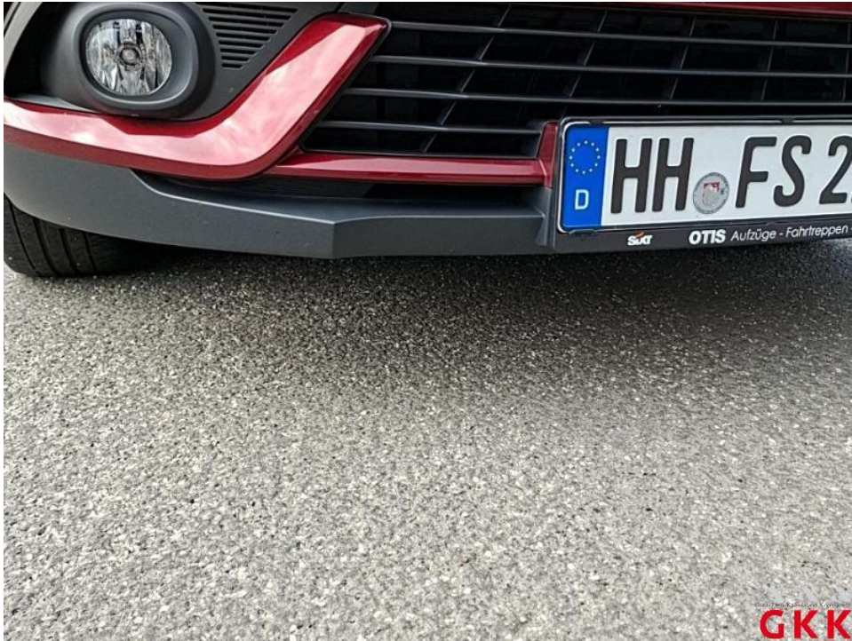
Bild 25. Stoßfänger vorne, Spoiler -unlackiert-, verkratzt, ersetzen
