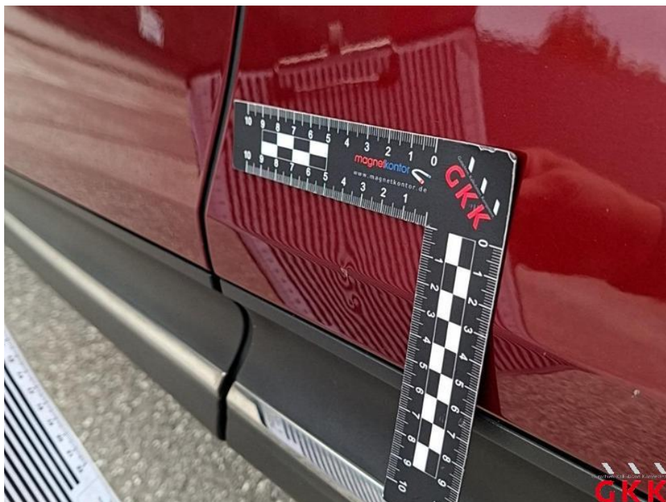
Bild 46. Tür hinten links, beschädigt, instand setzen - lackieren
