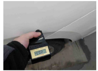
Lackstärke Seitenwand hinten links
