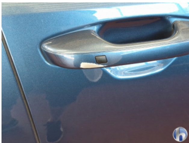
1. Außentürgriff Vorne - Rechts Abschürfung - Smart Repair
