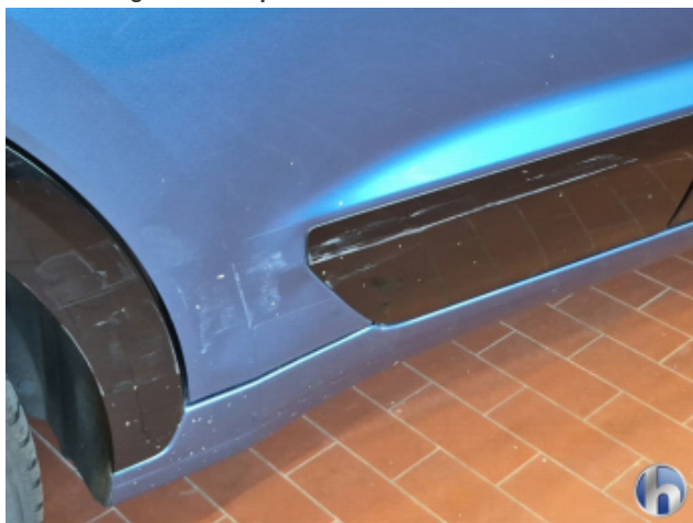
3. Seitenschaden Beschädigt - Instandsetzen und Lackieren
