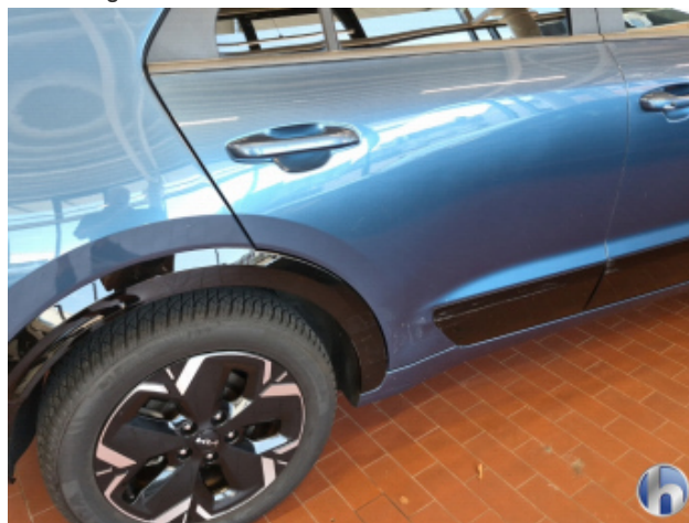
3. Seitenschaden Beschädigt - Instandsetzen und Lackieren
