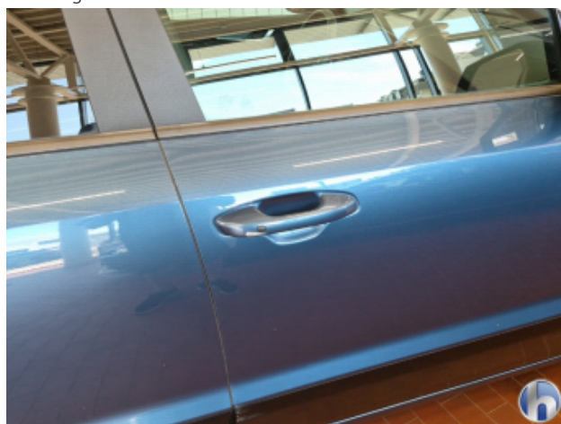
1. Außentürgriff Vorne - Rechts Abschürfung - Smart Repair
