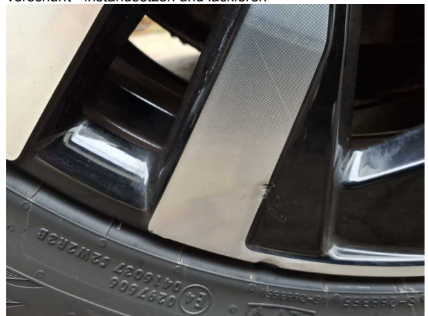
Beschädigung #5: Rad/Reifen: Leichtmetallfelge hinten rechts - verformt - erneuern
