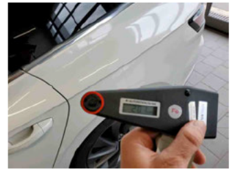
Lackstärke Seitenwand hinten links
