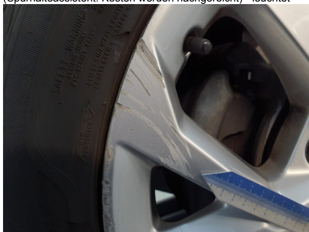
Beschädigung 2: Rad/Reifen: Leichtmetallfelge vorn links - verkratzt / verschürft - Smart Repair
