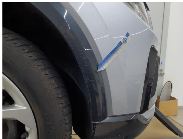
Beschädigung 5: Kotflügel rechts: Radlauf - verkratzt / verschürft - lackieren
