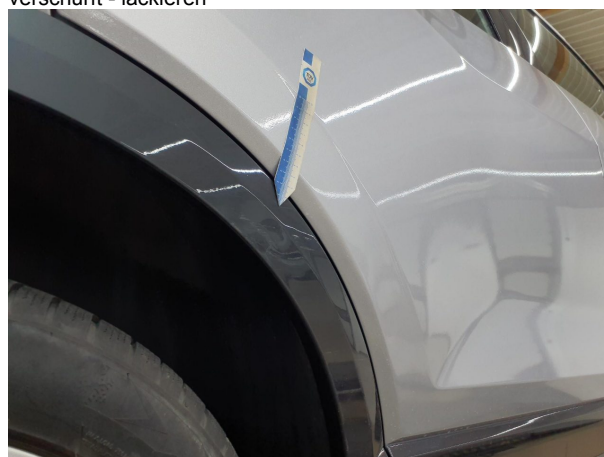
Beschädigung 6: Seitenwand rechts: Radlauf - verformt - instandsetzen und lackieren
