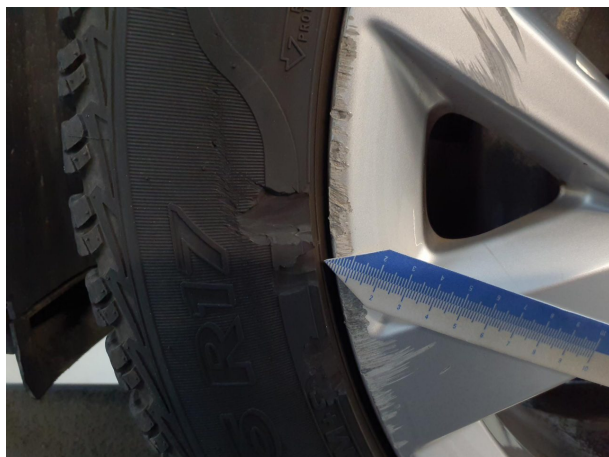
Beschädigung 4: Rad/Reifen: Reifen vorn links - gebrochen / gerissen - erneuern
