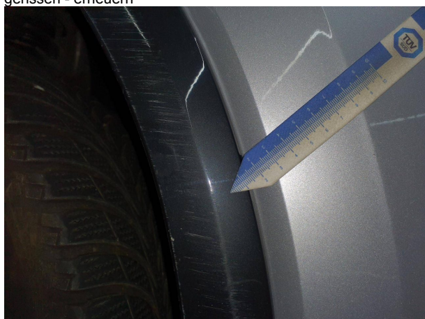
Beschädigung 5: Kotflügel rechts: Radlauf - verkratzt / verschürft... lackieren
