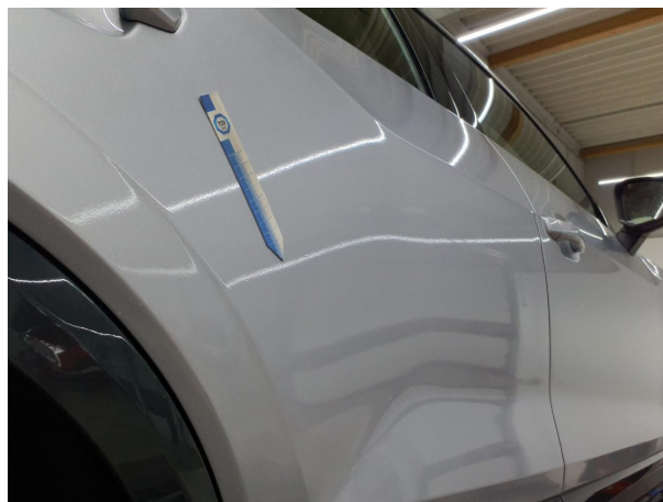
Beschädigung 9: Tür hinten rechts: Tür (Lackaufbau mangelhaft) - nicht fachgerecht instandgesetzt - lackieren
