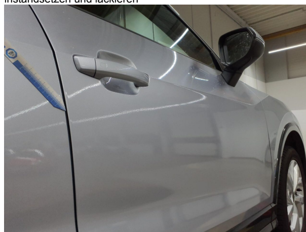
Beschädigung 8: Tür vorn rechts: Tür (Lackaufbau mangelhaft) - nicht fachgerecht instandgesetzt - lackieren
