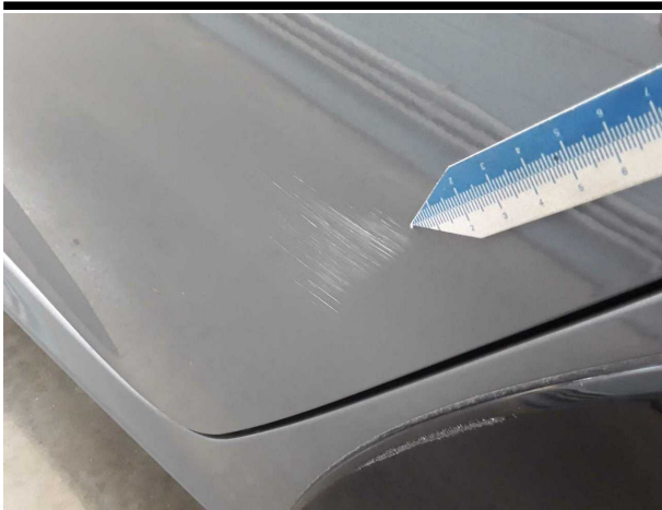
Beschädigung #7: Tür hinten links: Tür - Kratzer - lackieren
