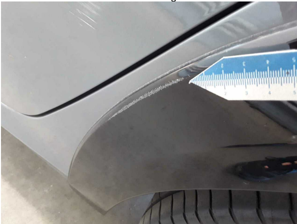
Beschädigung #5: Seitenwand links: Radhausverbreiterung - verkratzt / verschürft - lackieren
