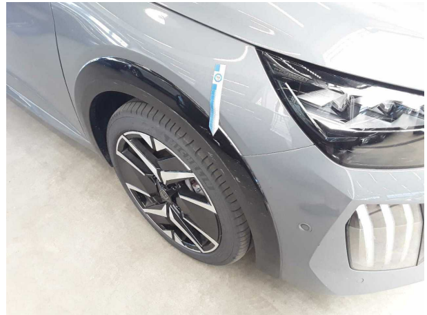
Beschädigung #6: Kotflügel rechts: Radhausverbreiterung - verkratzt / verschürft - lackieren
