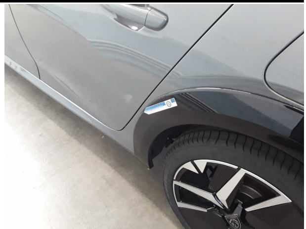
Beschädigung #5: Seitenwand links: Radhausverbreiterung - verkratzt / verschürft - lackieren
