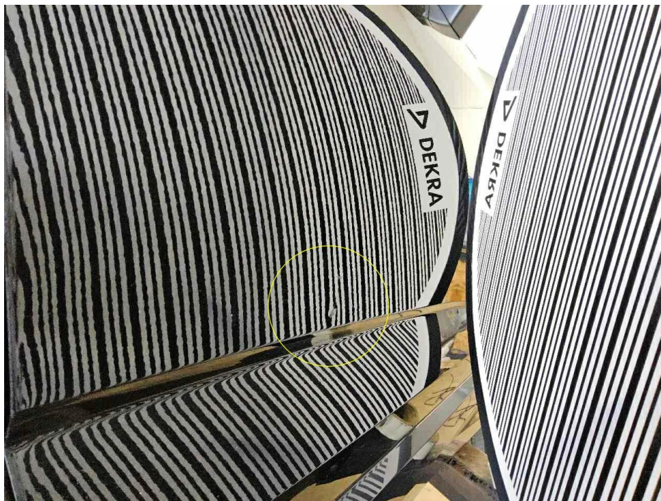
Bild 16 : Türe vorne rechts Delle
