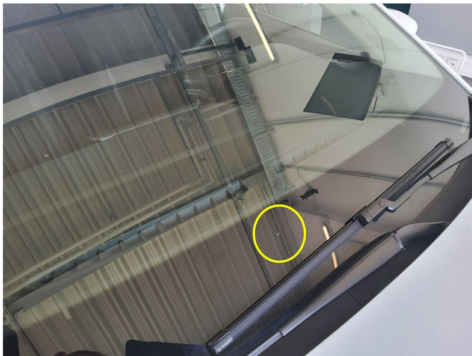
Bild 17 : Frontscheibe mit Steinschlag und Rissbildung.
