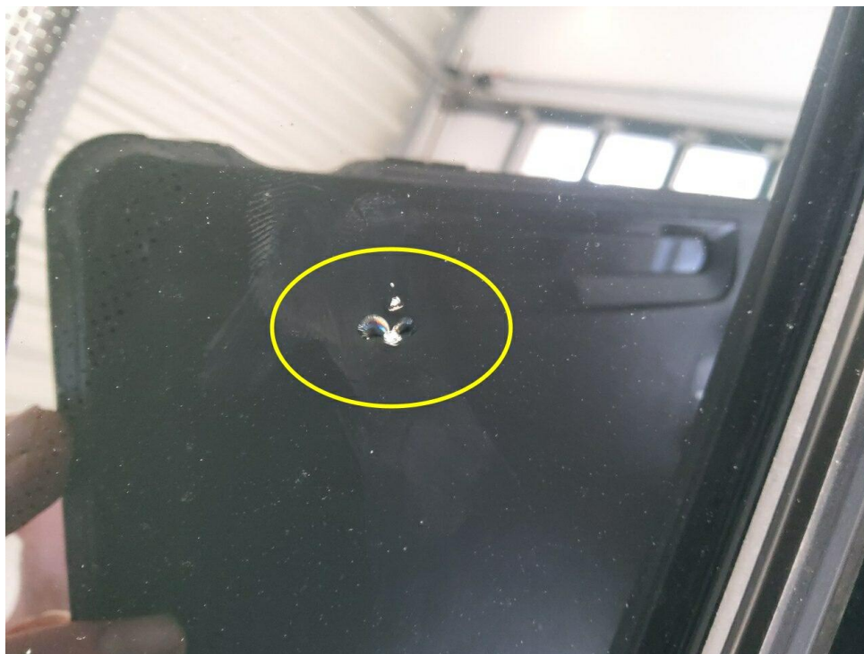
Bild 18 : Frontscheibe mit Steinschlag und Rissbildung.
