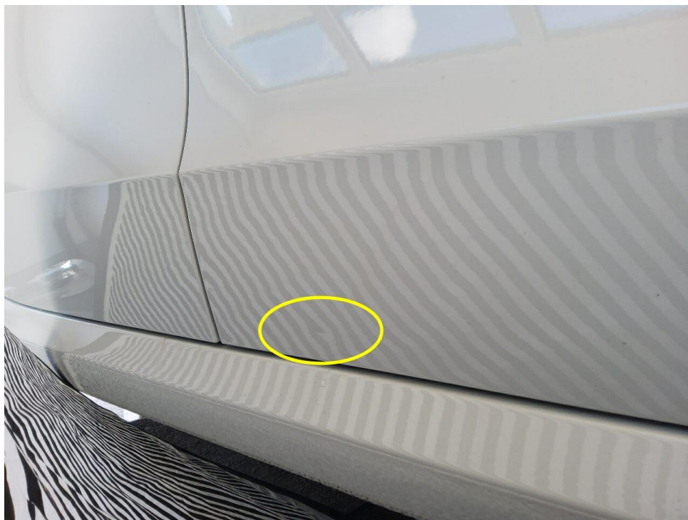
Bild 15 : Beifahrertür punktuell eingedellt.
