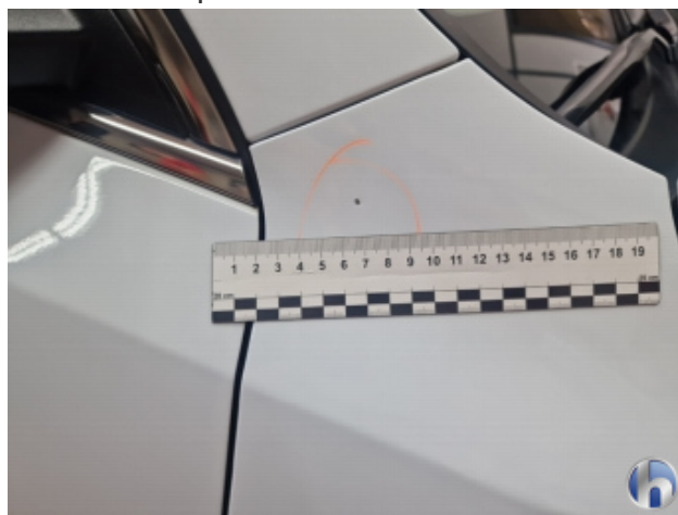
8. Kotflügel Vorne - Rechts Delle - Smart Repair
