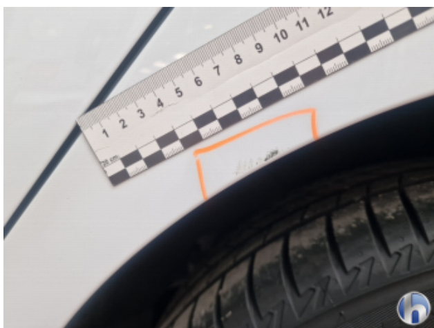
5. Seitenwand - Hinten - Links Kratzer - Smart Repair
