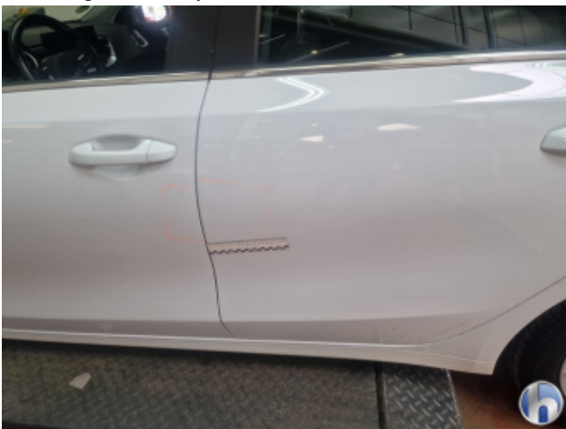
2. Tür Hinten - Links Oberflächenkratzer - Aufbereiten / Polieren
