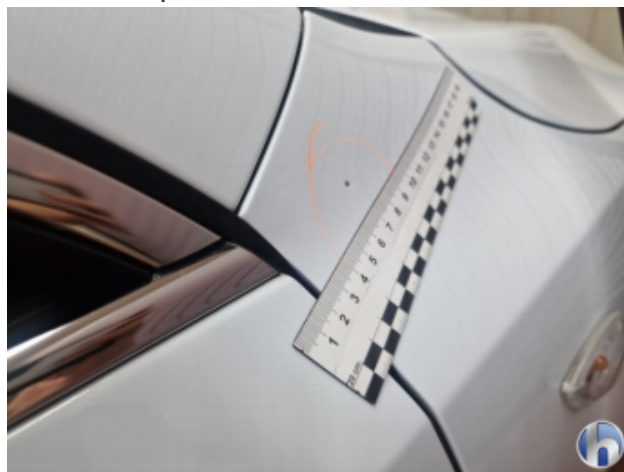
8. Kotflügel Vorne - Rechts Delle - Smart Repair
