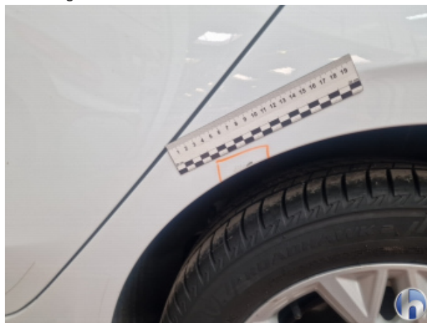
5. Seitenwand - Hinten - Links Kratzer - Smart Repair
