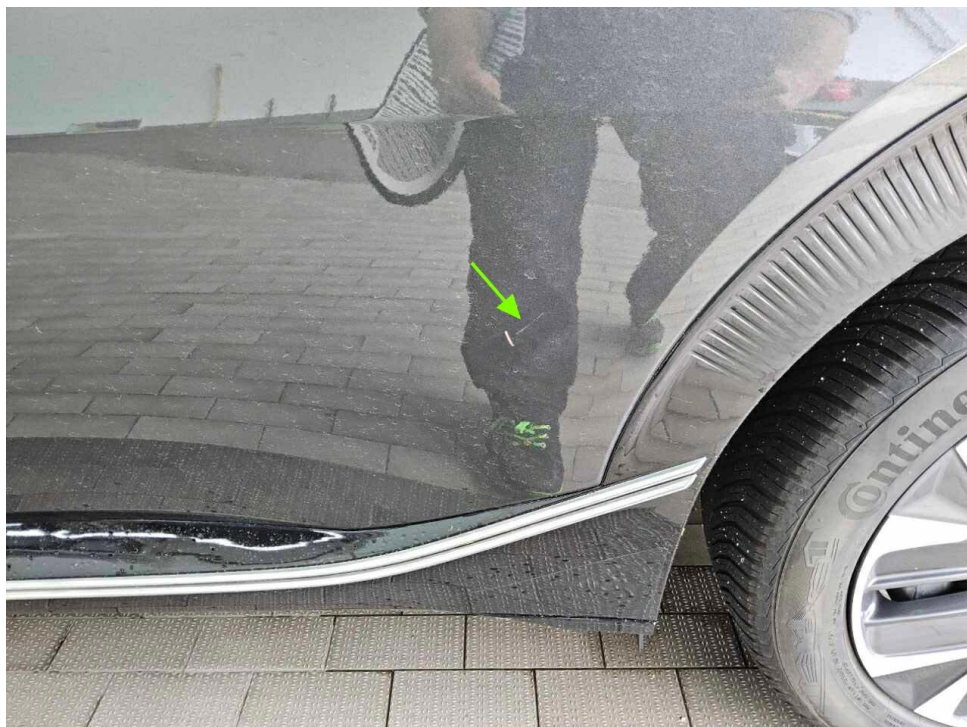
Bild 36 : Tür hinten links Lackierung, zerkratzt, polieren
