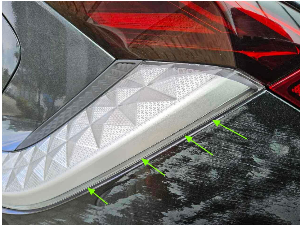
Bild 21 : Rückleuchte hinten rechts verschrammt
