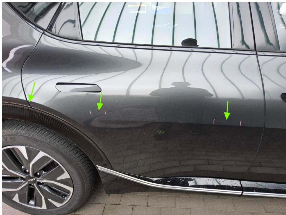
Bild 26 : Tür hinten rechts, eingedellt, instandsetzen und lackieren mit Lackaufbau
