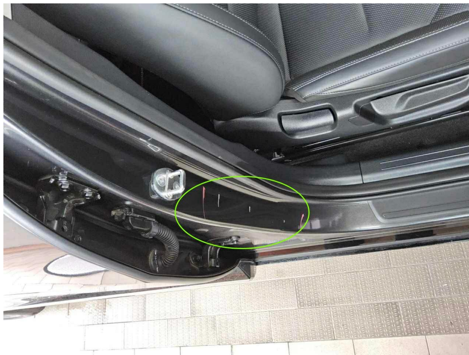
Bild 30 : Tür vorne rechts Einstieg, mehrfach eingedellt, instandsetzen und lackieren mit Lackaufbau
