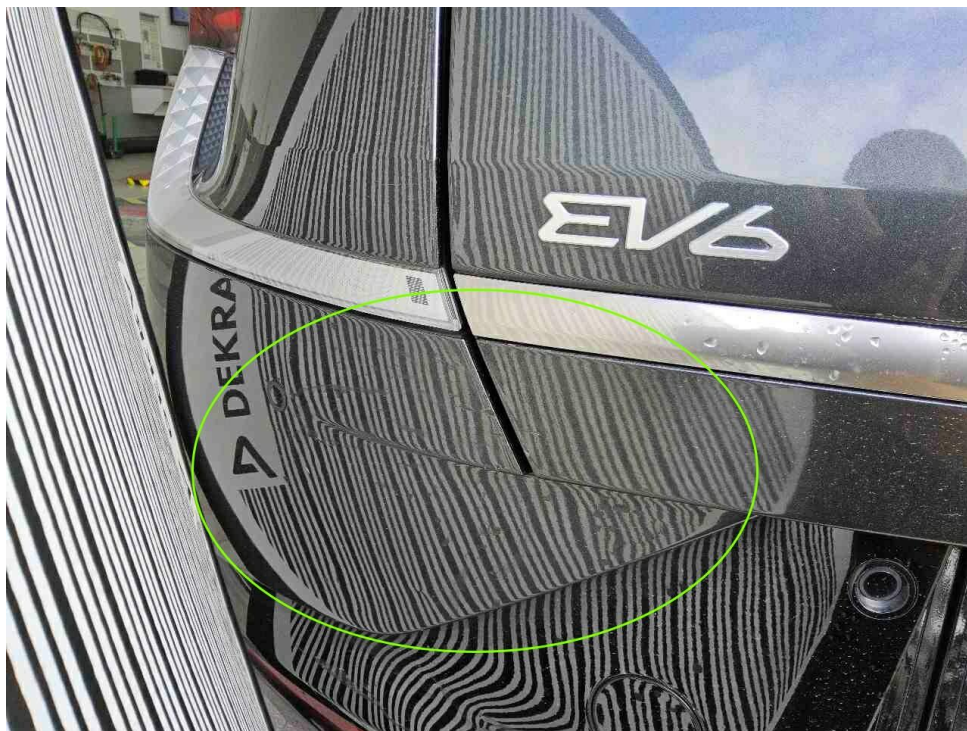
Bild 16 : Stoßfängerecke hinten links und Zierblende Kofferraum unten bleibend verformt
