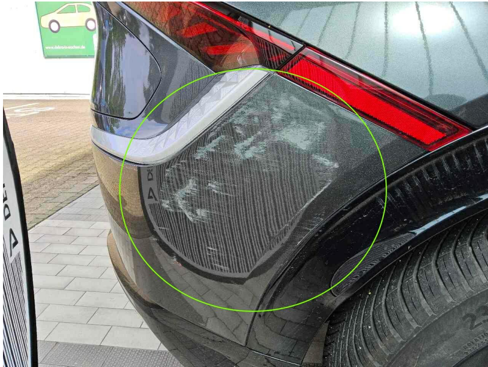
Bild 19 : Stoßfängerecke hinten rechts bleibend verformt und verschrammt
