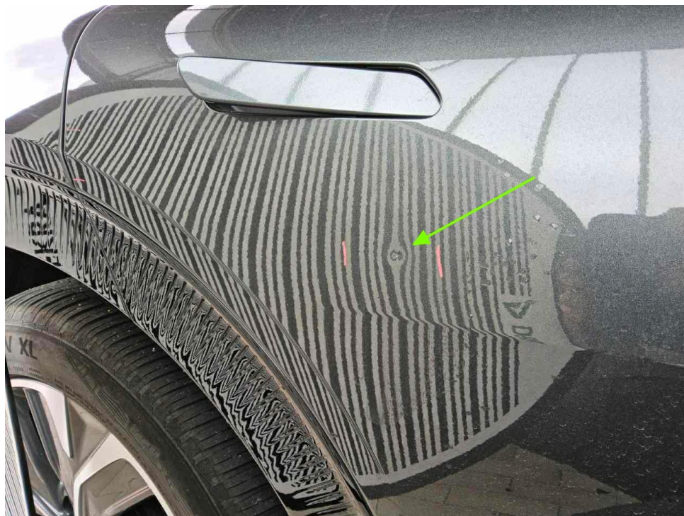
Bild 27 : Tür hinten rechts, eingedellt, instandsetzen und lackieren mit Lackaufbau
