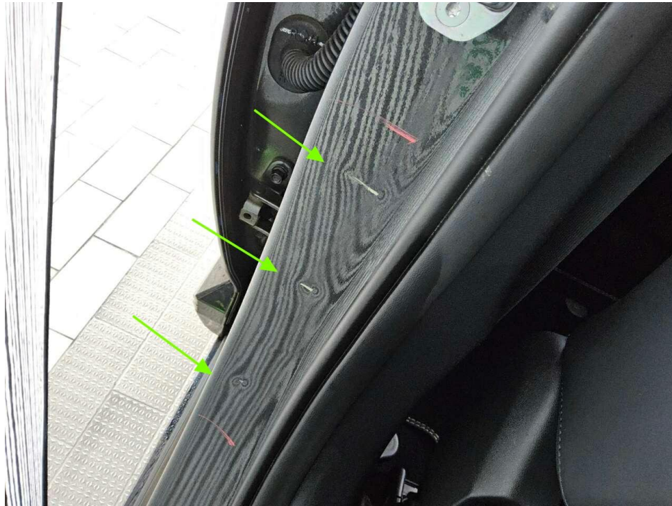
Bild 31 : Tür vorne rechts Einstieg, mehrfach eingedellt, instandsetzen und lackieren mit Lackaufbau
