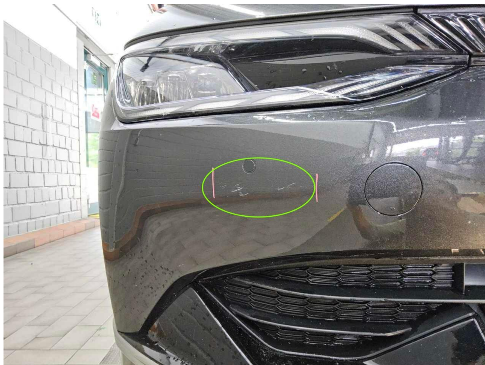
Bild 32 : Stoßfänger vorne Lackierung, verschrammt, smart repair
