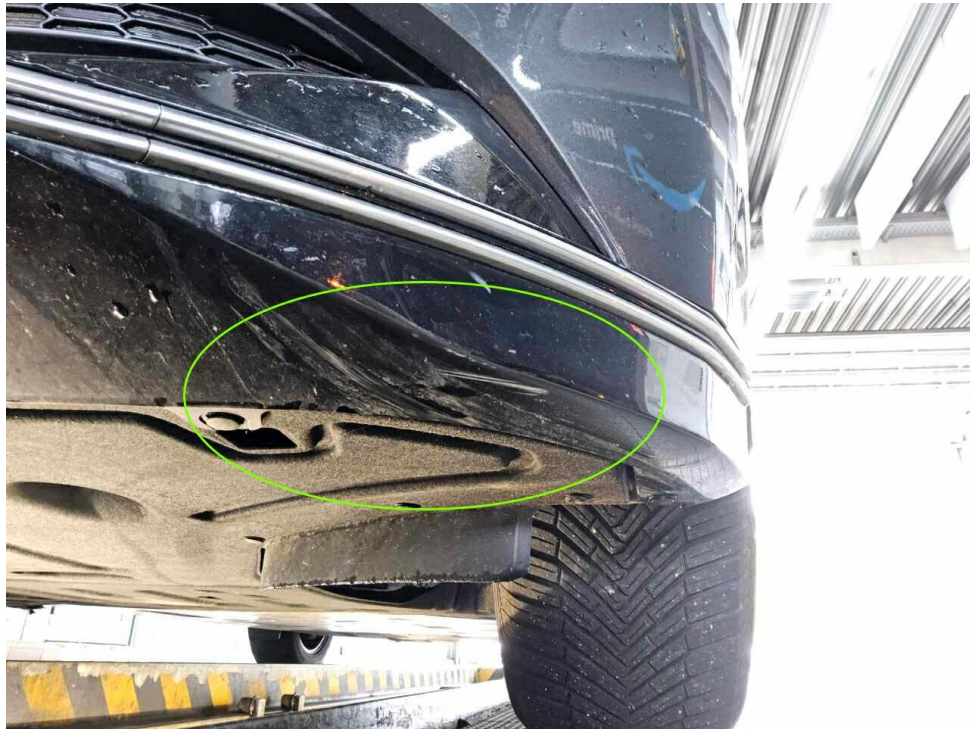
Bild 33 : Frontspoiler, verschrammt, lackieren mit Lackaufbau
