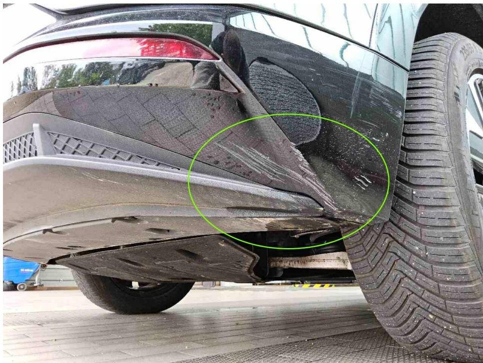
Bild 24 : Stoßfänger Unterteil / Heckdiffusor verschrammt
