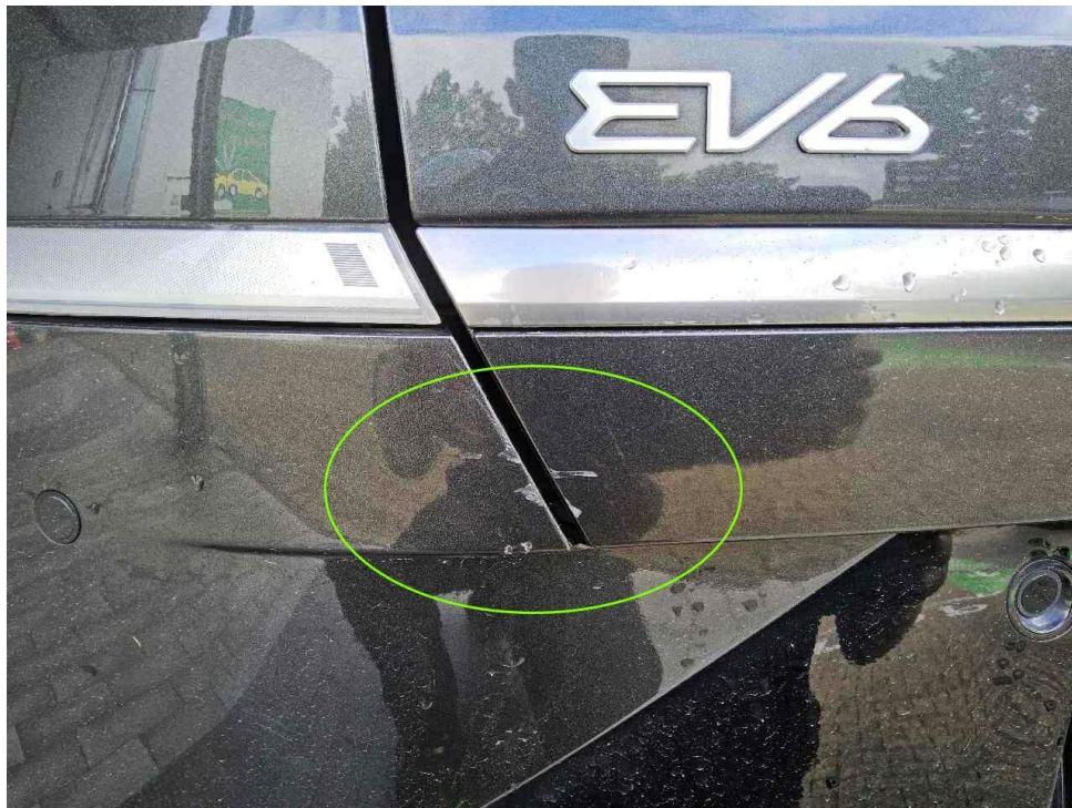
Bild 15 : Stoßfängerecke hinten links und Zierblende Kofferraum unten verschrammt
