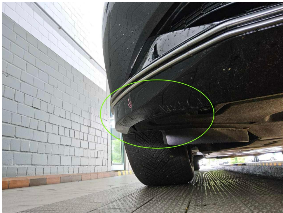
Bild 34 : Frontspoiler, verschrammt, lackieren mit Lackaufbau
