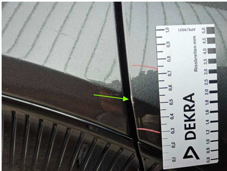
Bild 29 : Tür hinten rechts, verschrammt, instandsetzen und lackieren mit Lackaufbau
