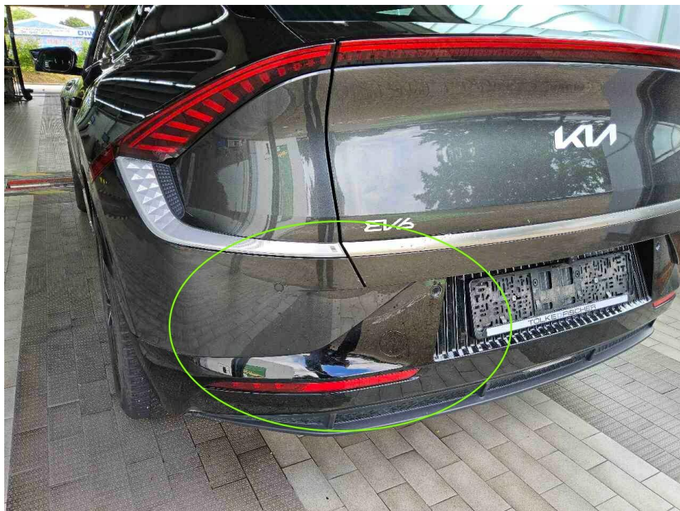
Bild 14 : Übersichtsaufnahme: unreparierter Unfallschaden hinten links
