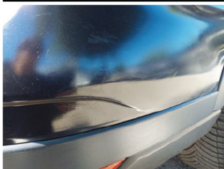
Pare-chocs / Arrière / Malfaçon
