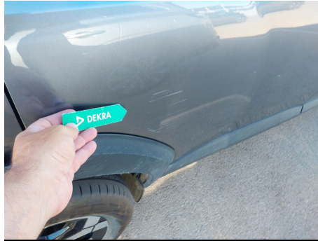
Puerta / Trasero Derecho / Abolladura
