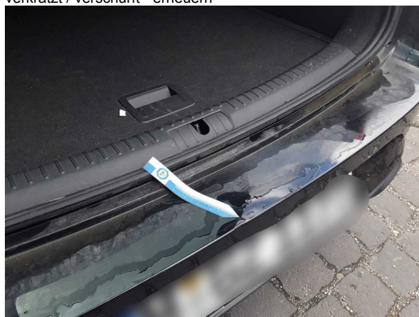
Beschädigung #4: Stossfänger hinten: Stossfänger hinten - verformt - erneuern
